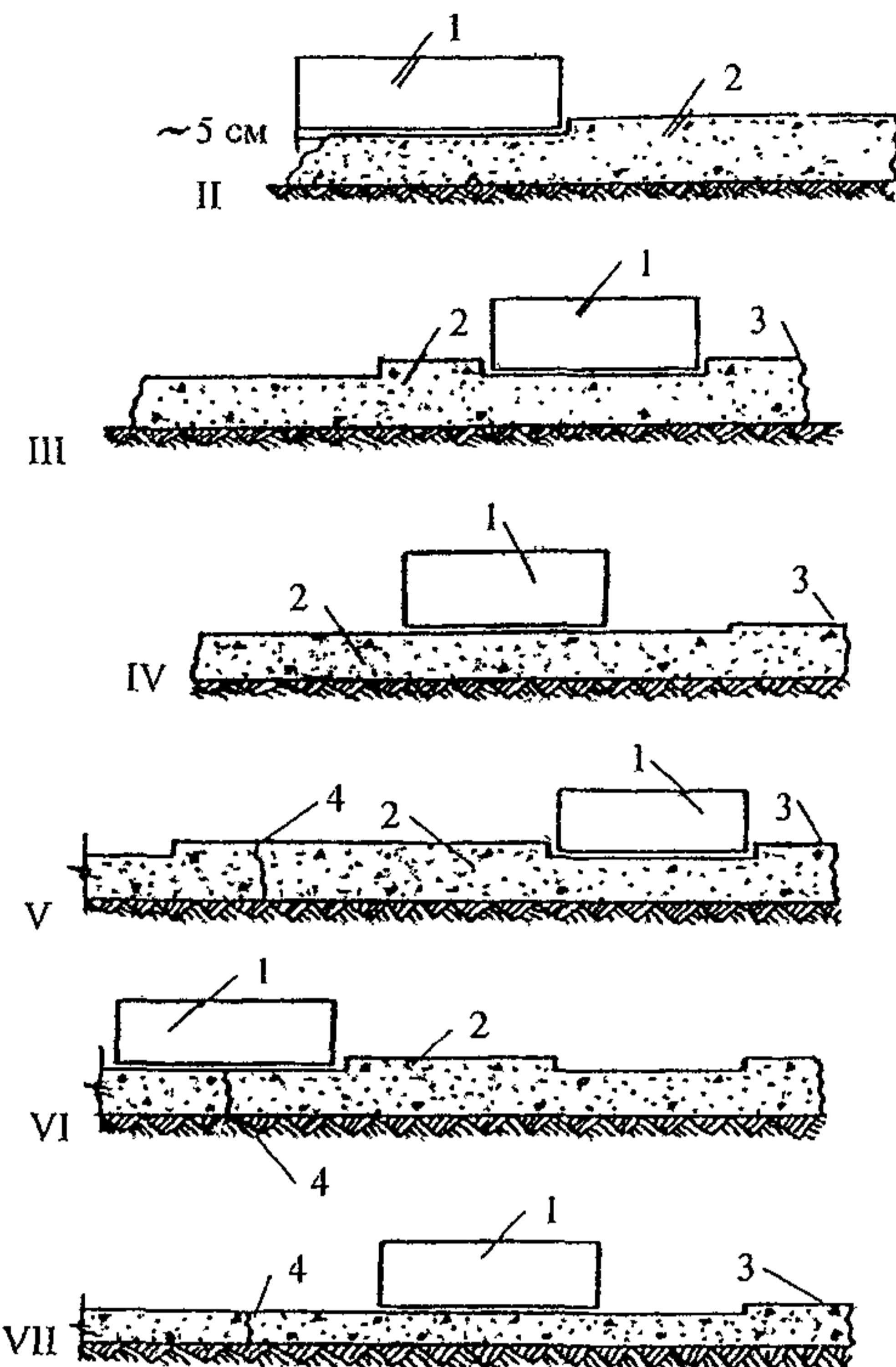
*Рис. 2. Схема уплотнения свежеуложенных первой и примыкающих полос покрытия из укатанного бетона (поперечный разрез):
