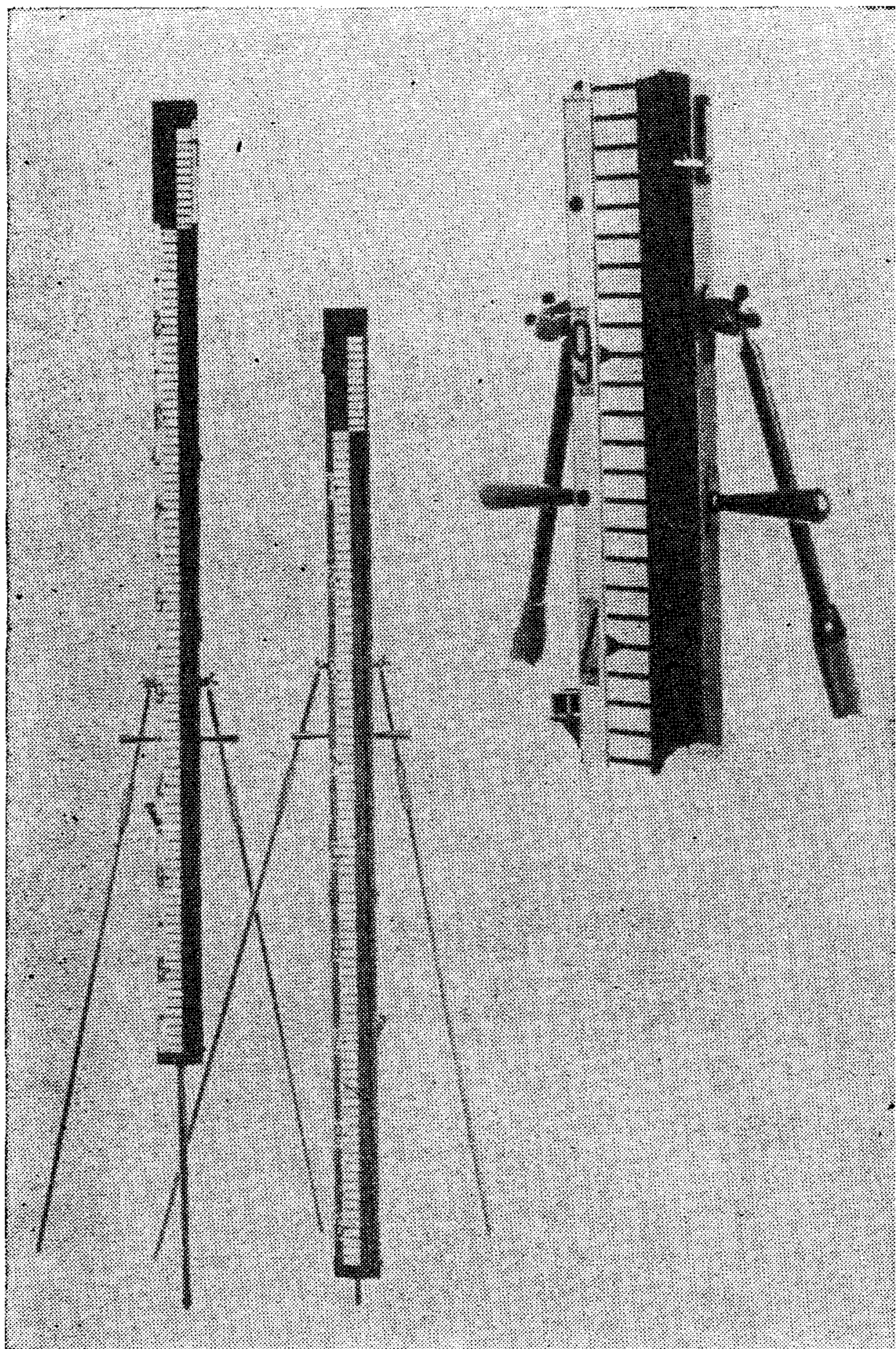
**Рис. 12. Дальномерная рейка к насадке ДНР-06**
