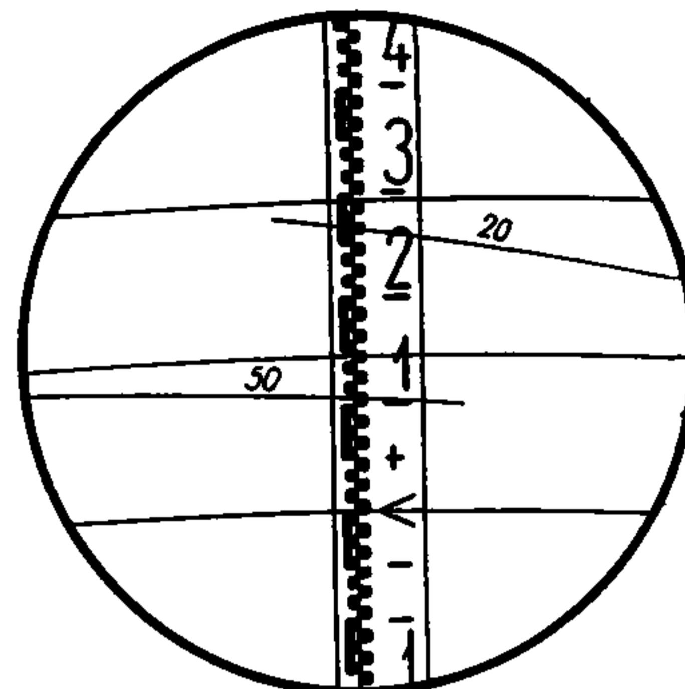
Рис. 24. Поле зрения трубы редукционного тахеометра Та-Д4
