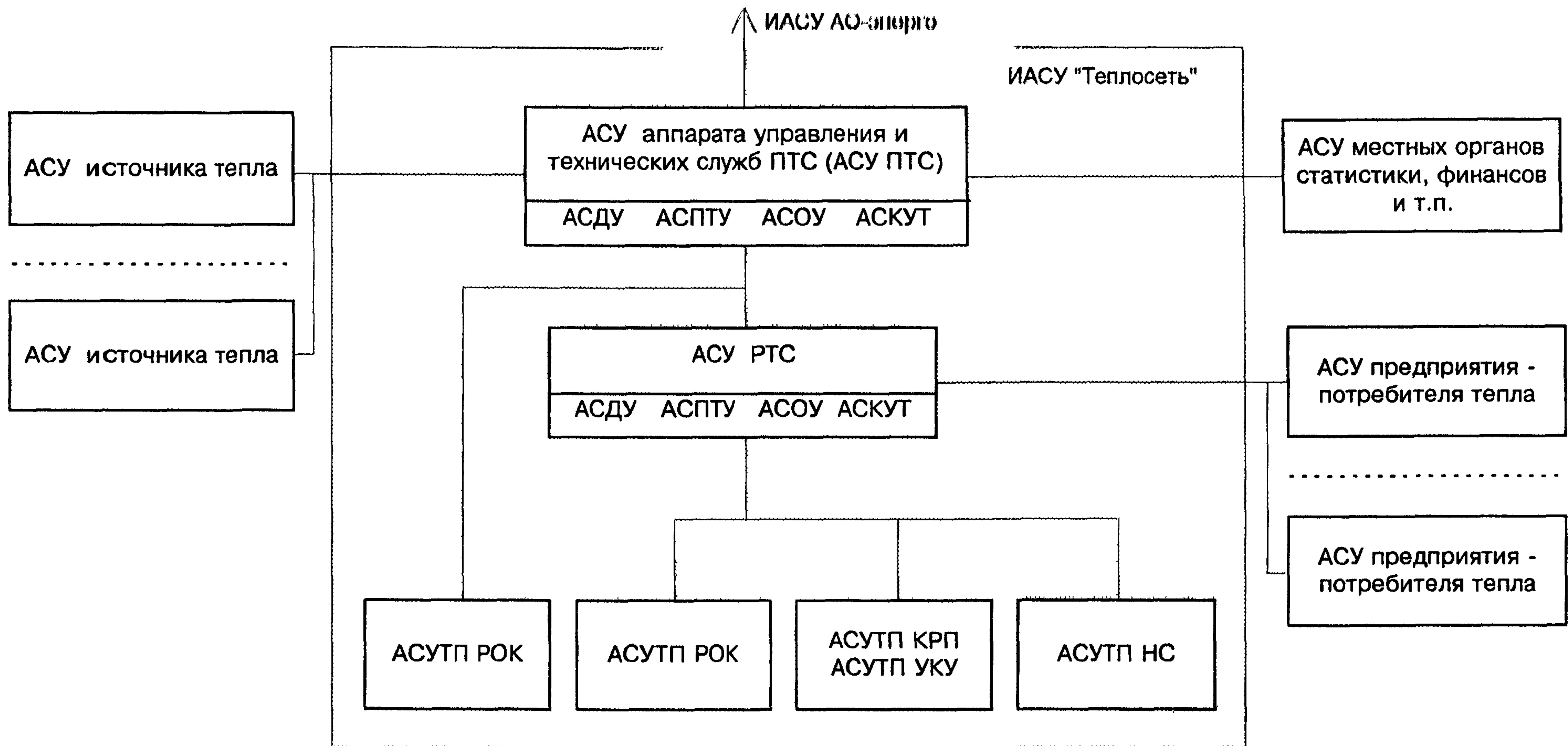
Рис. 2.1 Типовая организационная структура ИАСУ "Теплосеть"
