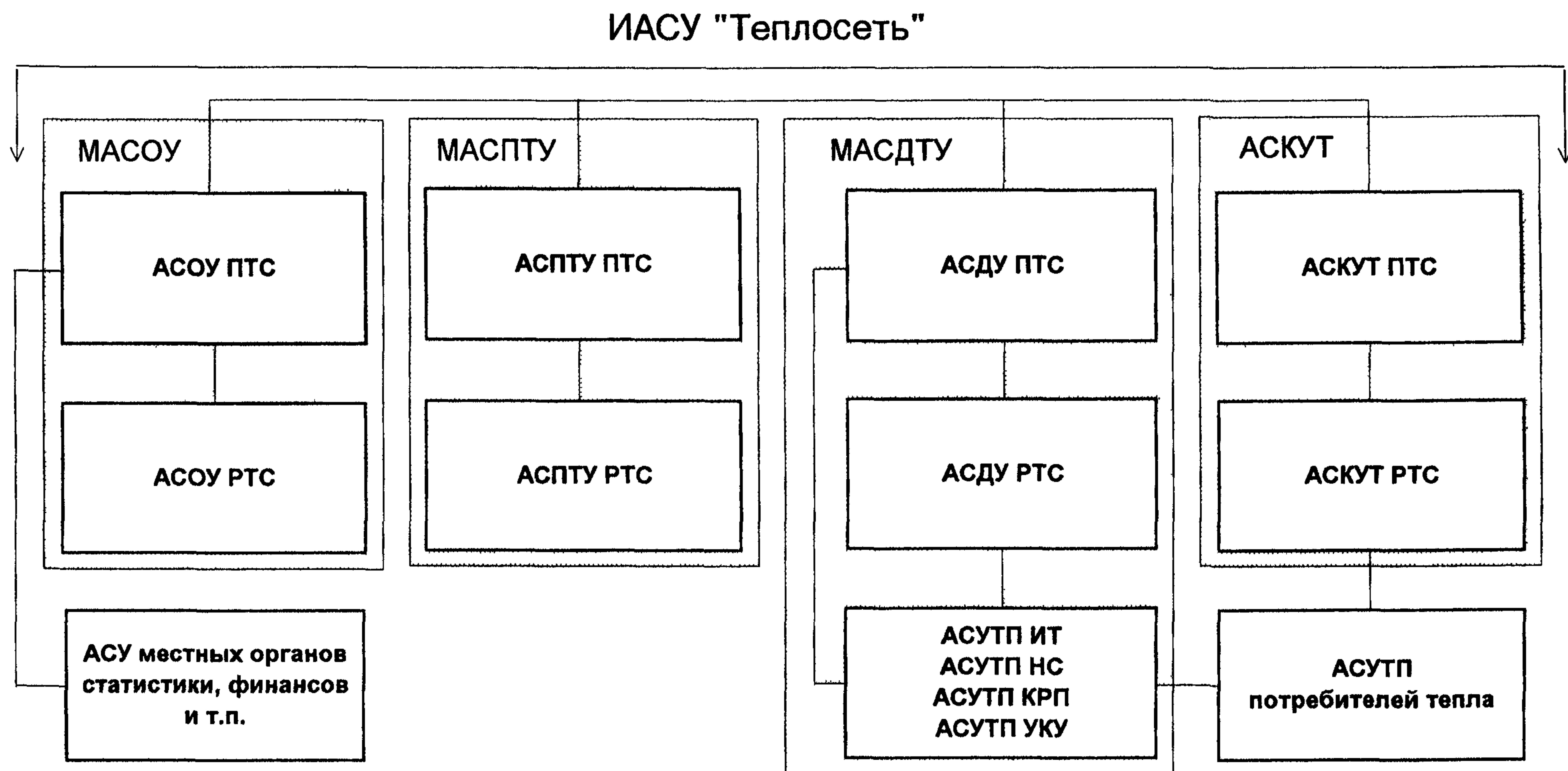
Рис. 2.2 Типовая функциональная структура ИАСУ "Теплосеть"
