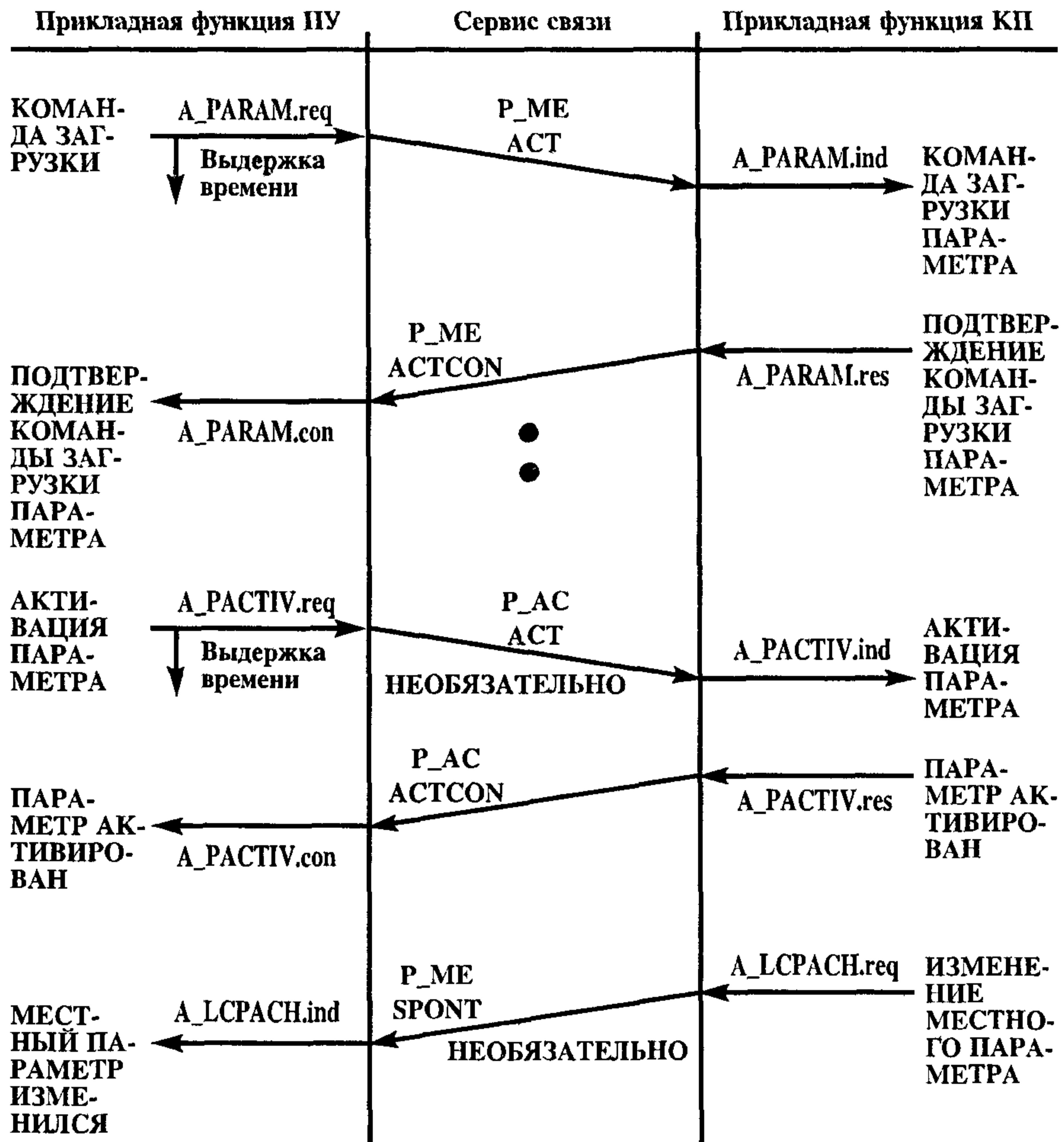
Рисунок 18 — Последовательная процедура — загрузка параметра
