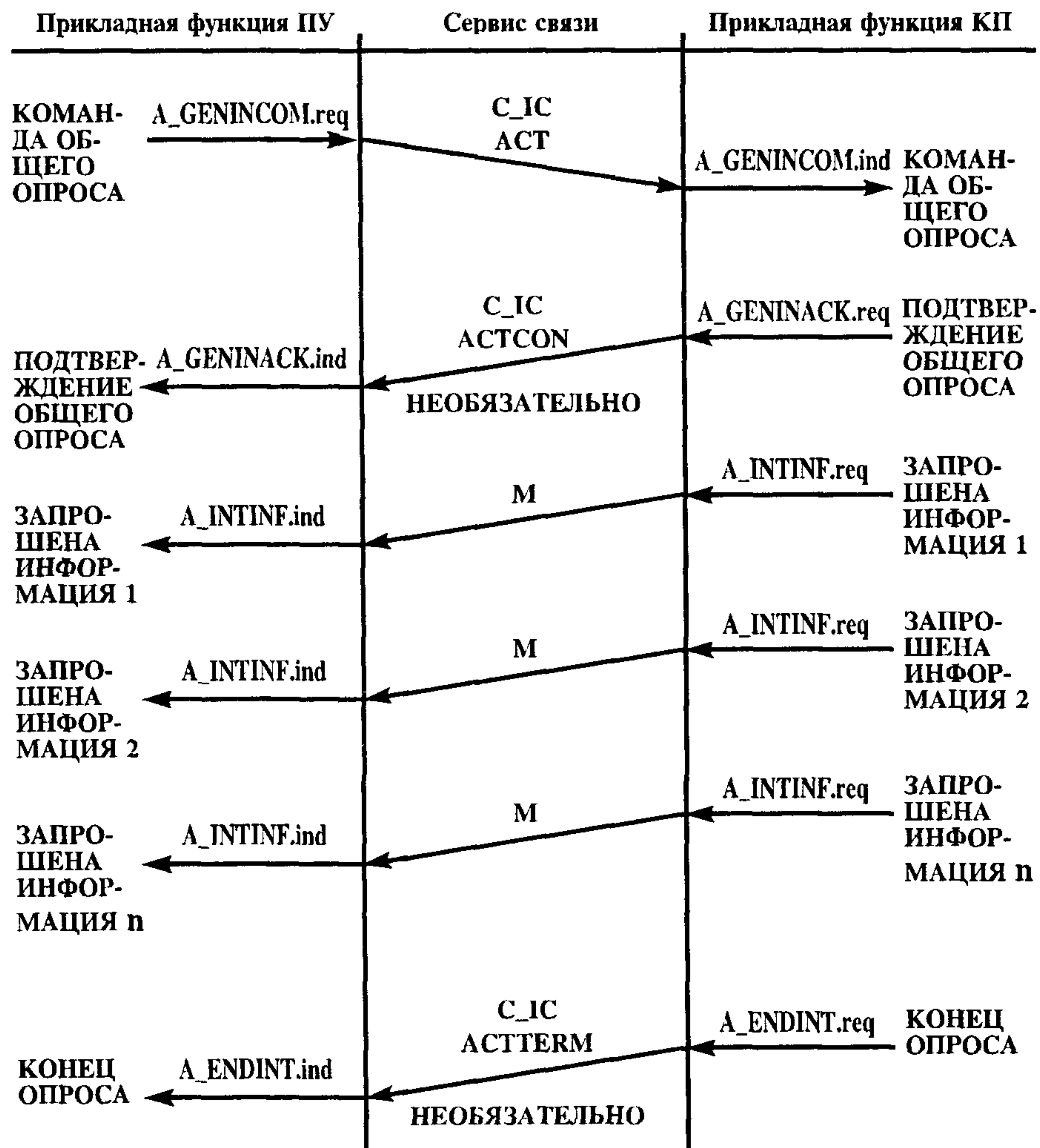
Рисунок 14 — Последовательная процедура — процедура опроса подстанций
