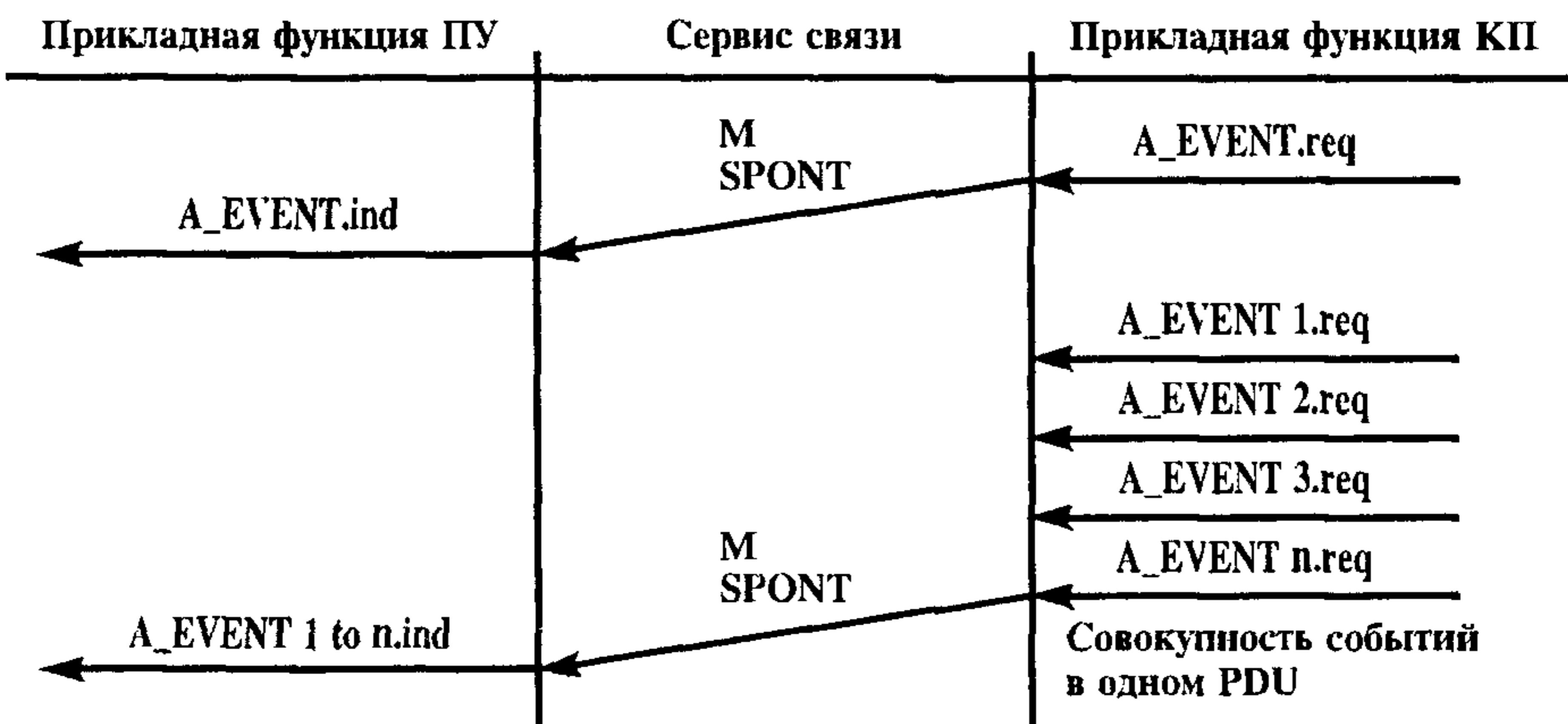
Рисунок 12 — Последовательная процедура — сбор данных о событиях
