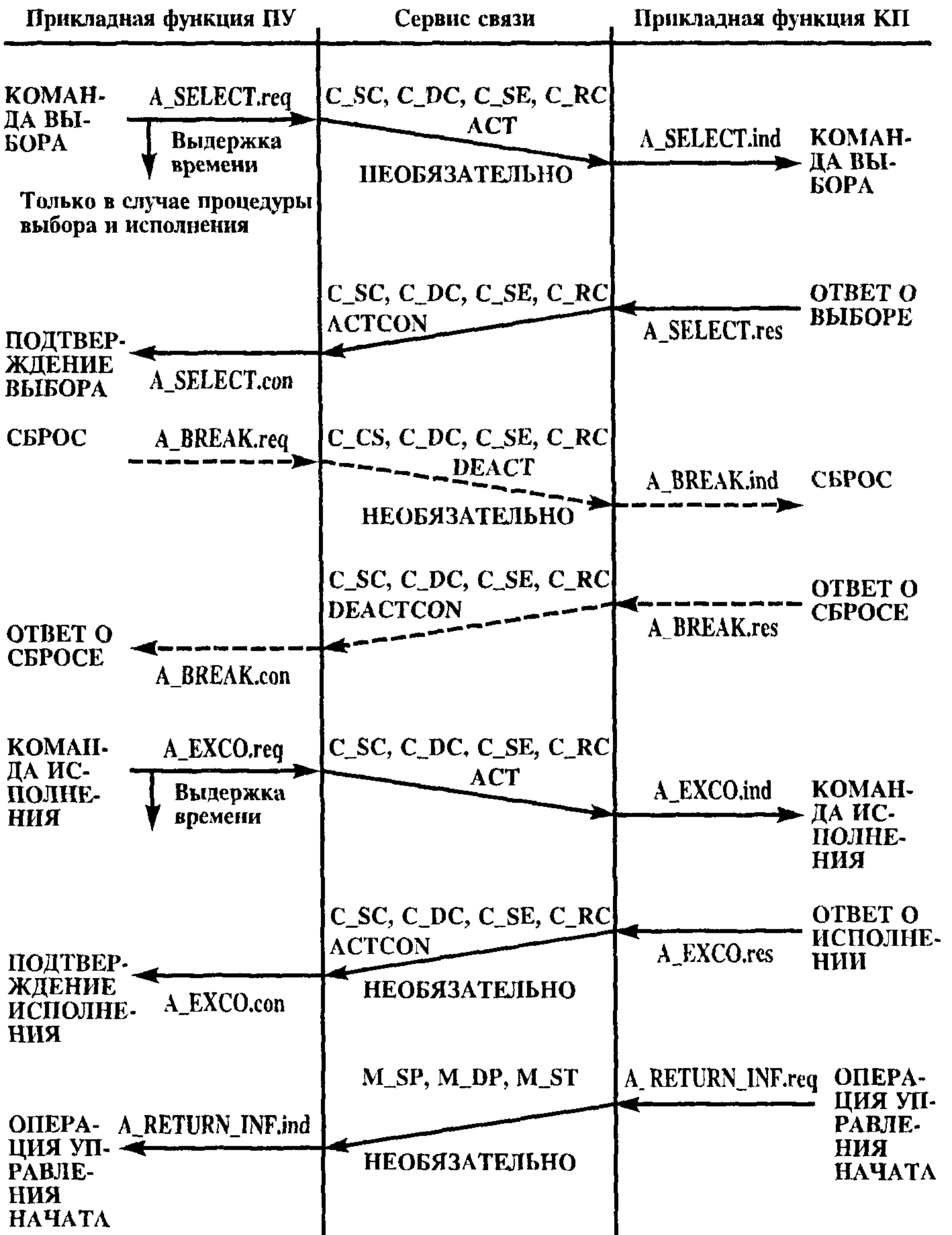
Рисунок 16 — Последовательная процедура — процедура передачи команд, лист 1
