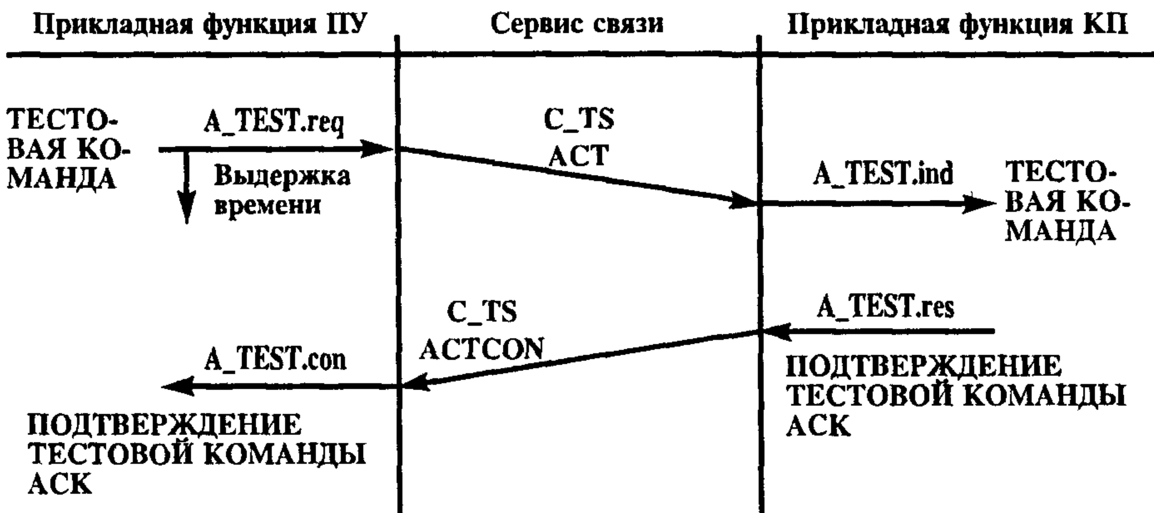
Рисунок 19 — Последовательная процедура — тестовая процедура
