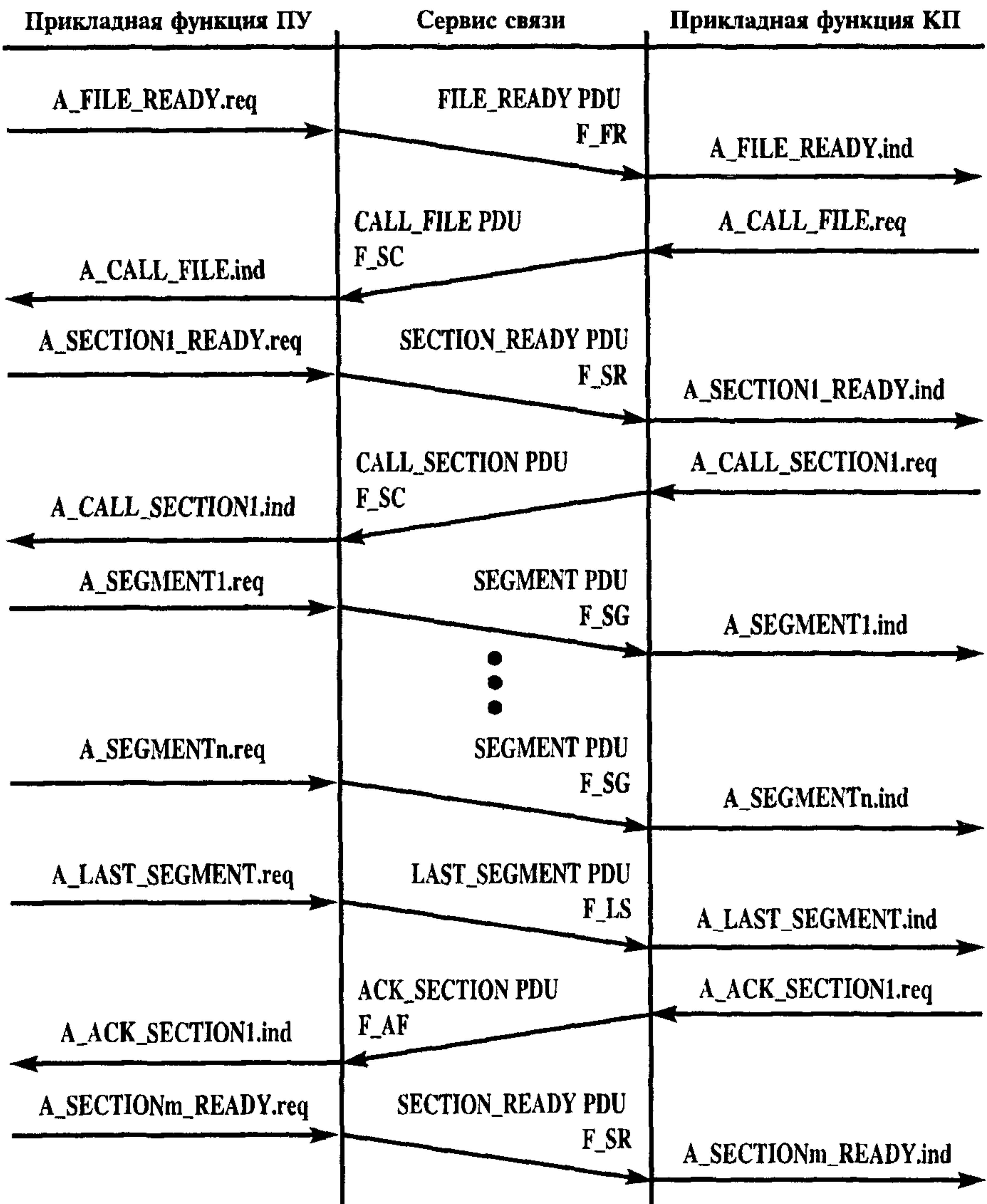
Рисунок 22 – Последовательная процедура — передача файла (в направлении КП),
