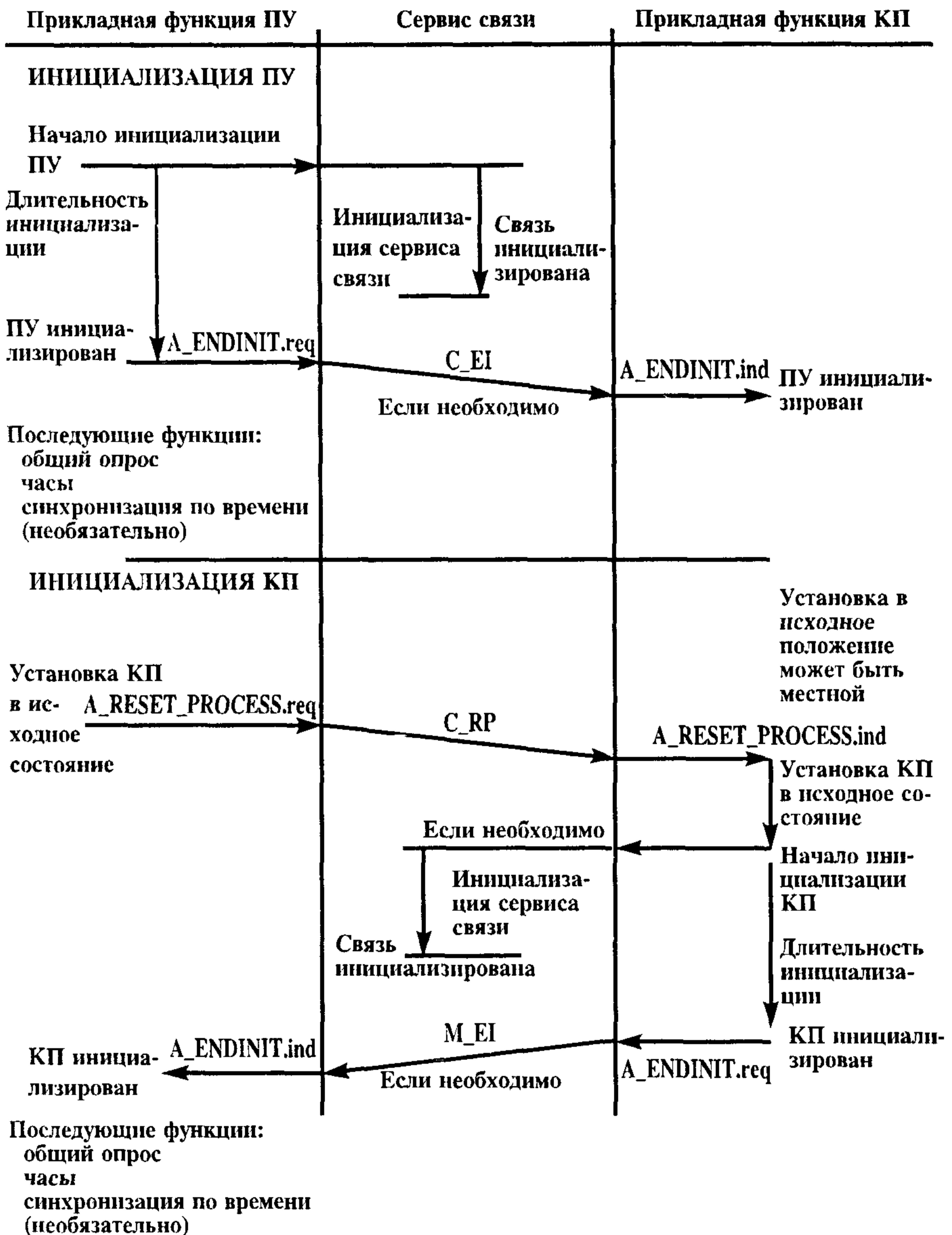
Рисунок 3 — Последовательная процедура — основная процедура инициализации
