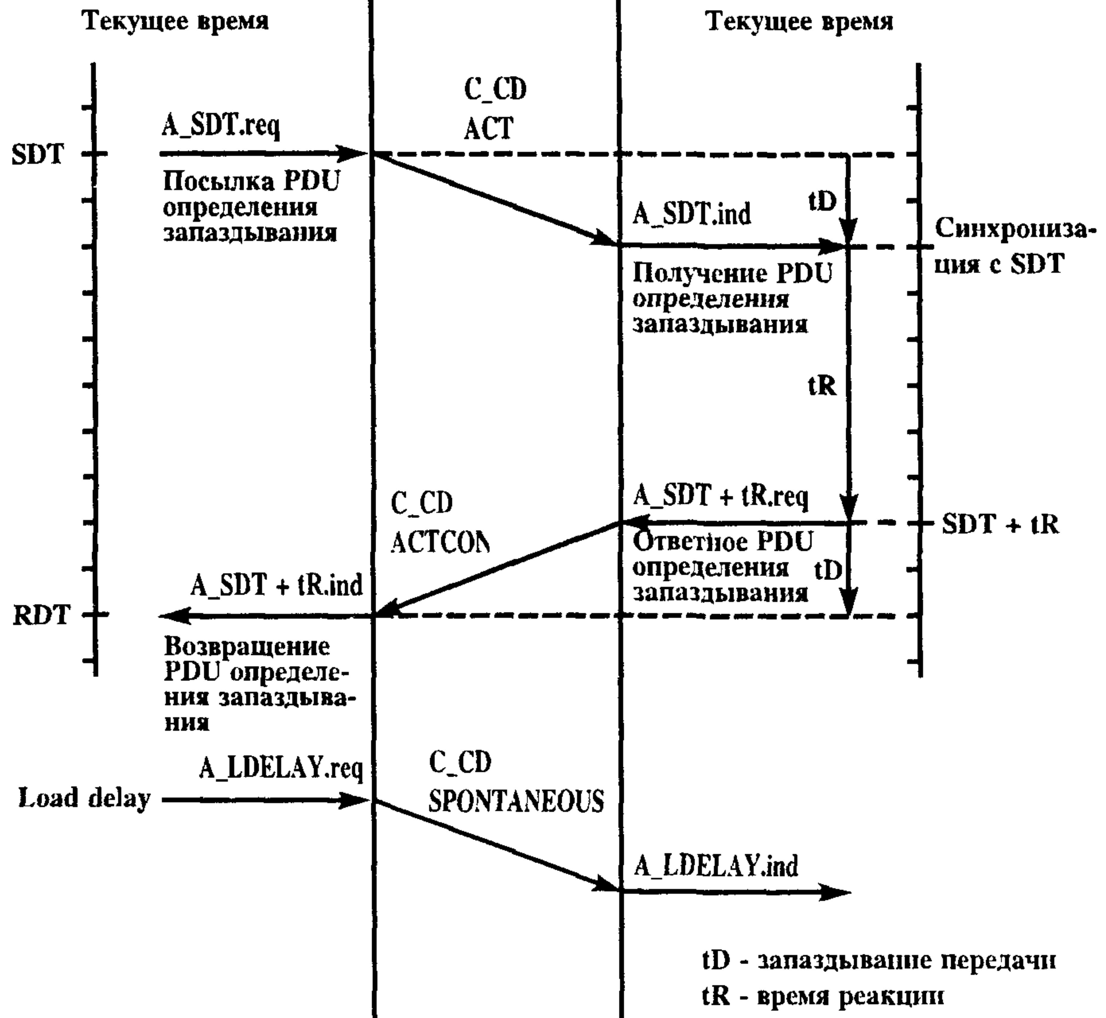
Рисунок 23 — Последовательная процедура — определение запаздывания передачи
