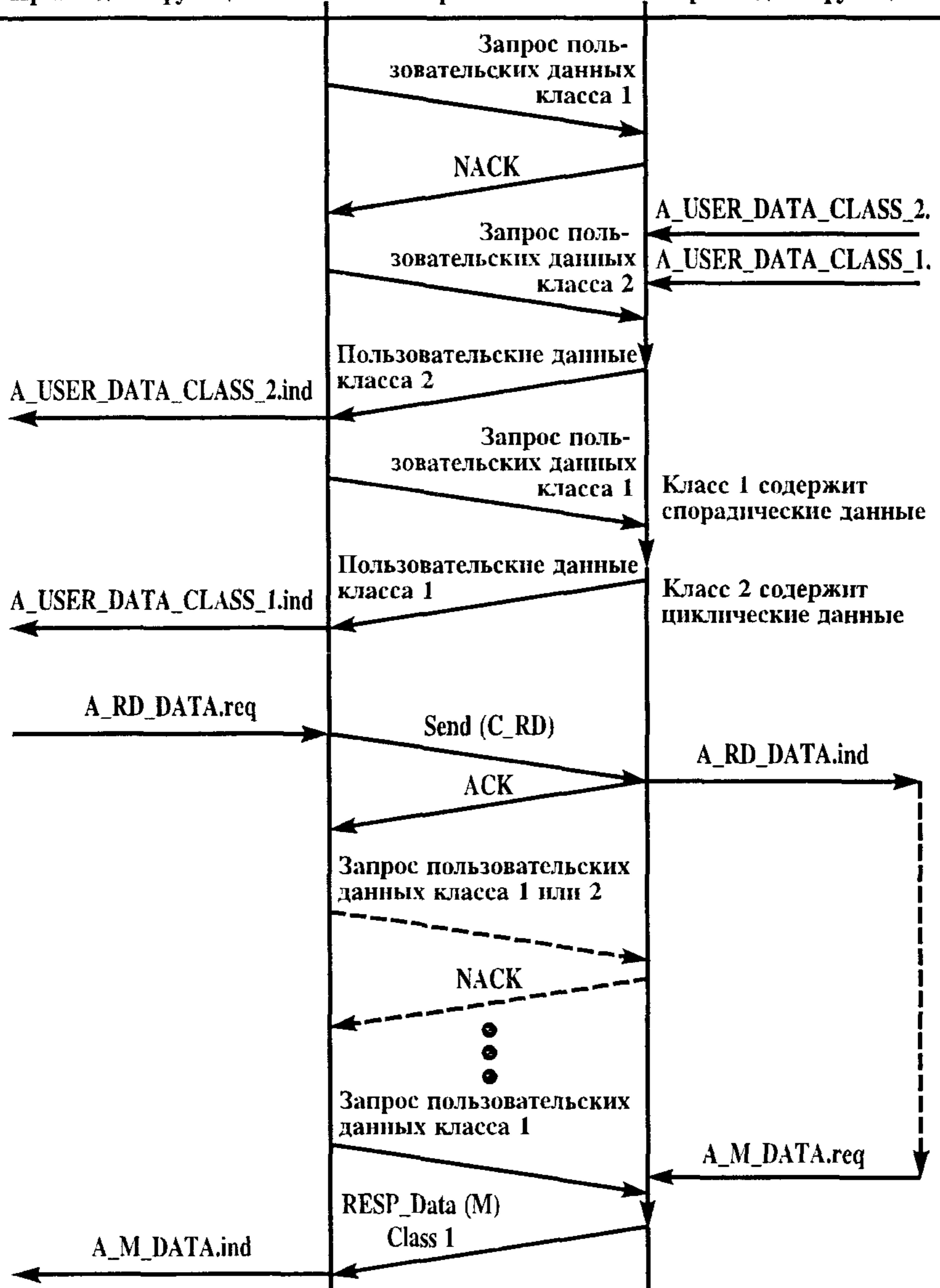
Рисунок 10 — Последовательная процедура — процедура опроса
