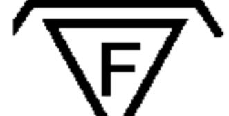
, должны иметь на прикрепленной к светильнику бирке или на отдельном листе в инструкции по эксплуатации, прилагаемой к светильнику, предупреждение о том, что светильник ни при каких условиях не должен контактировать с изолирующим или подобным материалом.
