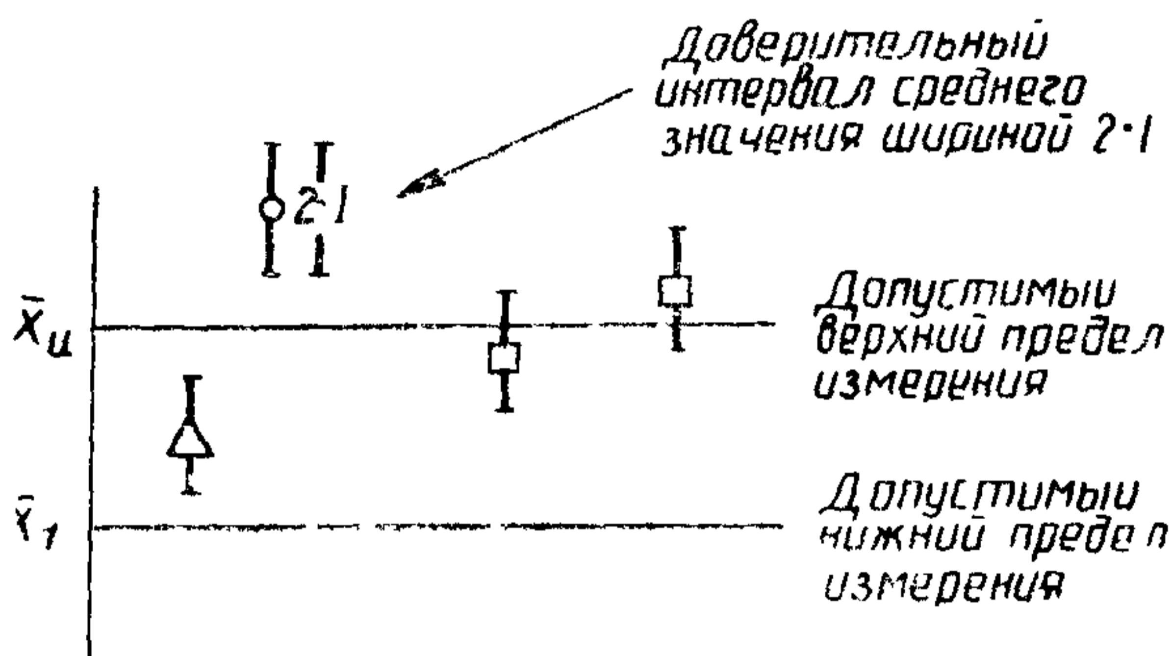
Испытание считается удовлетворительным, если доверительный интервал шириной  $2I$  находится внутри допустимых границ измерения  $\bar{x}_u$  и  $\bar{x}_l$
