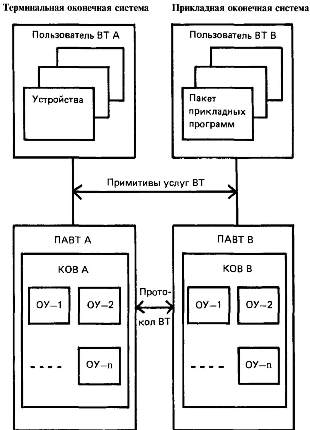
Рисунок 2 — Объекты управления в модели протокола ВТ
