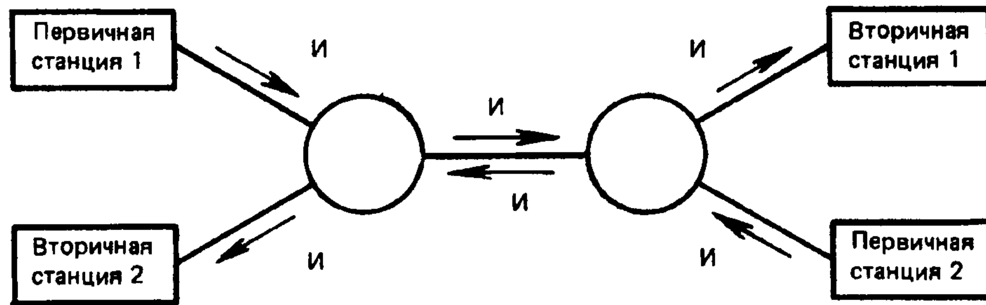
Рисунок 3 — Симметричная конфигурация звена данных
