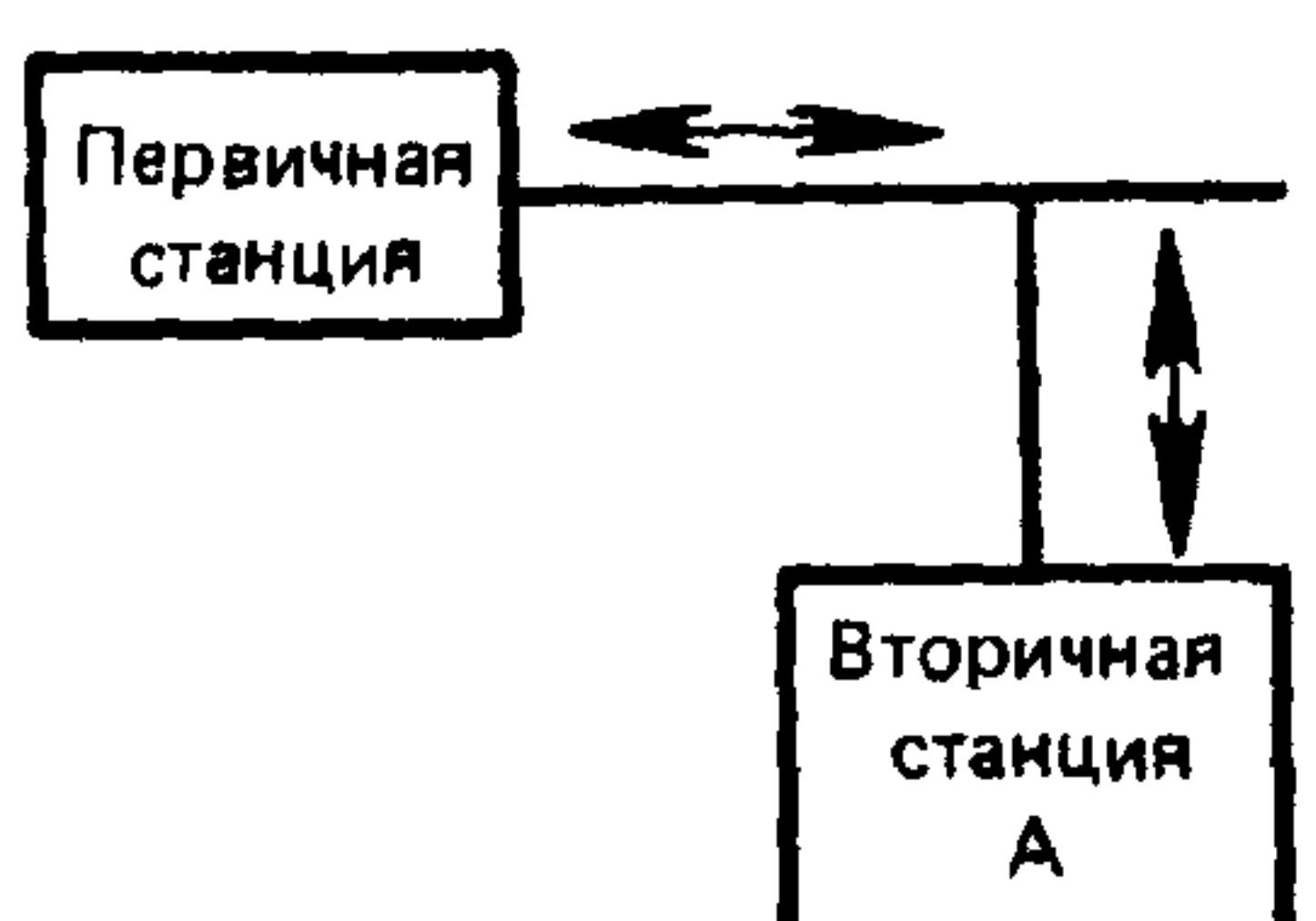
Рисунок 1 — Конфигурация несбалансированного звена данных
