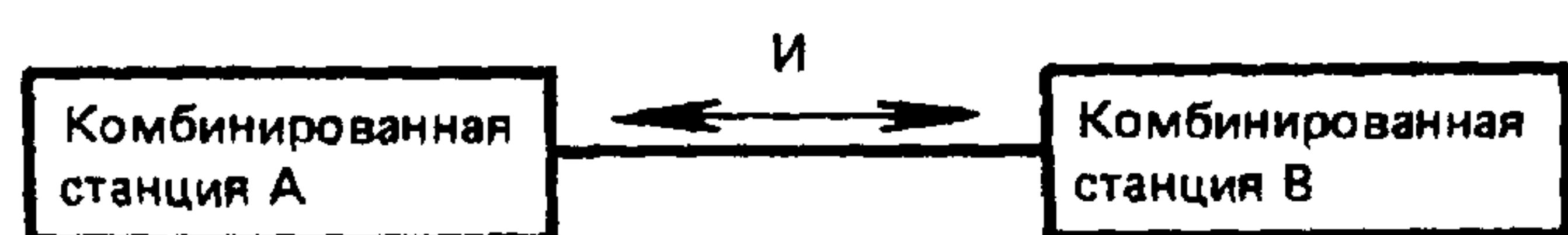
Рисунок 2 — Конфигурация сбалансированного звена данных
