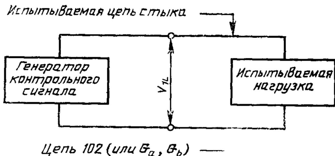
$V_{IL}$  — Напряжение в точке стыка
