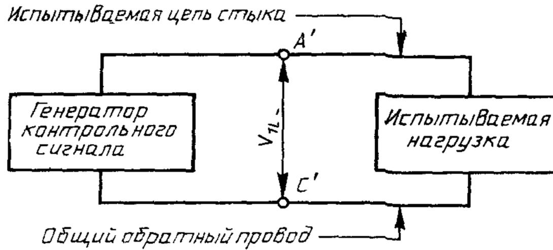
$V_{1L}$  — напряжение в точках стыка
