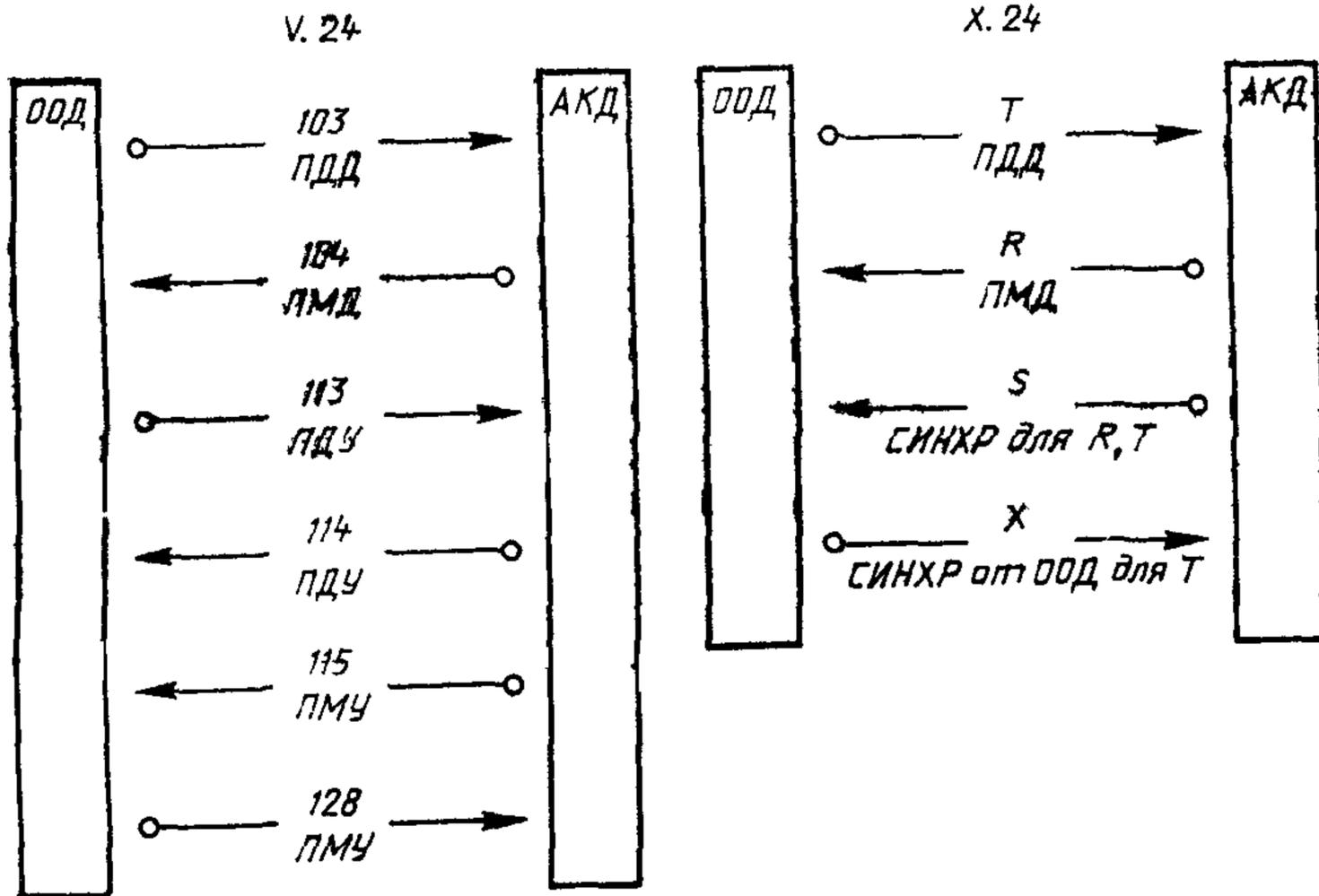
ПДД — передаваемые данные; ПМД — принимаемые данные; ПДУ — передаваемое управление; ПМУ — принимаемое управление.
