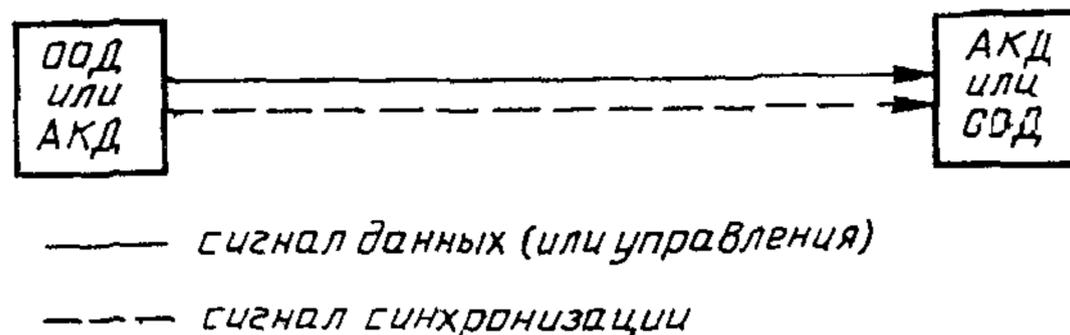
Рисунок 7. — Сонаправленная синхронизация
