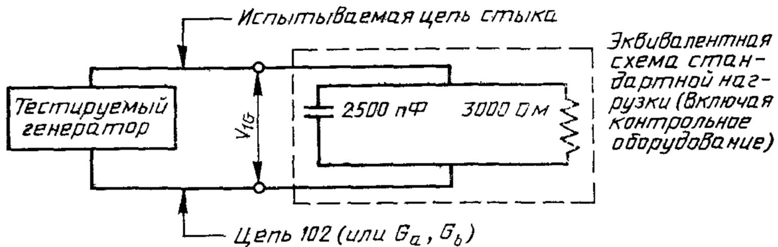
$V_{1G}$  — напряжение в точке стыка
