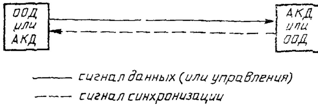
Рисунок 8 — Контрнаправленная синхронизация
