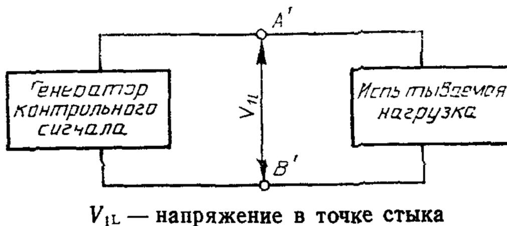
Рисунок 6 — Испытательная схема нагрузки V.11
