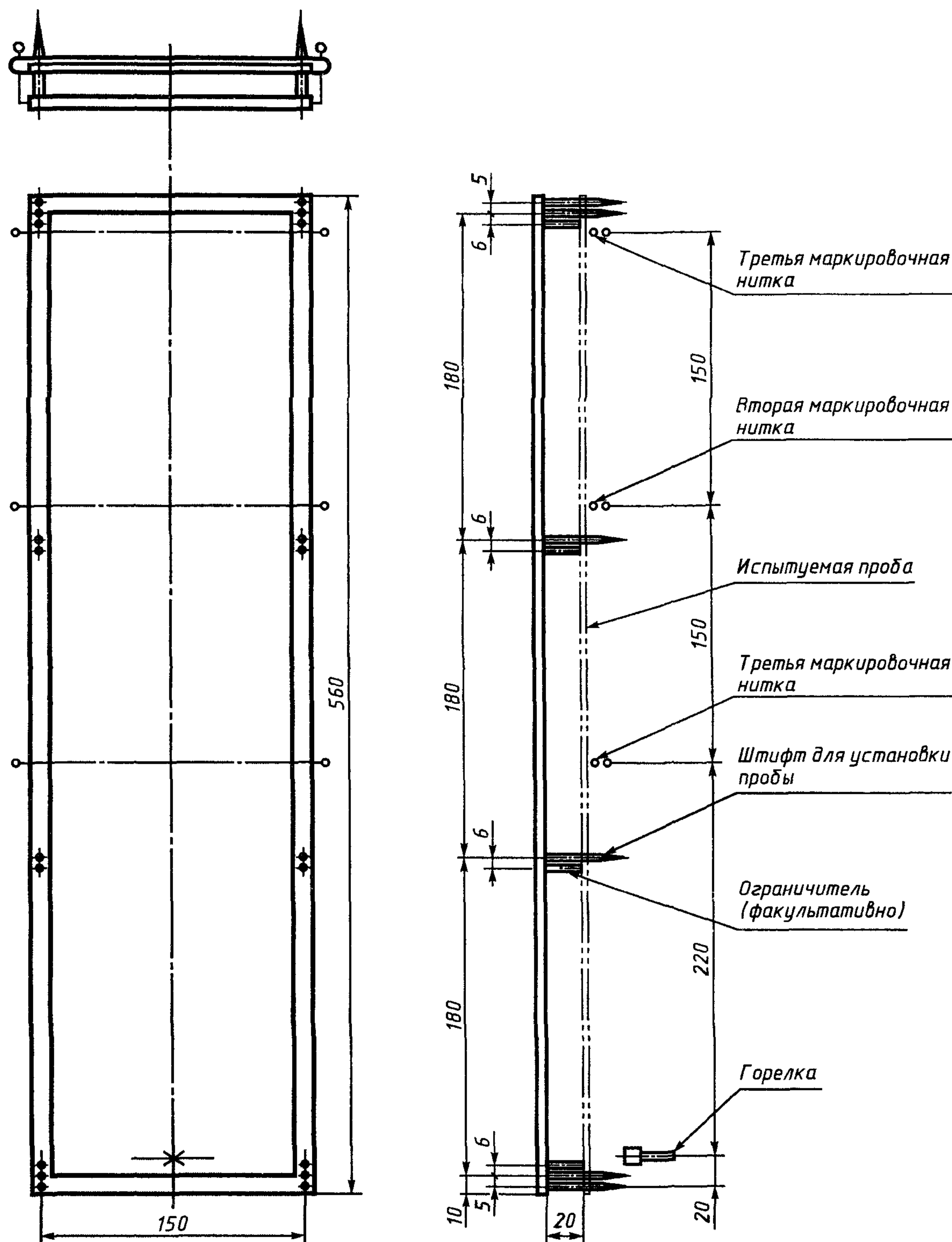
Рисунок 1 — Схема держателя для элементарной пробы
