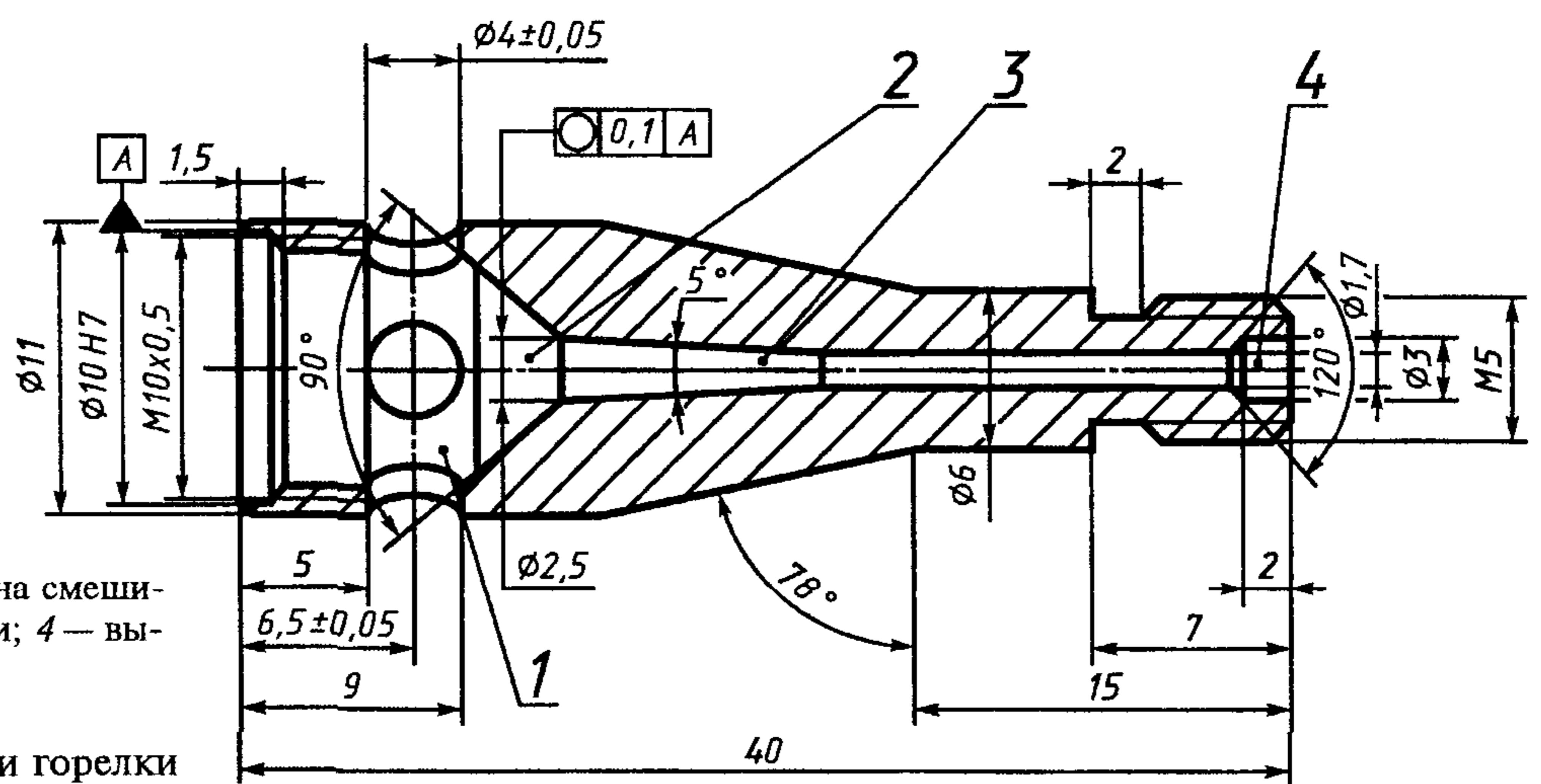
*1* — воздушная камера; *2* — зона смешивания газа; *3* — зона диффузии; *4* — выпускное отверстие
