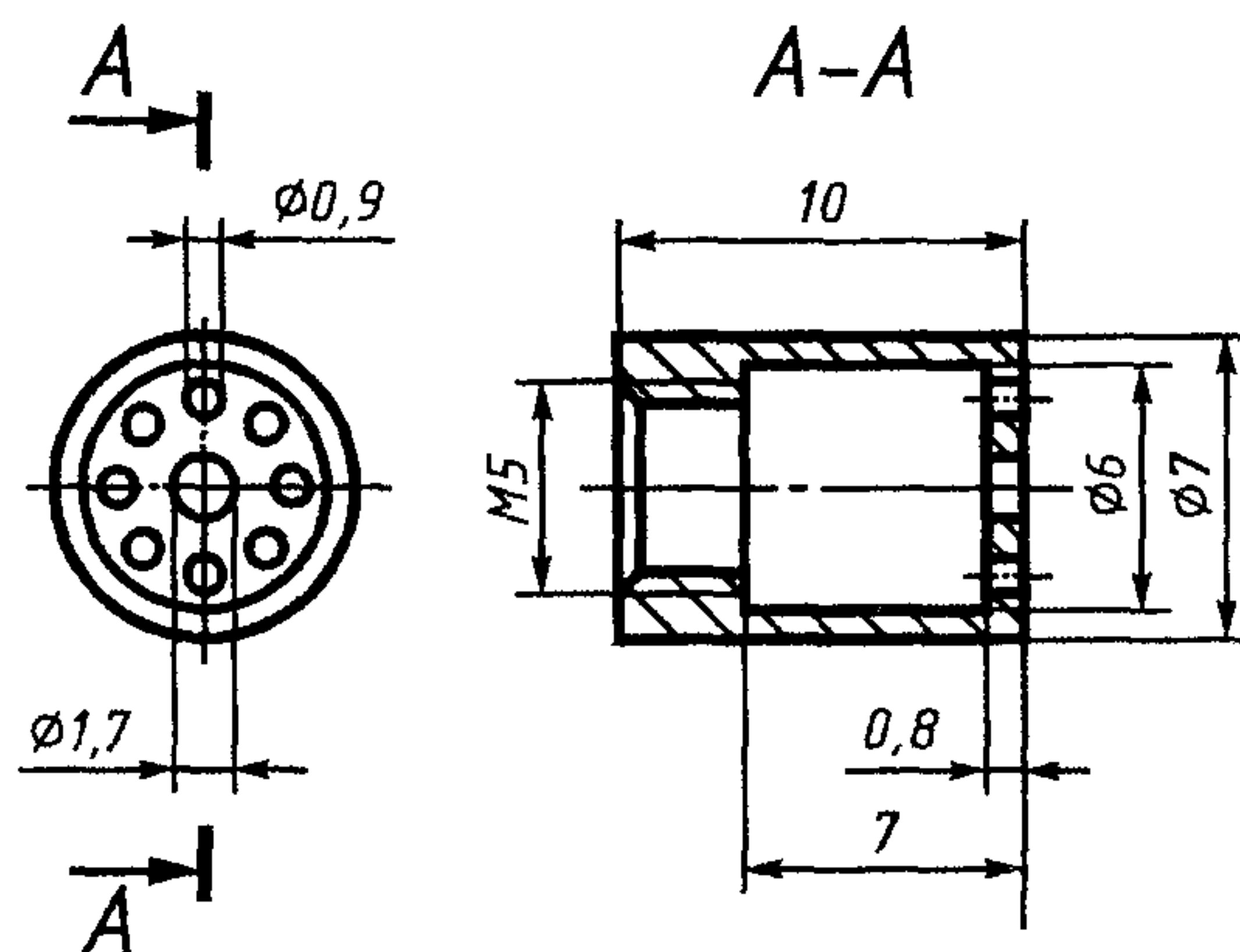
Рисунок А.4 — Схема стабилизатора пламени
