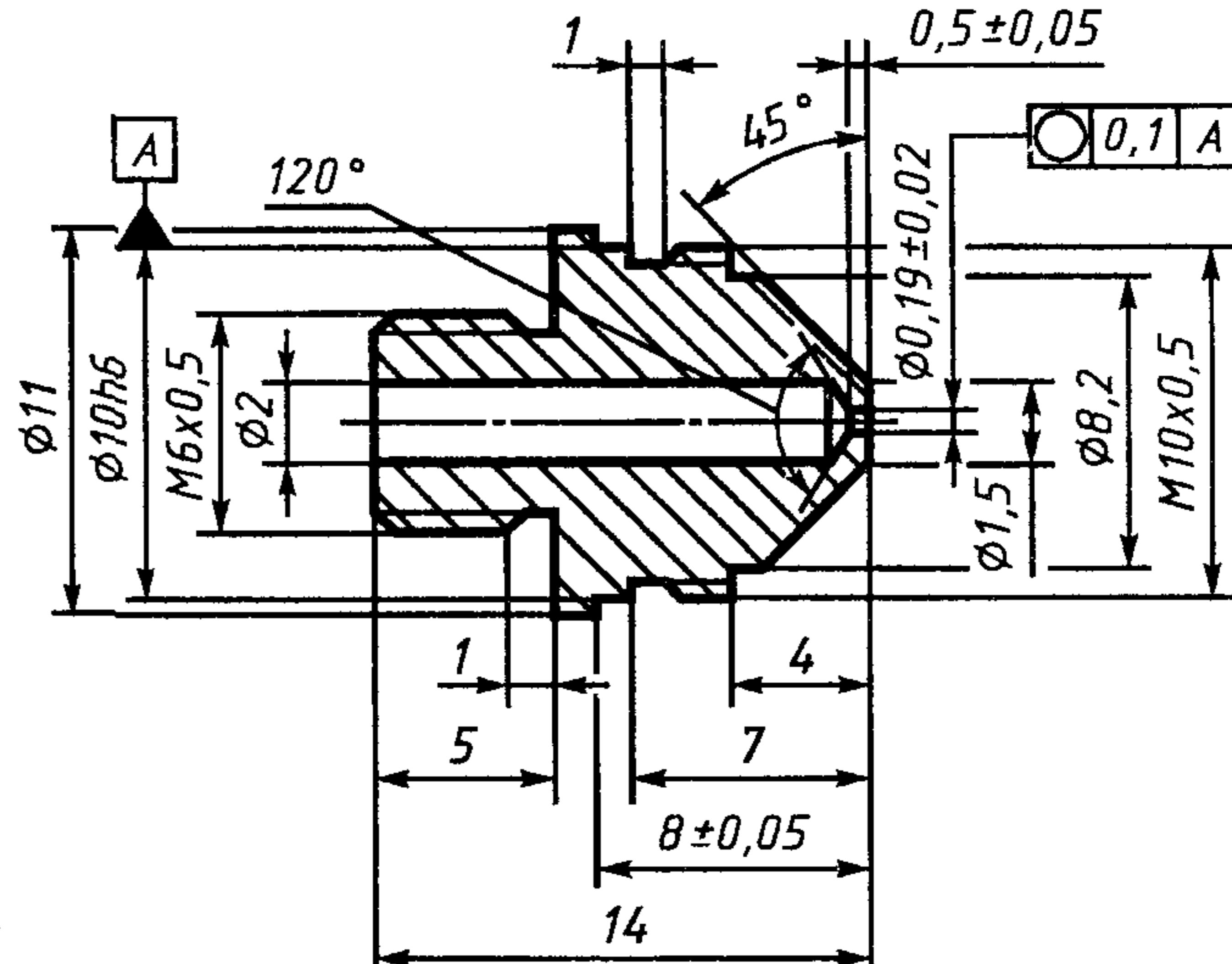
Рисунок А.2 – Схема газовой форсунки
