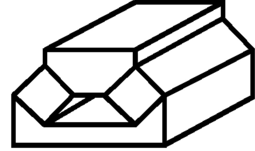
Пример 2 — Три ортогональные плоскости симметрии (10 ненулевых элементов; 8 различных значений)
