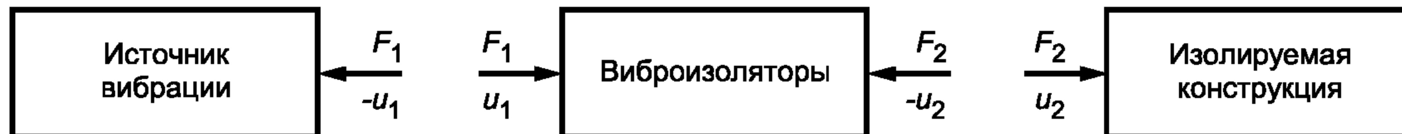
Рисунок 1 — Блок-схема системы «источник вибрации — виброизоляторы — изолируемая конструкция»
