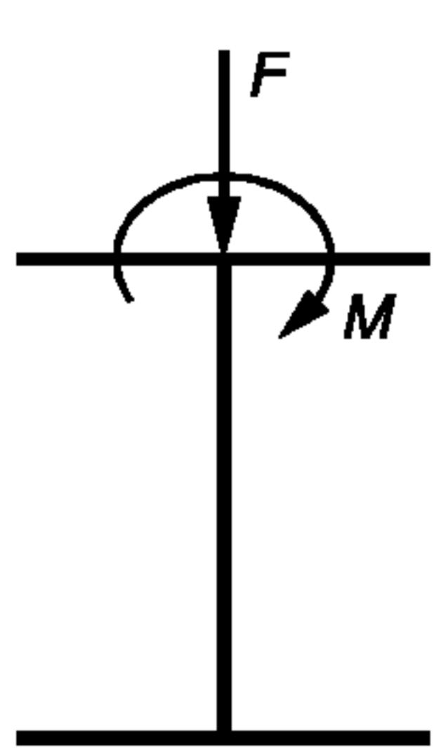
Рисунок С.1 — Возбуждение в точке на вершине двутавровой балки силой  $F$  и моментом  $M$
