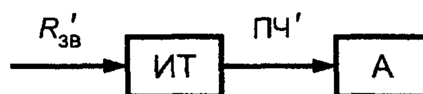
Рисунок 24 — Схема измерения частоты пилот-сигнала в канале передачи сигнала изображения
