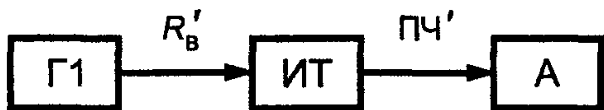
Рисунок 22 — Схема измерения девиации частоты сигнала, вызванной измерительным синусоидальным сигналом
