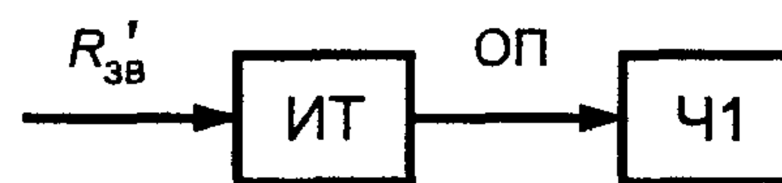
Рисунок 24 — Схема измерения частоты пилот-сигнала в канале передачи сигнала изображения
