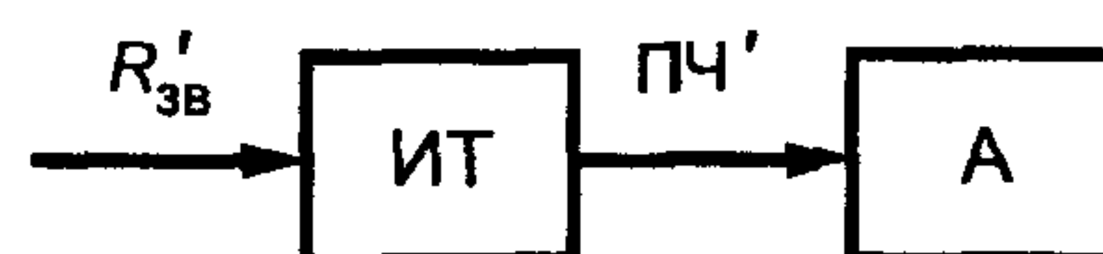
Рисунок 30 — Схема измерения девиации ПЧ, вызванной поднесущей частотой
