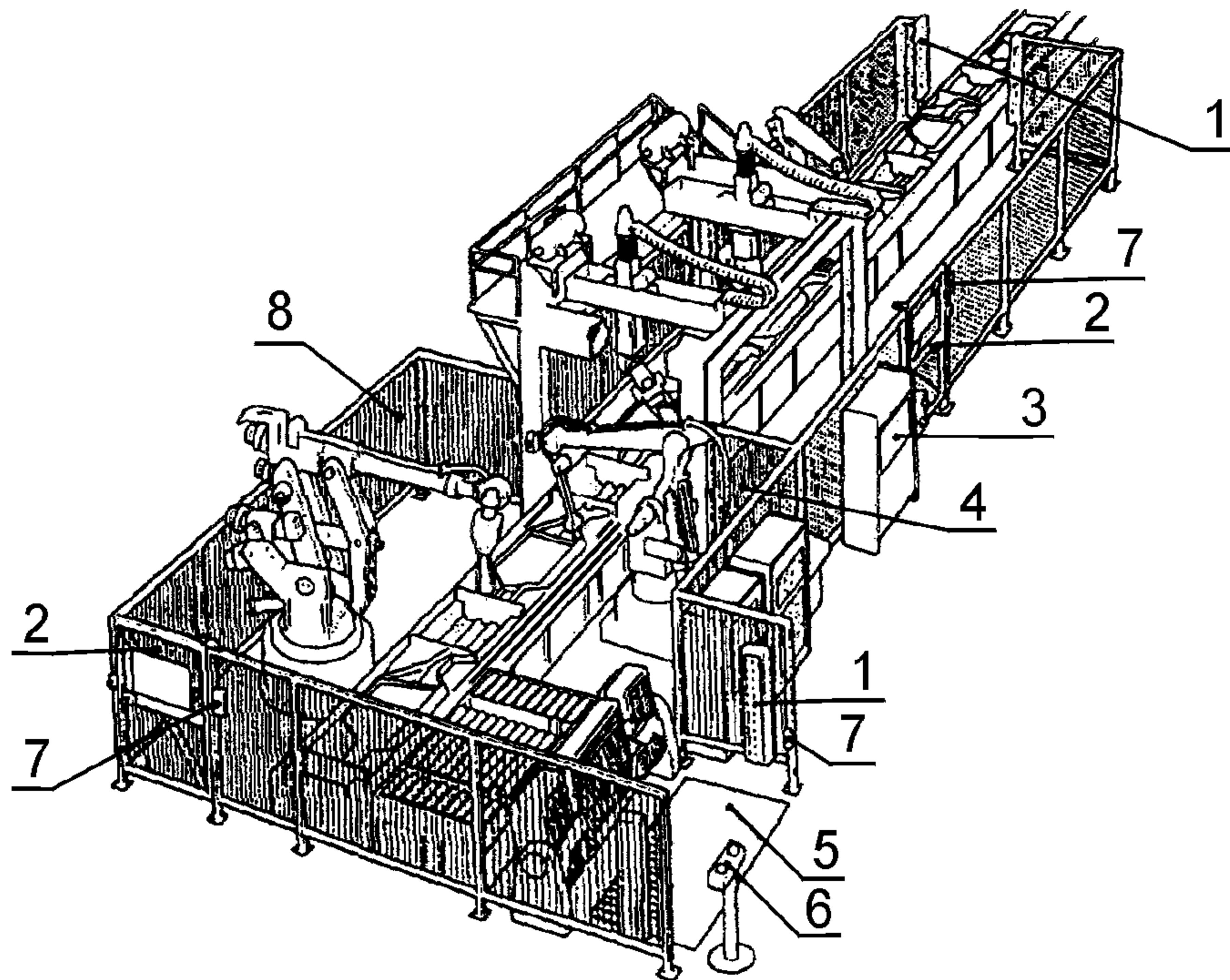
1 — фотоэлектрический барьер; 2 — съемное защитное устройство с блокировкой; 3 — коммутационный шкаф; 4 — внутреннее ограждение, разрешающее допуск в определенном месте; 5 — изолирующий коврик; 6 — устройство для двуручного включения; 7 — орган возврата в исходное положение; 8 — съемное защитное устройство
