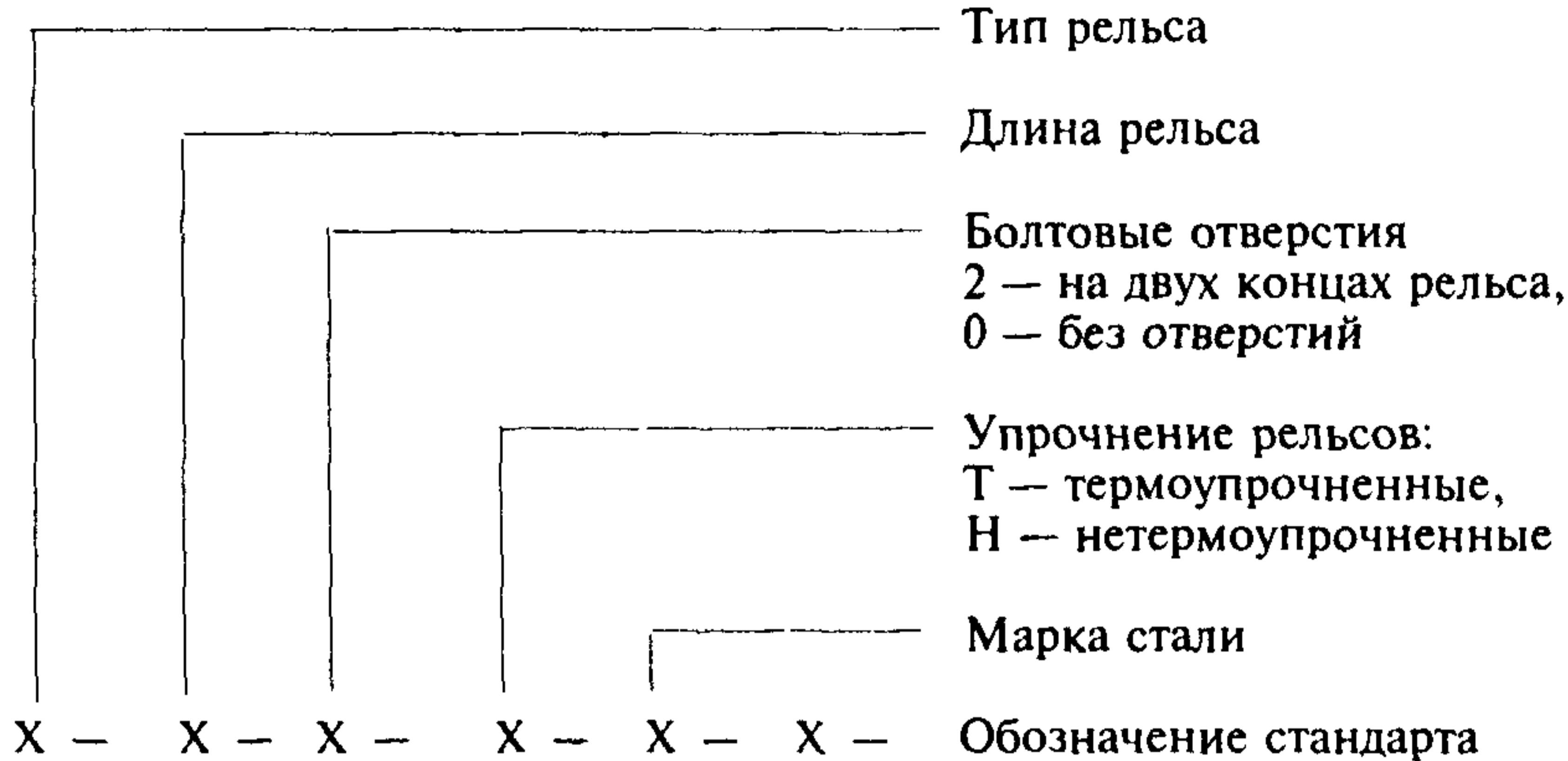
Пример условного обозначения рельса типа РП65, длиной 25 м, с болтовыми отверстиями на двух концах (2), термоупрочненного (Т), из стали марки 76Ф:
