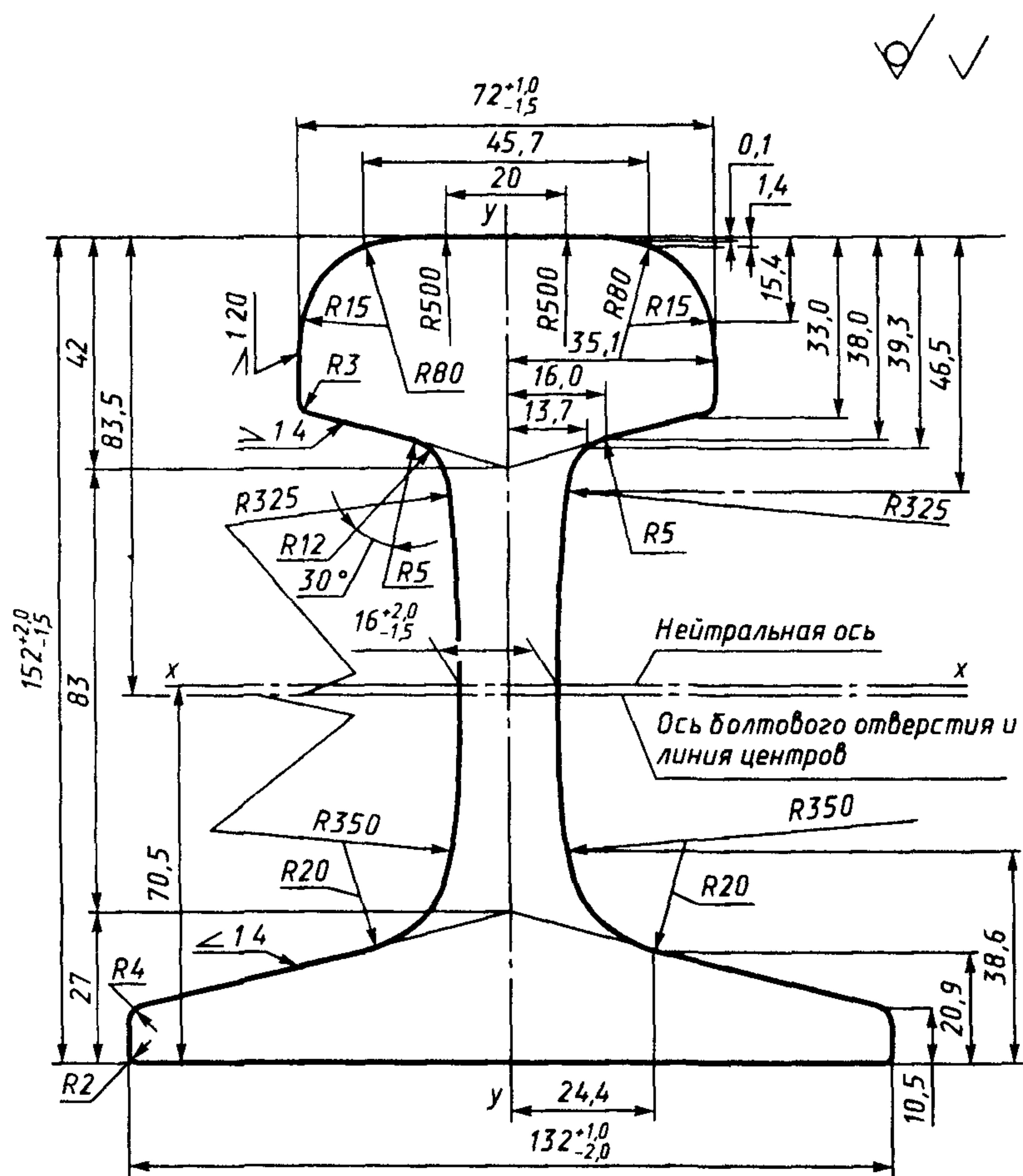
Рисунок 1 — Поперечное сечение рельса типа РП50
