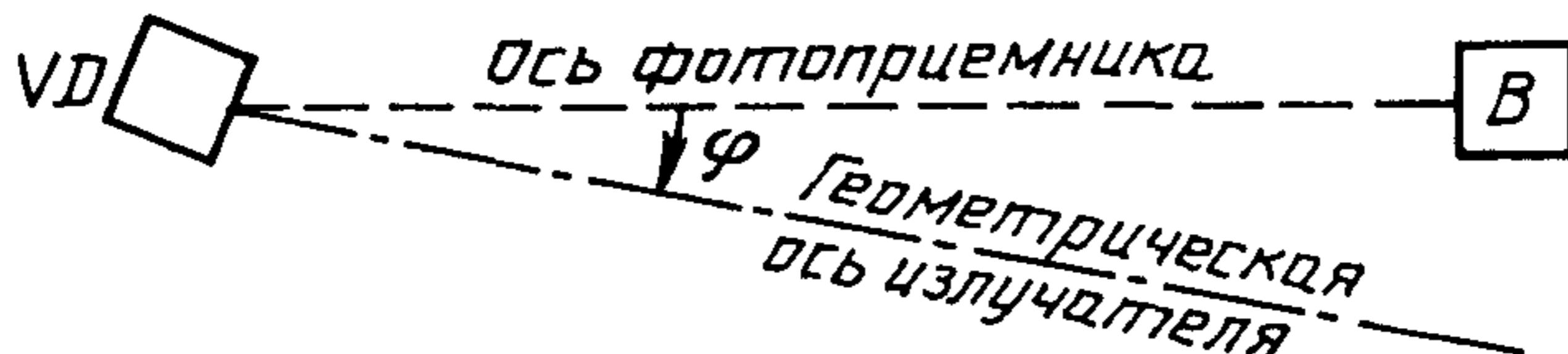
*VD*—проверяемый излучатель; *B*—фотоприемник;  $\phi$ —угол между осью фотоприемника и геометрической осью излучателя
