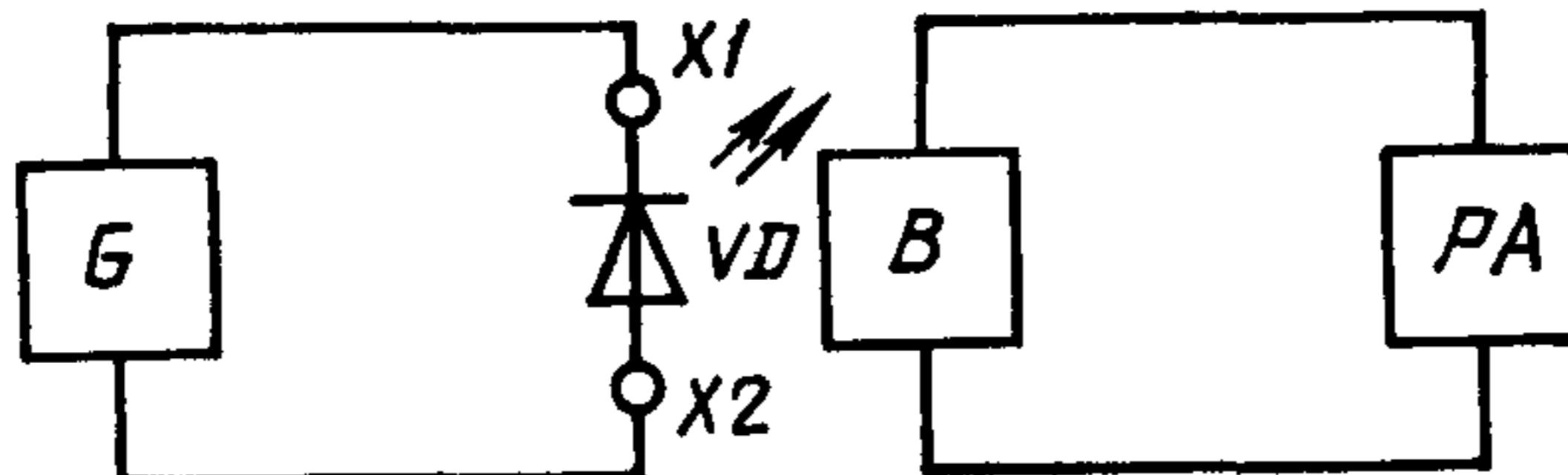
*G*—источник прямого тока; *VD*—излучатель; *X<sub>1</sub>* и *X<sub>2</sub>*—контакты подключения излучателя; *B*—фотоприемник; *PA*—измеритель тока
