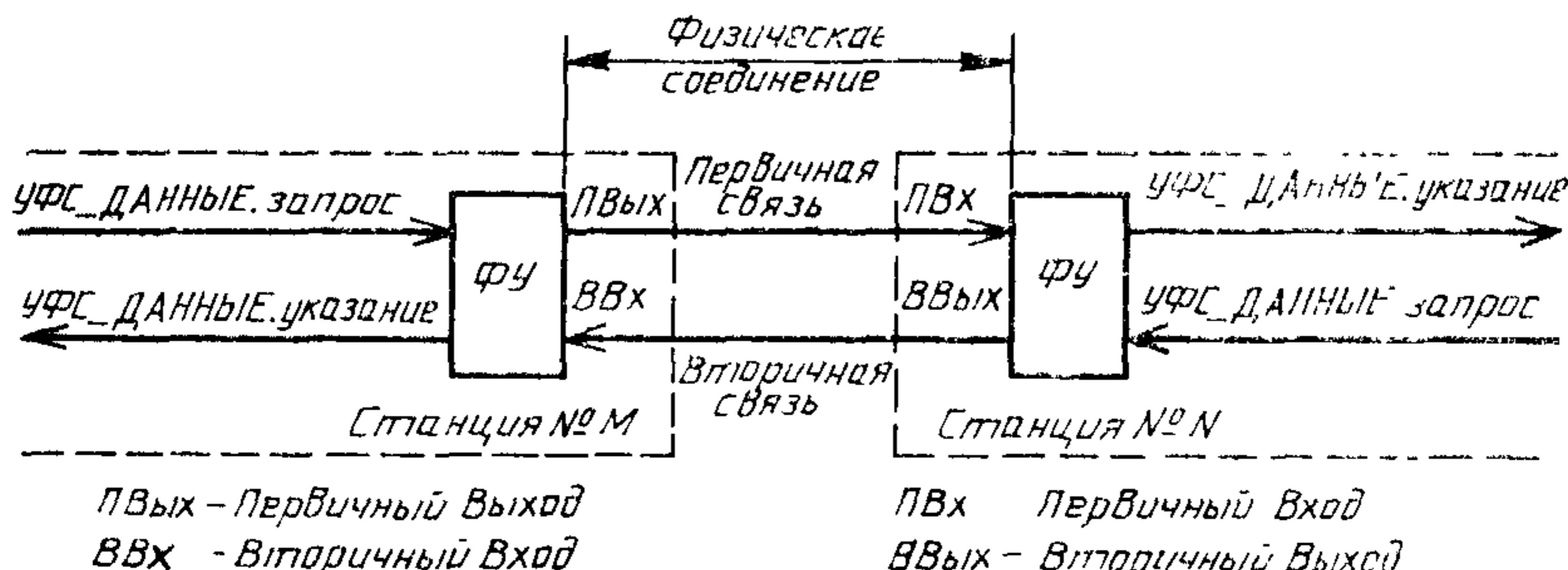
Рисунок 1 — Пример физического соединения ВОРИПД
