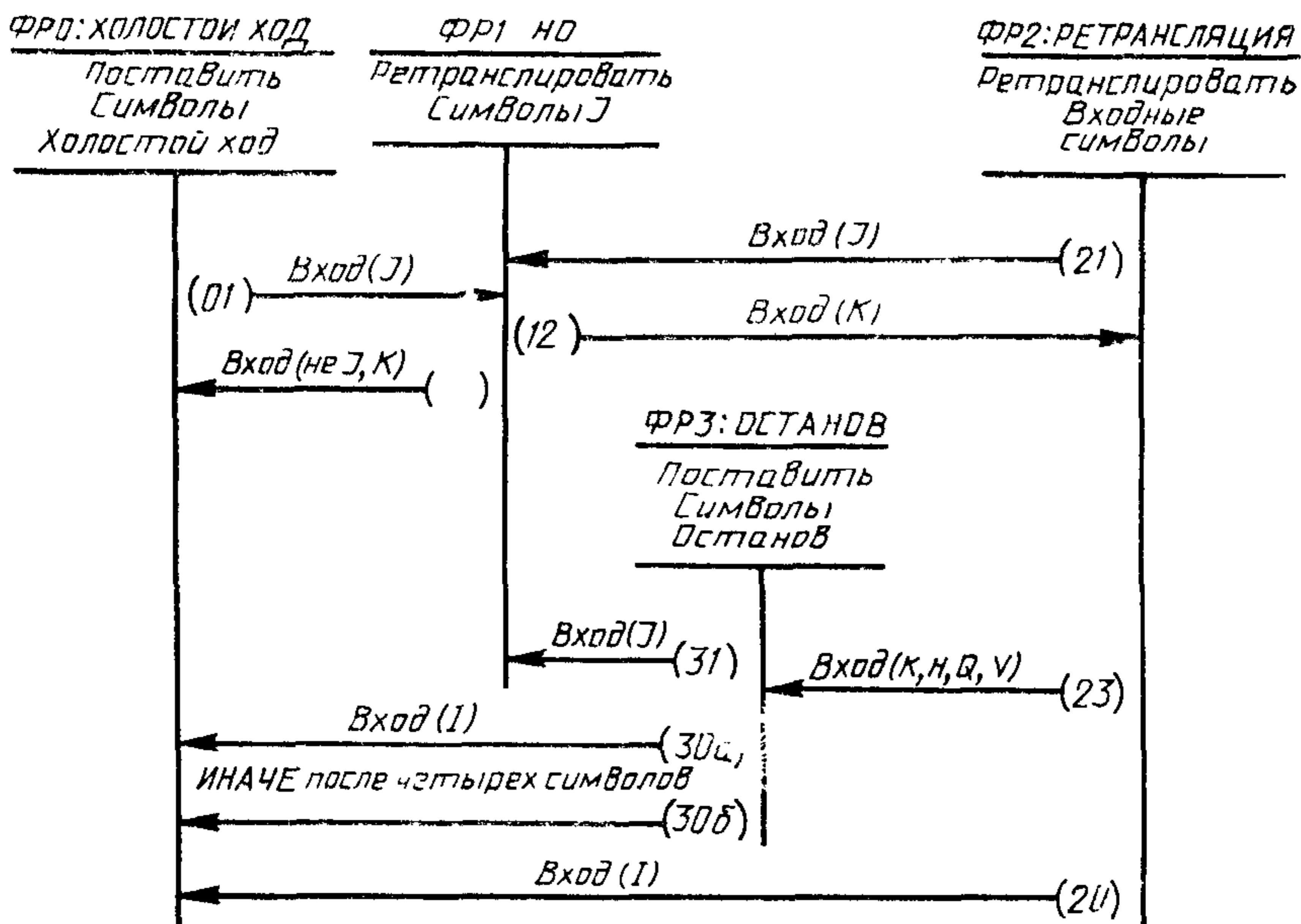
Рисунок 4 – Диаграмма состояний фильтра ретрансляции
