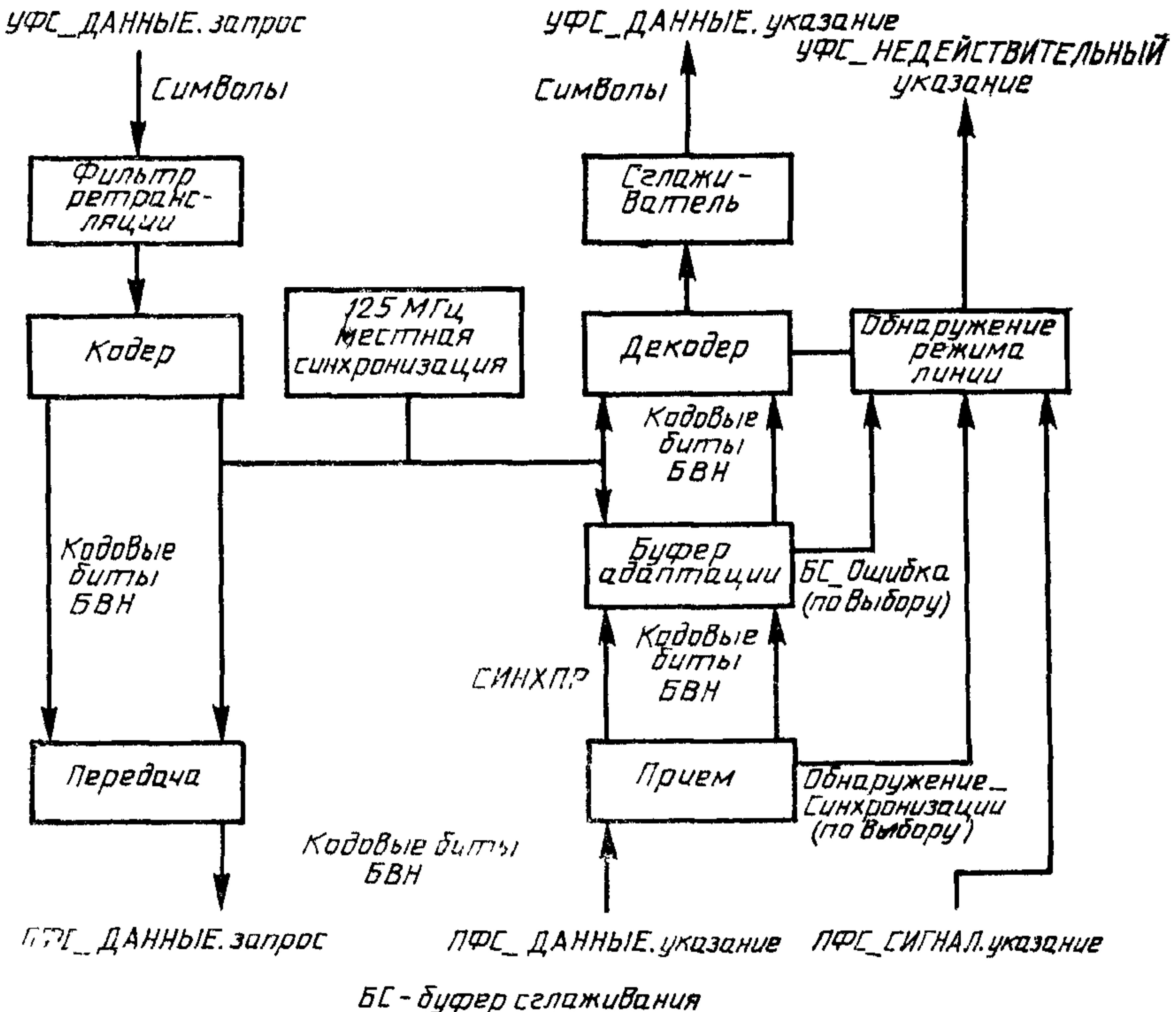
Рисунок 2 — Пример функциональной блочной диаграммы ВОРИПД УФС
