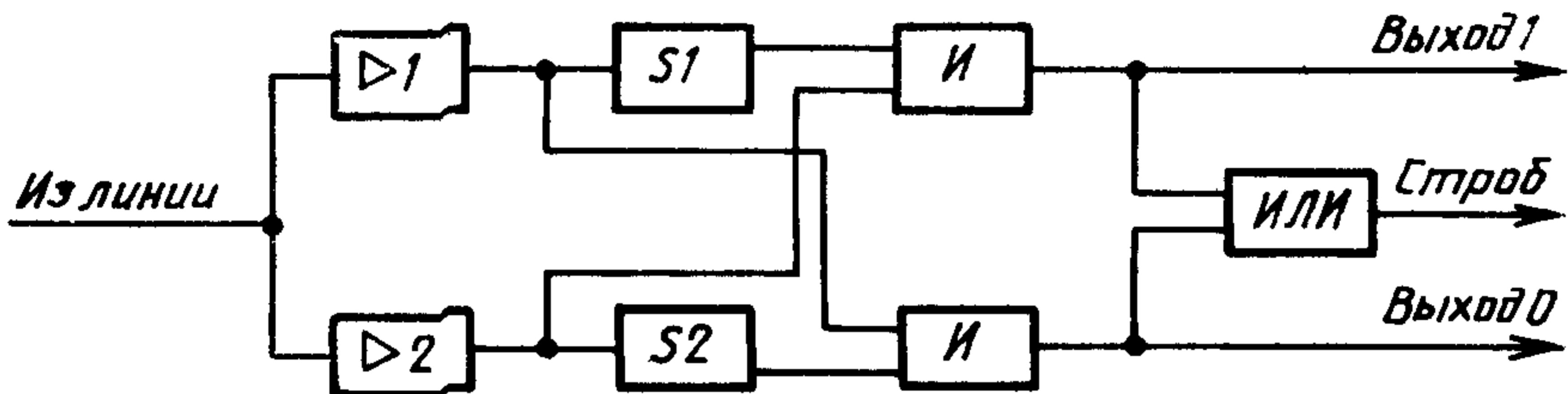
1 — усилитель положительных импульсов; 2 — усилитель отрицательных импульсов;
