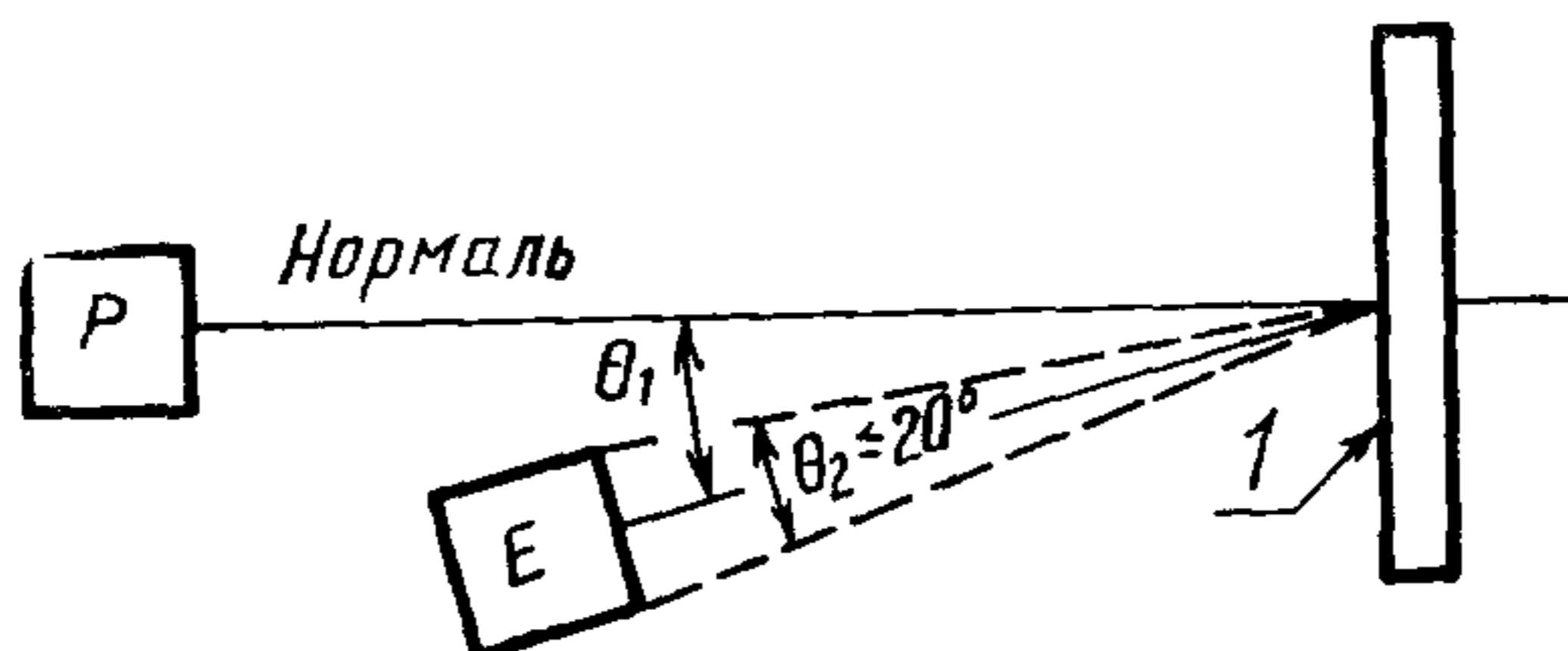
/ — поверхность с эталонной отражающей способностью (заменяется рабочей индикаторной поверхностью после регулирования источника света, имитирующего солнечное излучение)
