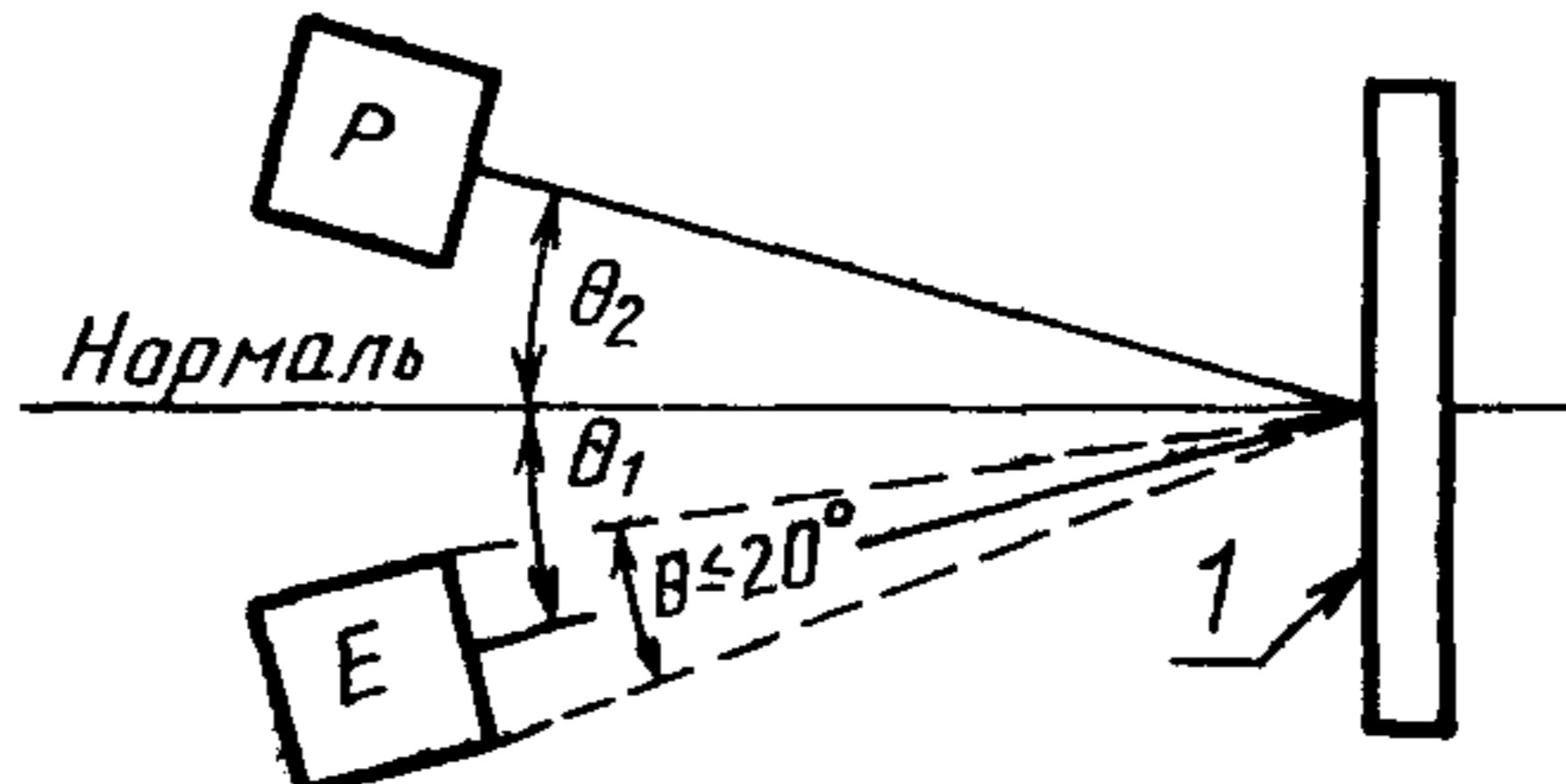
1 — поверхность с эталонной отражающей способностью (заменяемая рабочей индикаторной поверхностью после регулирования источника света, имитирующего солнечное излучение) Е — источник света Р — фотометр
