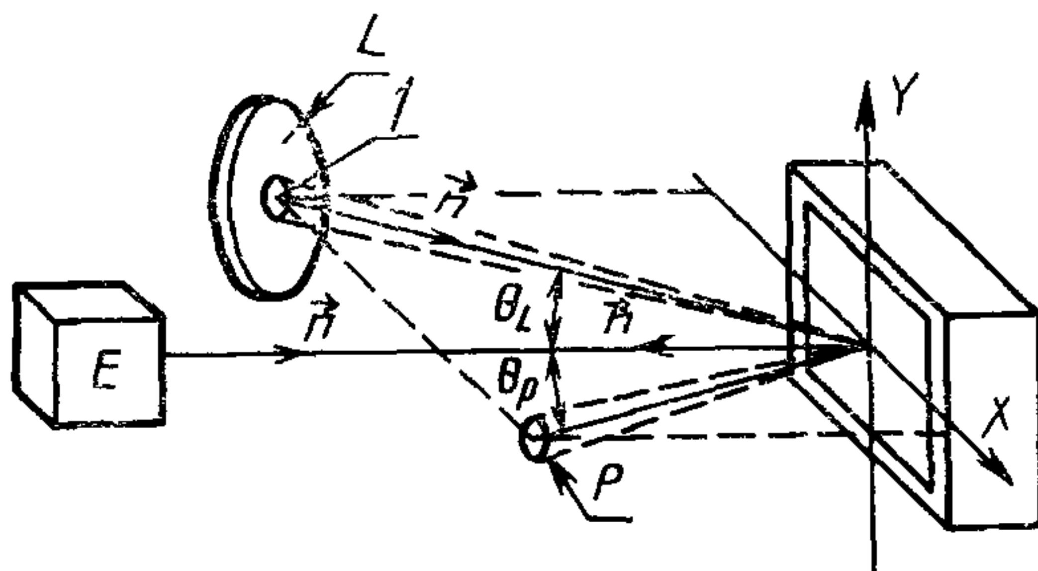
1 — проекция апертуры для приема света на отражающую поверхность источника, используемого при измерении Е — источник света
