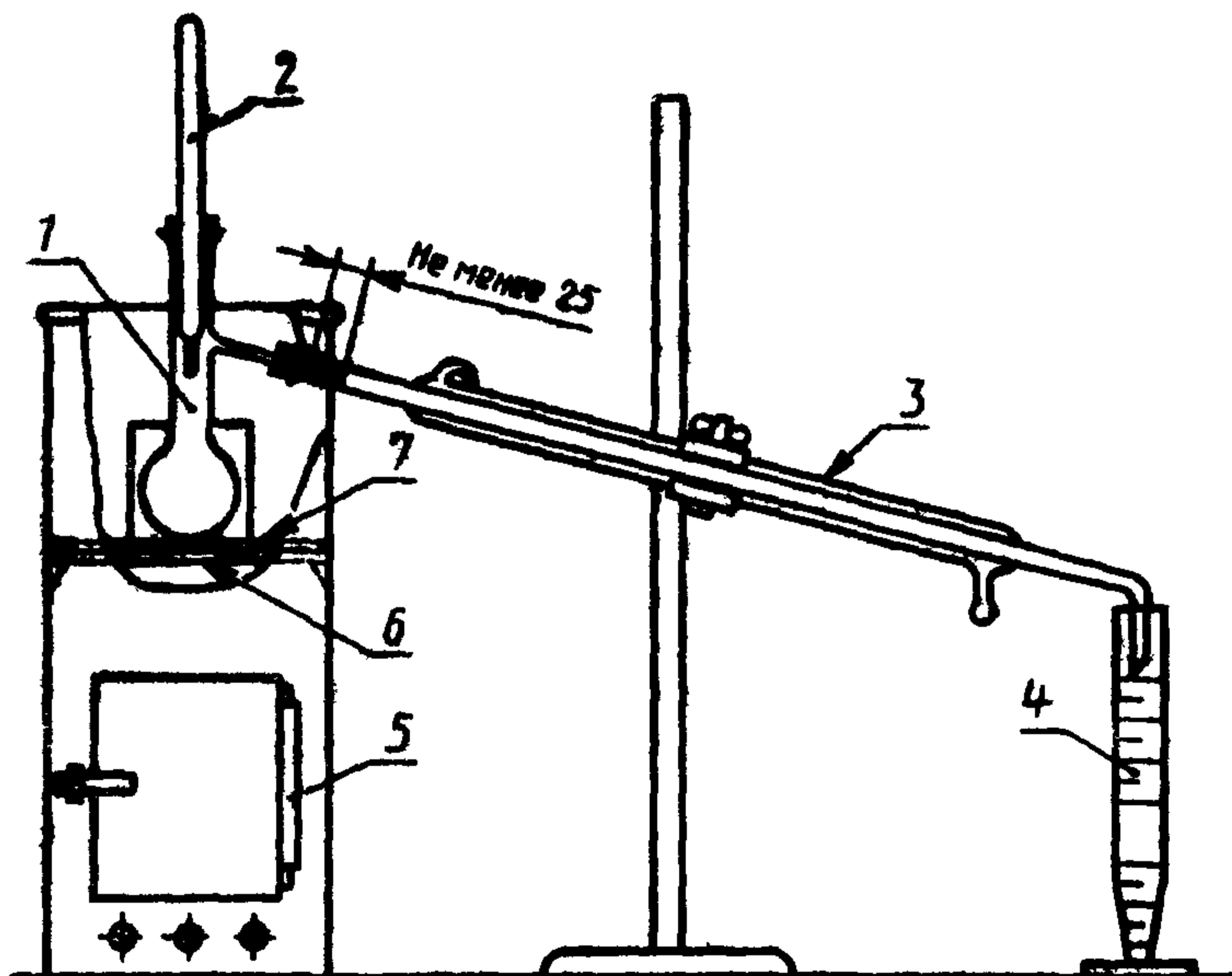
1 — дистилляционная колба (п. 4.1.1); 2 — термометр (п. 4.1.2), 3 — холодильник (п. 4.1.4), 4 — приемник (п. 4.1.3); 5 — защитный кожух (п. 4.1.5), 6 — огнеупорная полка, 7 — огнеупорная прокладка (п. 4.1.6)
