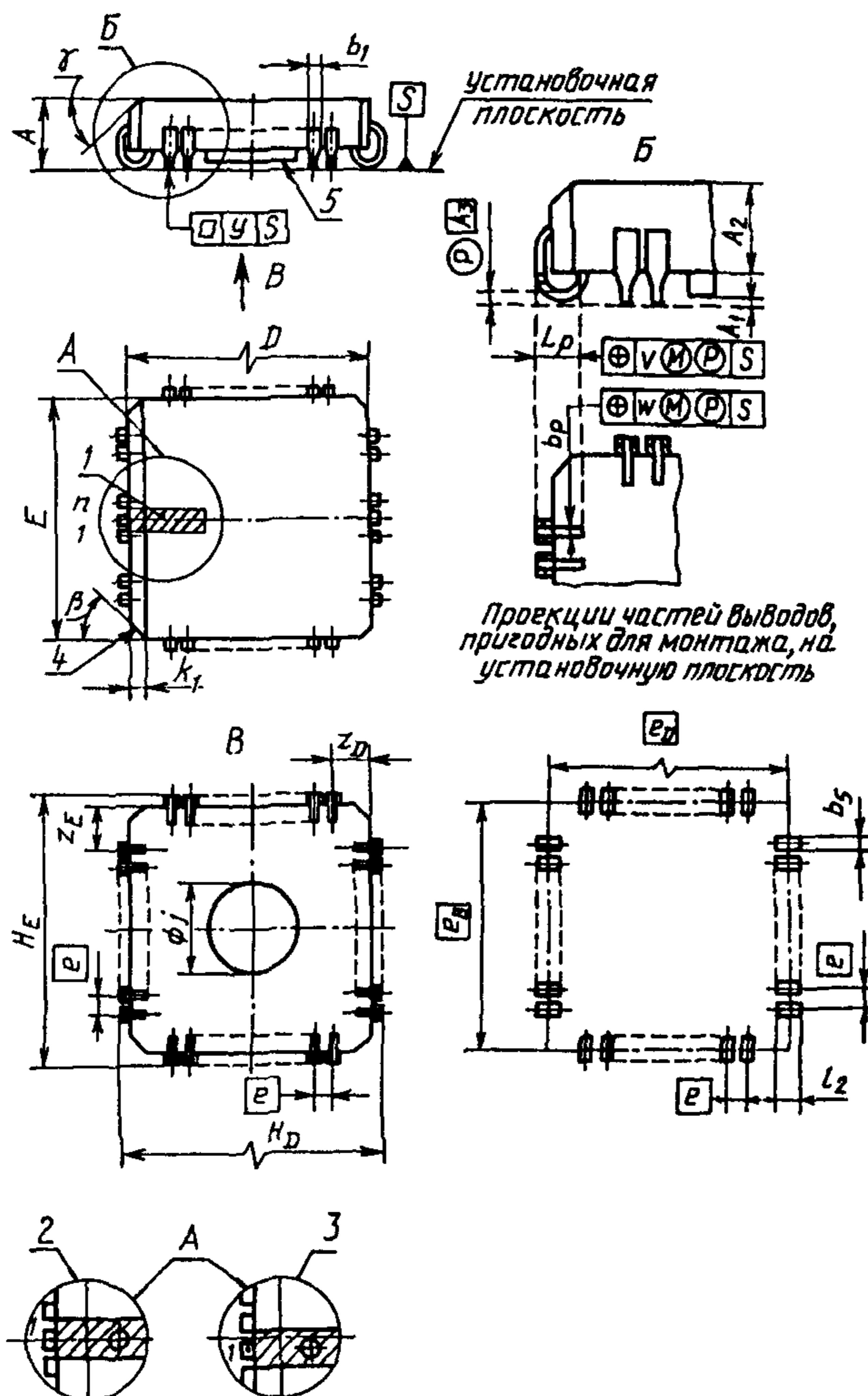
1 — зона расположения визуального ключа; 2 — вывод № 1 при прохождении оси симметрии корпуса через вывод; 3 — вывод № 1 при прохождении оси симметрии корпуса между выводами; 4 — механический ключ; 5 — выступ (наличие выступа не регламентируется)
