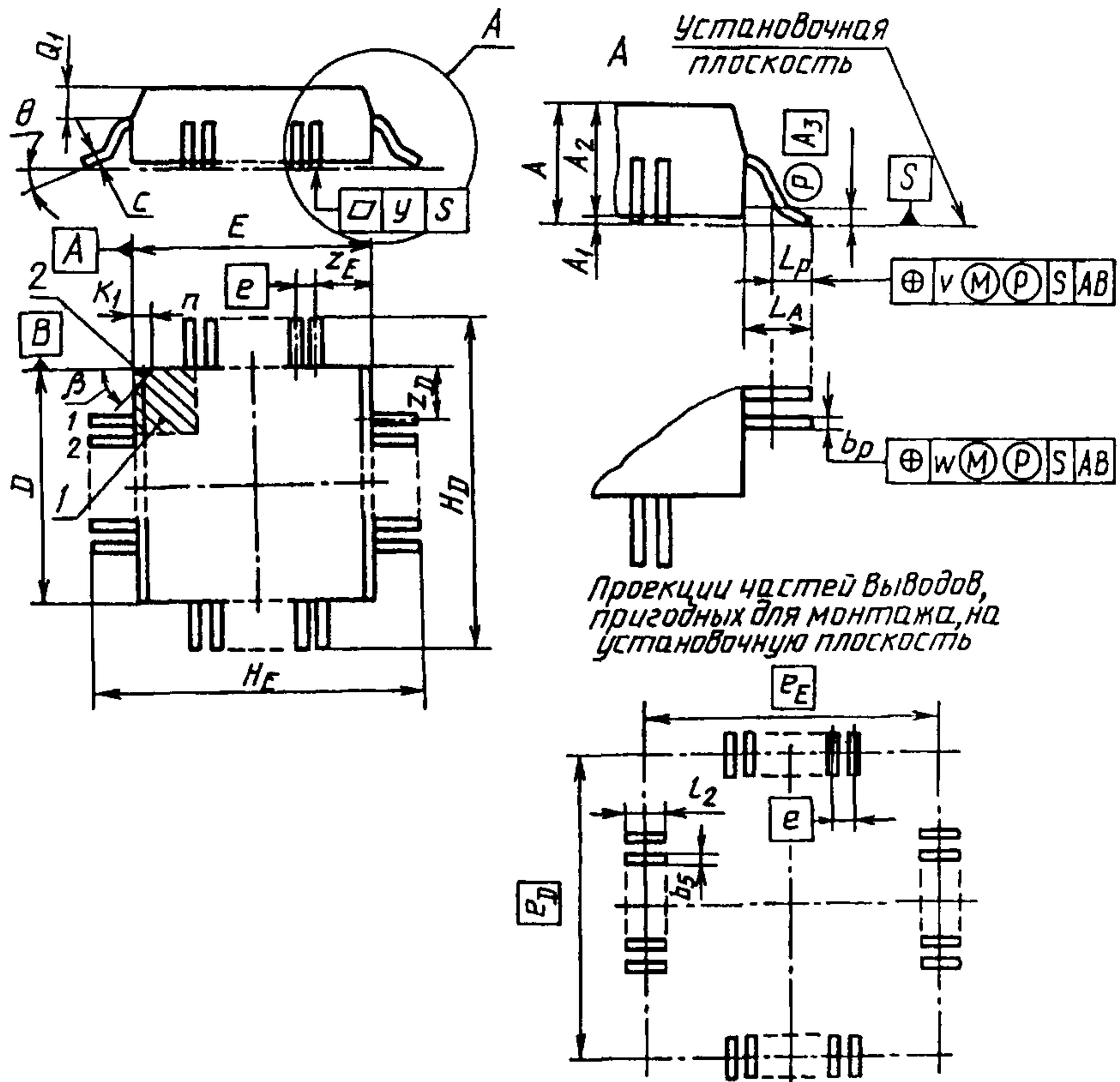
1 — зона расположения позиционного ключа на верхней плоскости корпуса; 2 — механический
