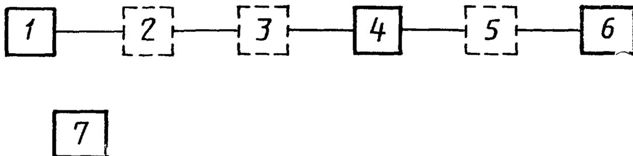
1 — лазер; 2 — диафрагма; 3 — фазовая пластина или призма; 4 — анализатор; 5 — ослабитель; 6 — средство измерения энергии (мощности) лазерного излучения; 7 — средство юстировки
