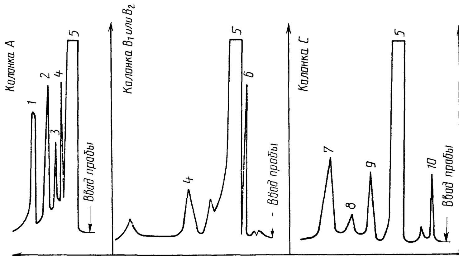
1—метанол; 2—ацетон; 3—дихлорметан; 4—винилиден хлористый; 5—метил хлористый;
