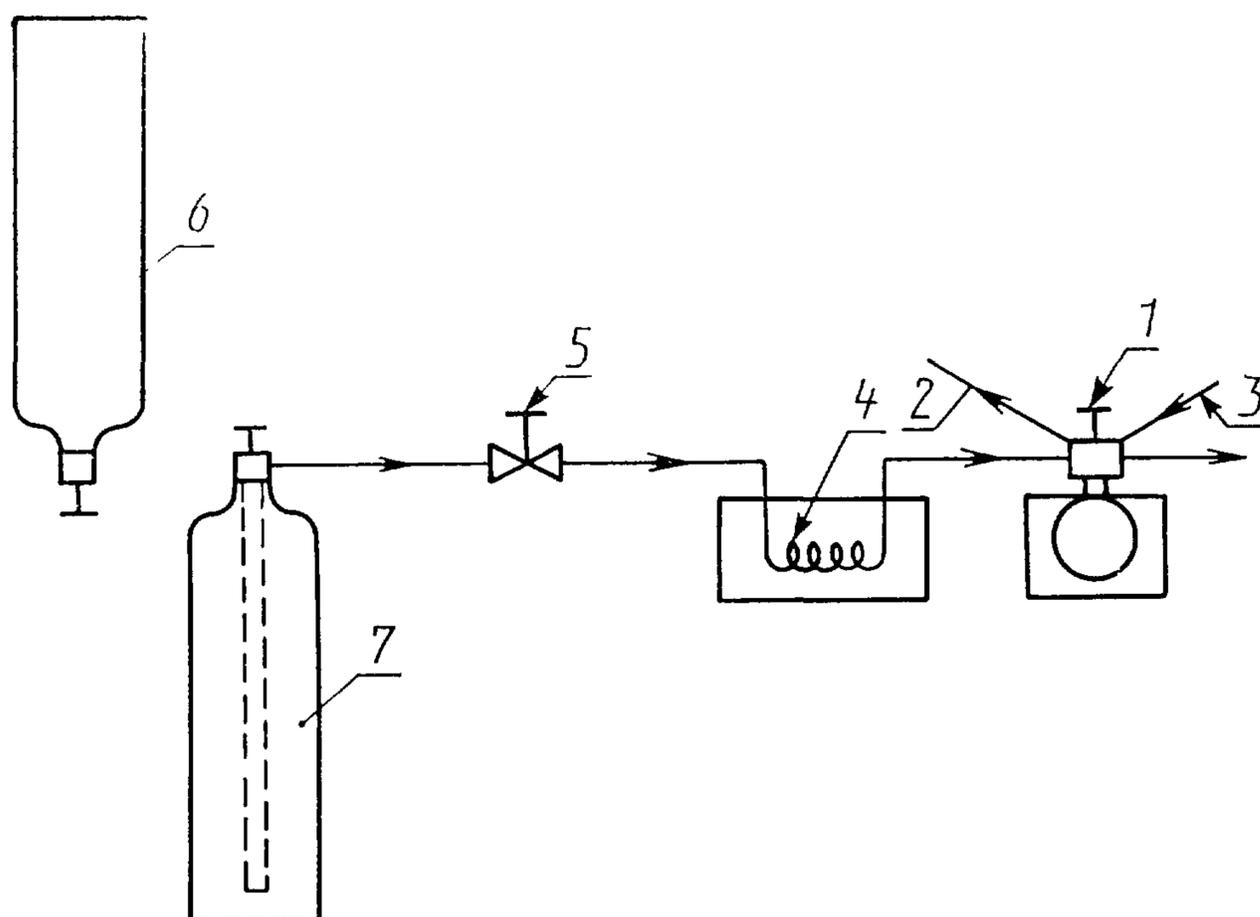
1—клапан для отбора проб; 2—сброс газа-носителя; 3—газ-носитель; 4—медный змеевик (трубка длиной 20—25 см, внешний диаметр 3,5 мм, внутренний диаметр 2 мм; трубка свернута в спираль диаметром 2 см); 5—вентиль тонкой регулировки; 6—пробоотборный цилиндр без погружной трубки; 7—пробоотборный цилиндр с погружной трубкой
