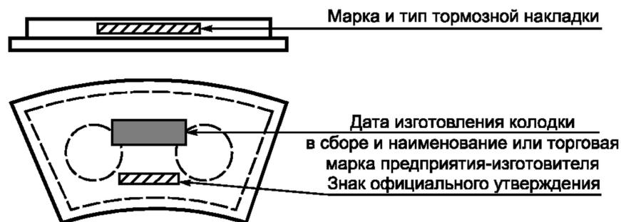
Пример маркировки колодки барабанного тормоза в сборе
