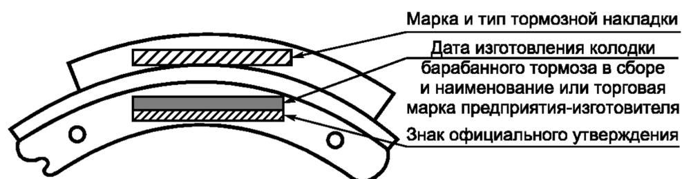
Пример маркировки тормозной накладки барабанного тормоза
