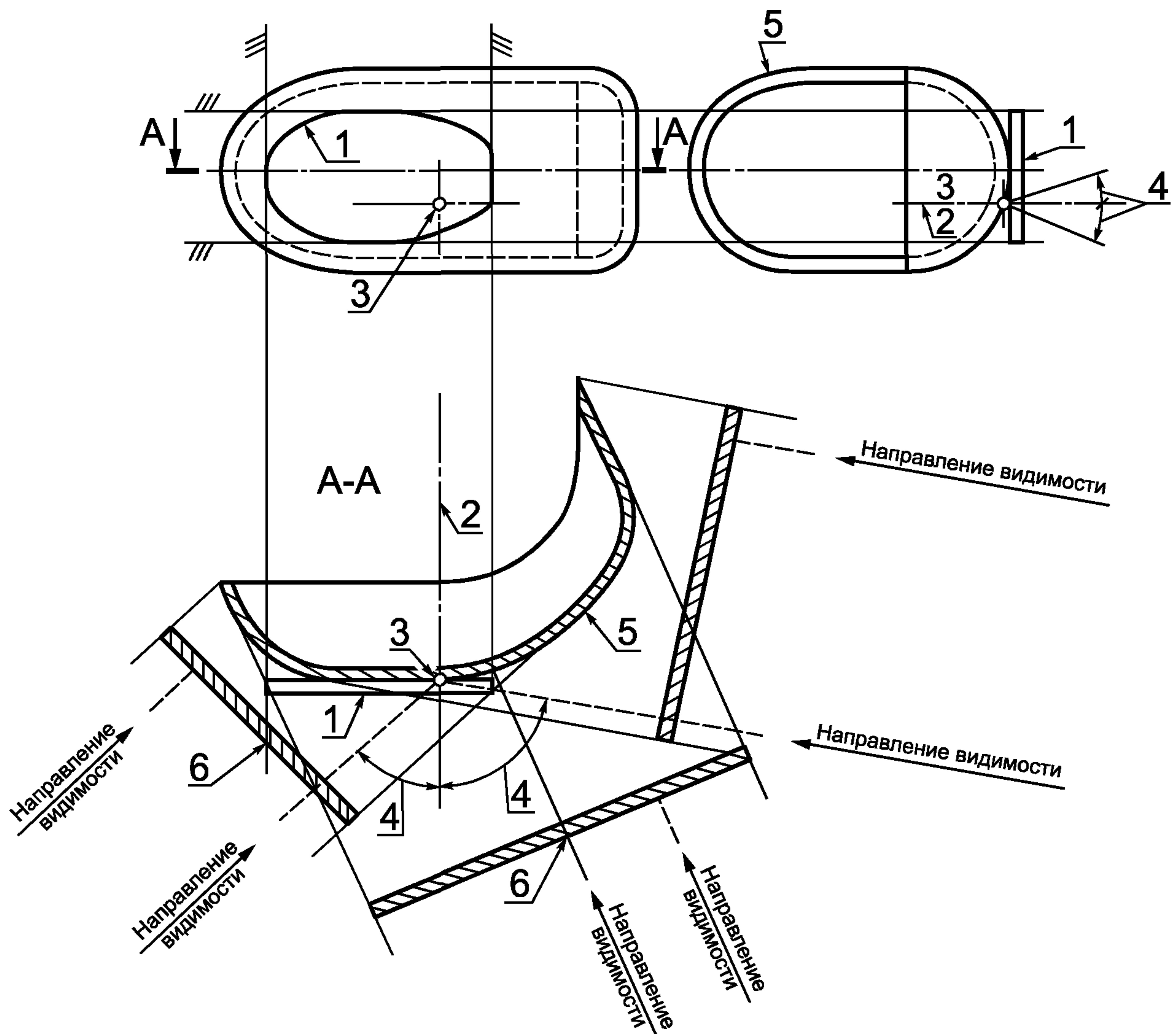
1 — освещаящая поверхность; 2 — исходная ось; 3 — исходный центр; 4 — угол геометрической видимости;
