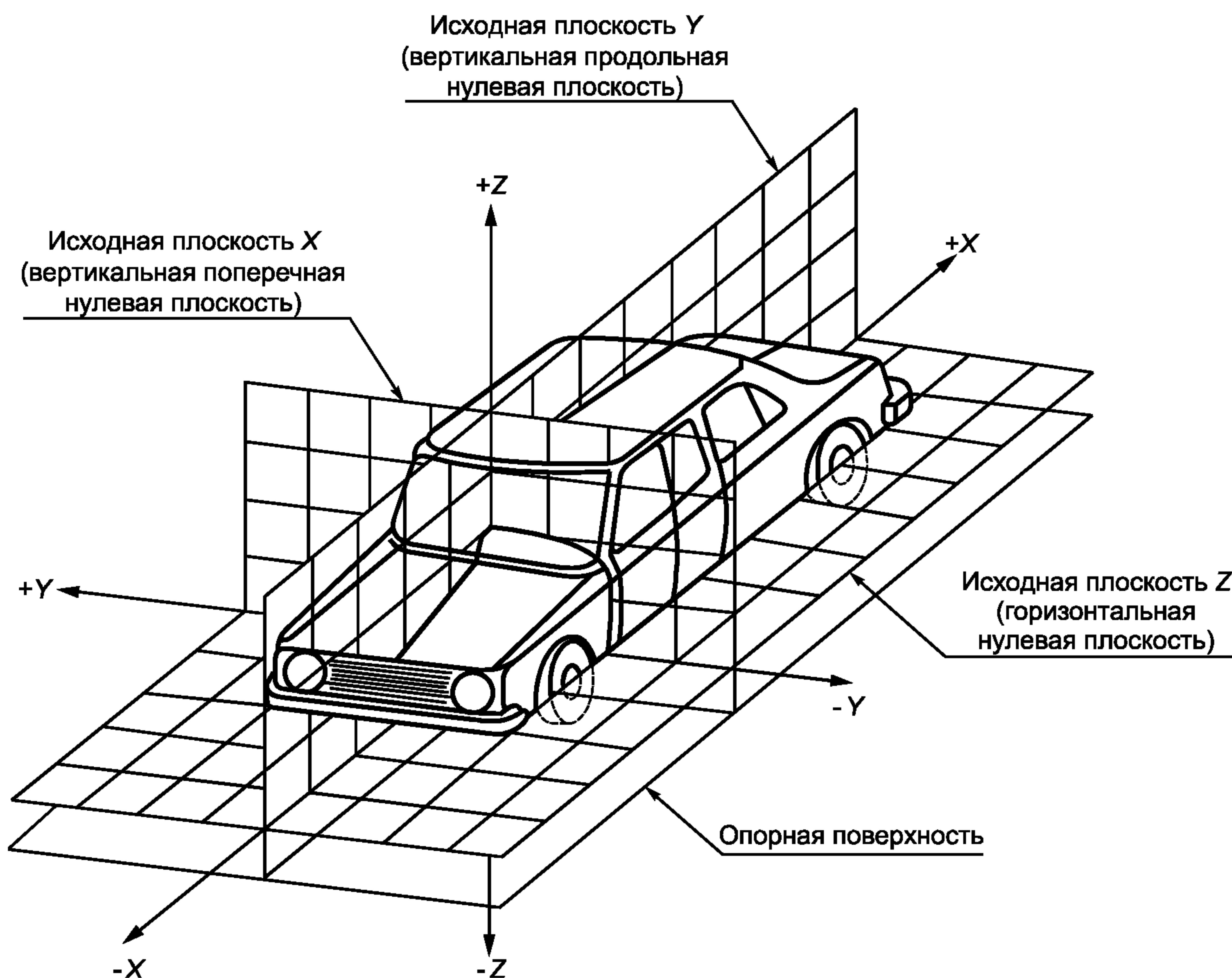
Рисунок 4.3 — Трехмерная система координат
