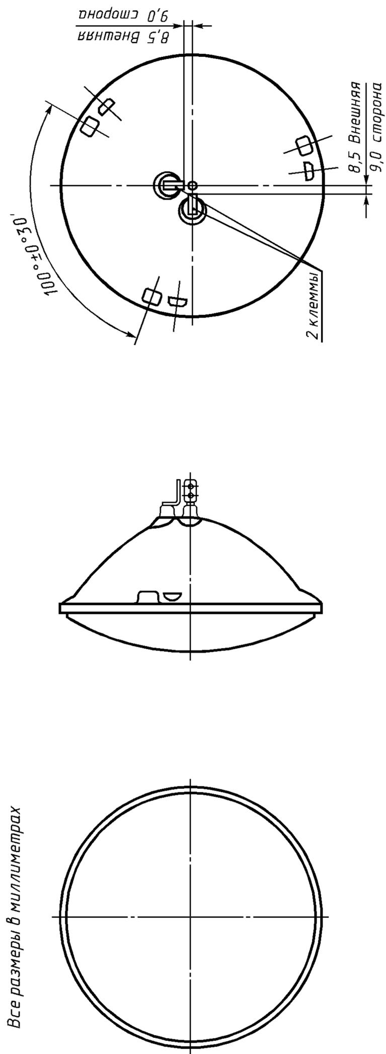
Примечание - Те же обозначения, как и на рисунке SB5 – Лампа-фара "Sealed Beam" диаметром 145 мм, за исключением указанных.
