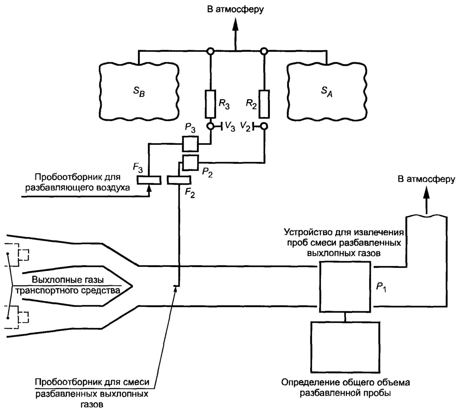
$S_A$  — сборная камера для смеси разбавленных выхлопных газов;  $S_B$  — сборная камера для разбавляющего воздуха;  $R_2, R_3$  — расходомеры с регуляторами расхода  $V_2, V_3$ ;  $P_2, P_3$  — насосы;  $F_2, F_3$  — фильтры
