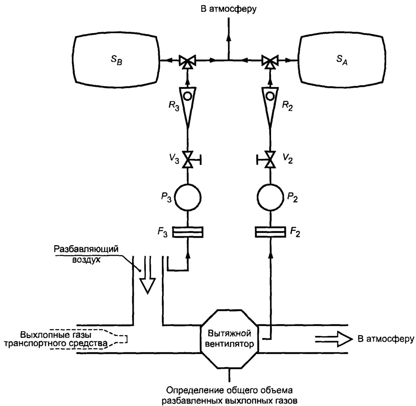
$S_A, S_B$  — камеры;  $R_2, R_3$  — расходомеры;  $V_2, V_3$  — регуляторы расхода;  $P_2, P_3$  — насосы;
