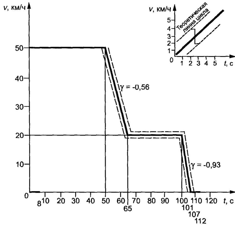
— допуски на скорость ( $\pm 1$  км/ч) и на время ( $\pm 0,5$  с) объединены геометрически для каждой общей точки, как показано на графике справа.
