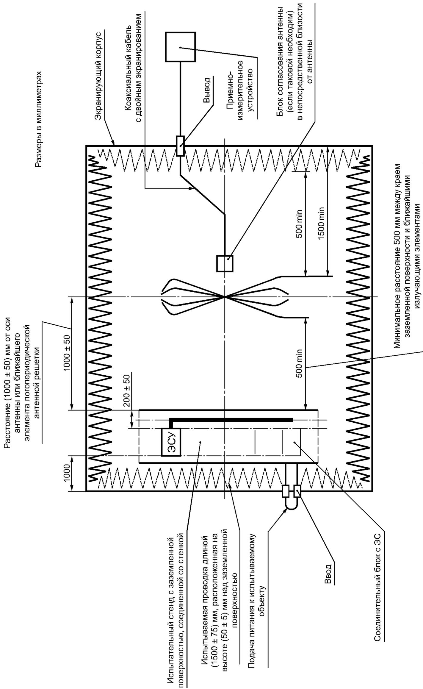
Рисунок 1 — Испытание на устойчивость ЭСУ в условиях свободного поля. Испытательная камера. Общий вид сверху
