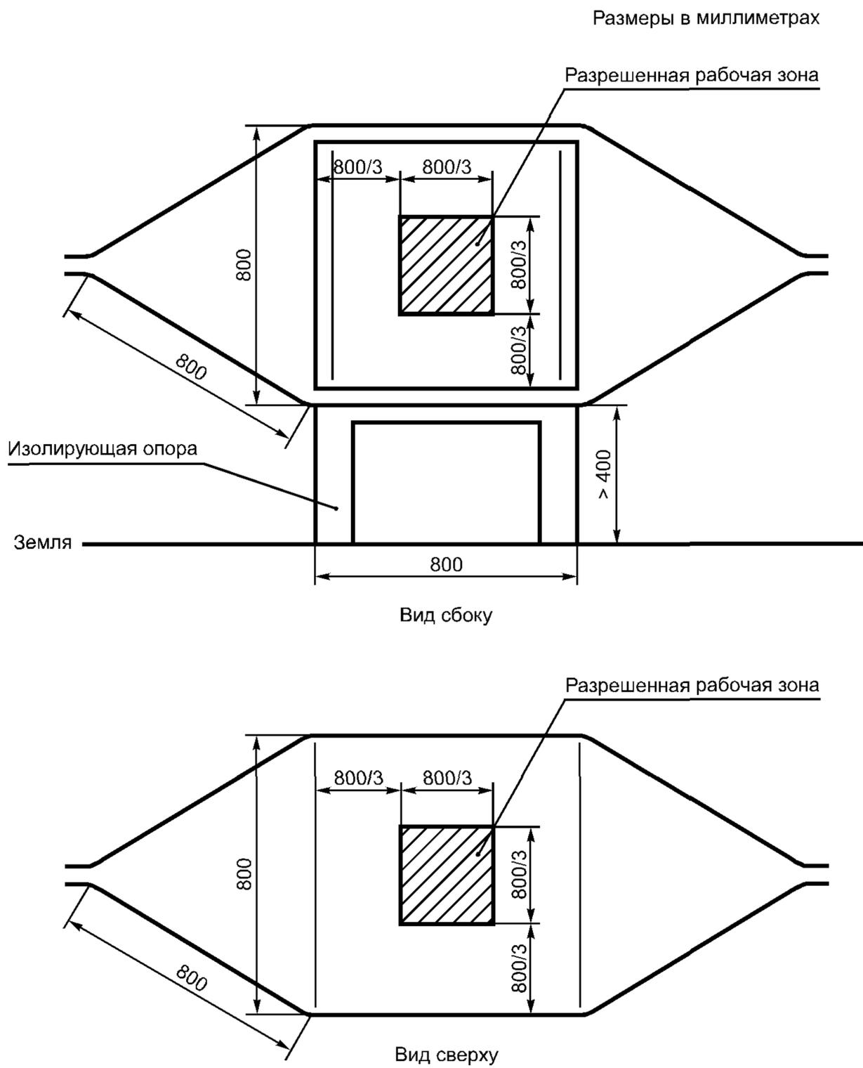
Рисунок 4 – Размеры для 800-миллиметровой полосковой системы
