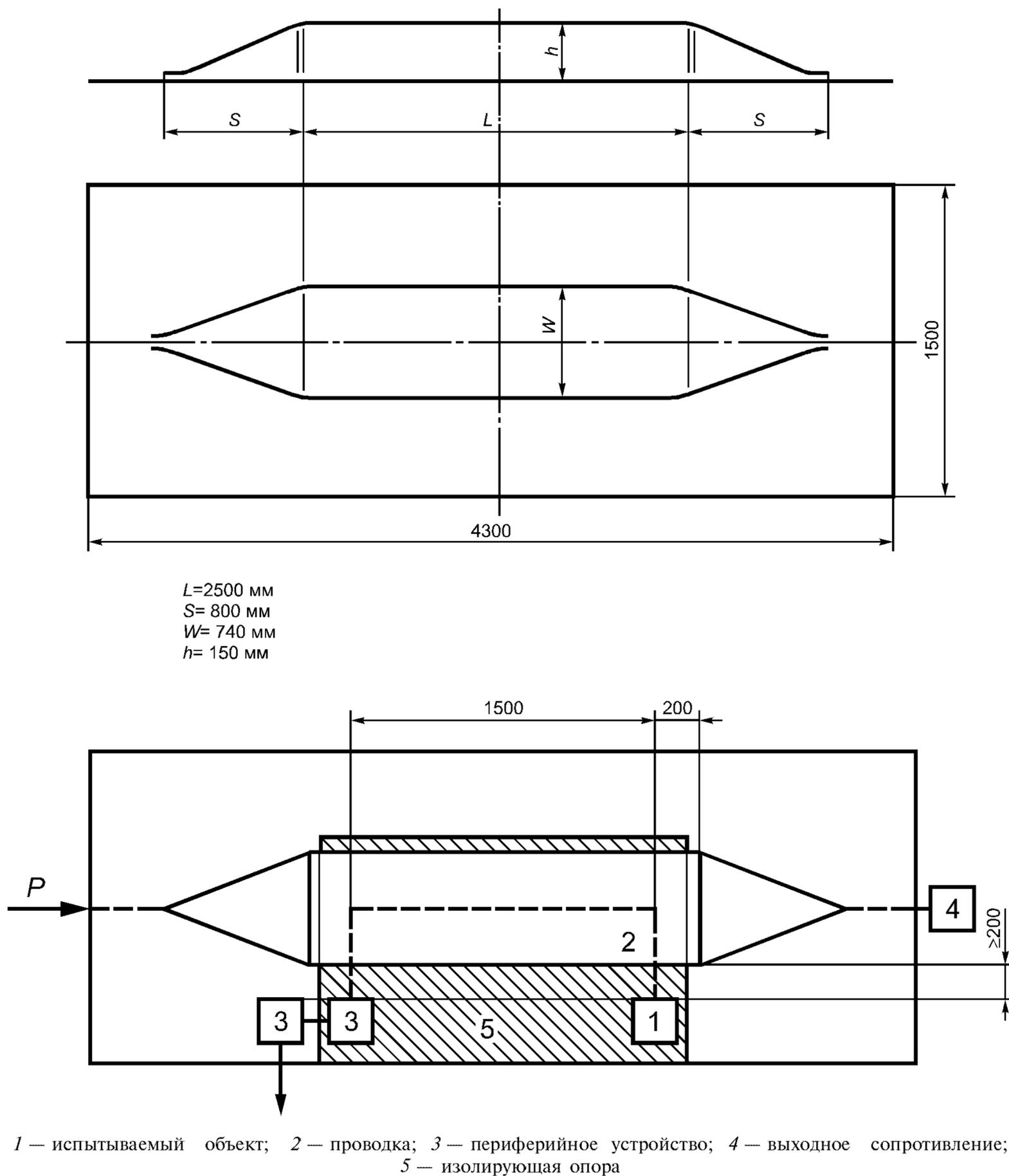
Рисунок 2 – Испытание в 150-миллиметровой полосковой системе
