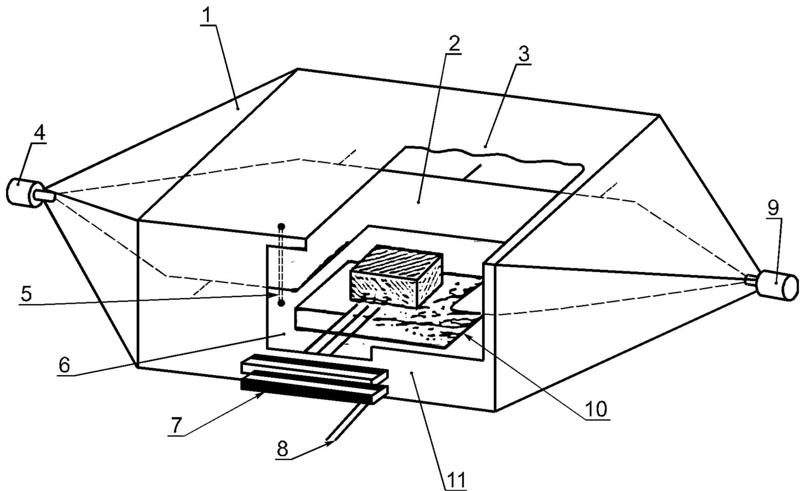
1 — внешний проводник (экран); 2 — внутренний проводник (перегородка); 3 — изолятор; 4 — ввод; 5 — изолятор; 6 — дверь; 7 — коммутационная панель; 8 — подача питания к испытываемому объекту; 9 — выходное сопротивление 50 Ом; 10 — изоляция; 11 — испытываемый объект (максимальная высота — одна треть расстояния между полом камеры и переборкой)
