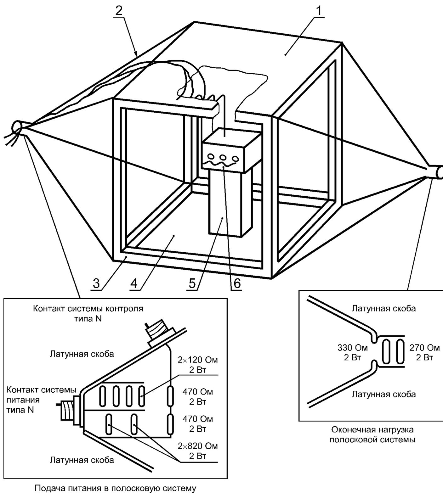
1 — заземленная поверхность; 2 — основной пучок и кабели соединения с датчиками/выключателями; 3 — деревянный каркас; 4 — токопроводящая пластина; 5 — изолятор; 6 — испытываемый объект
