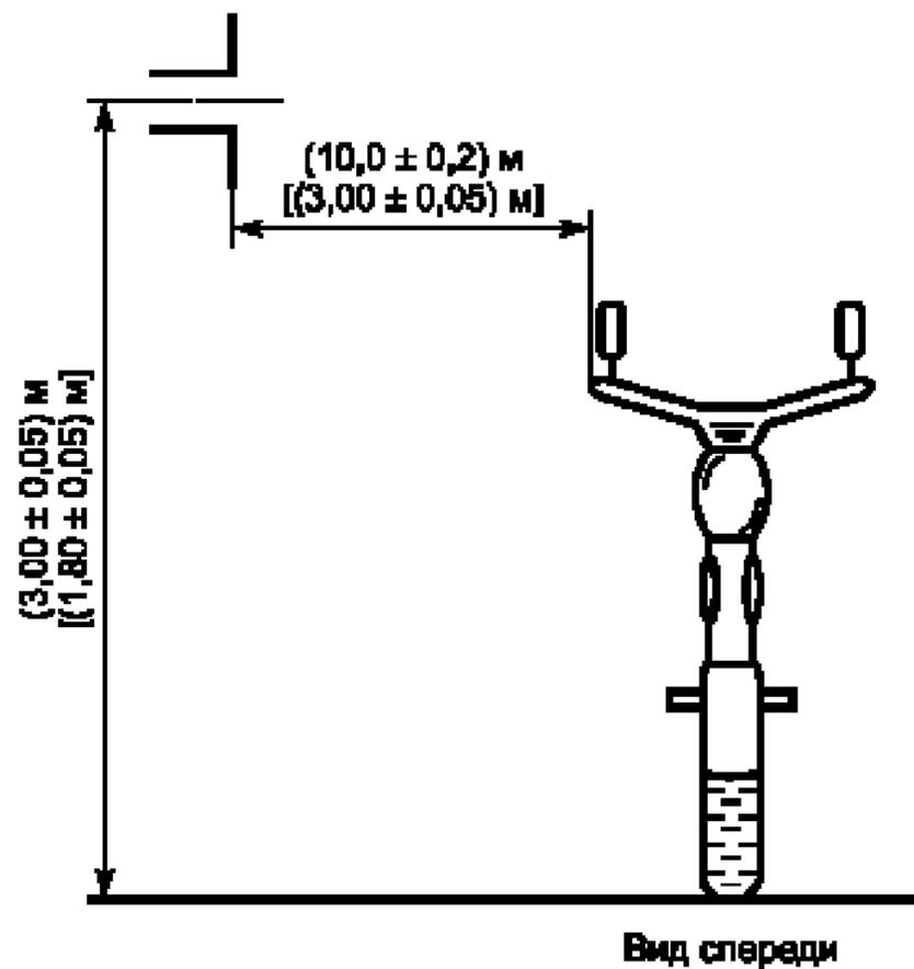
Дипольная антенна в положении для измерения горизонтальной составляющей излучения
