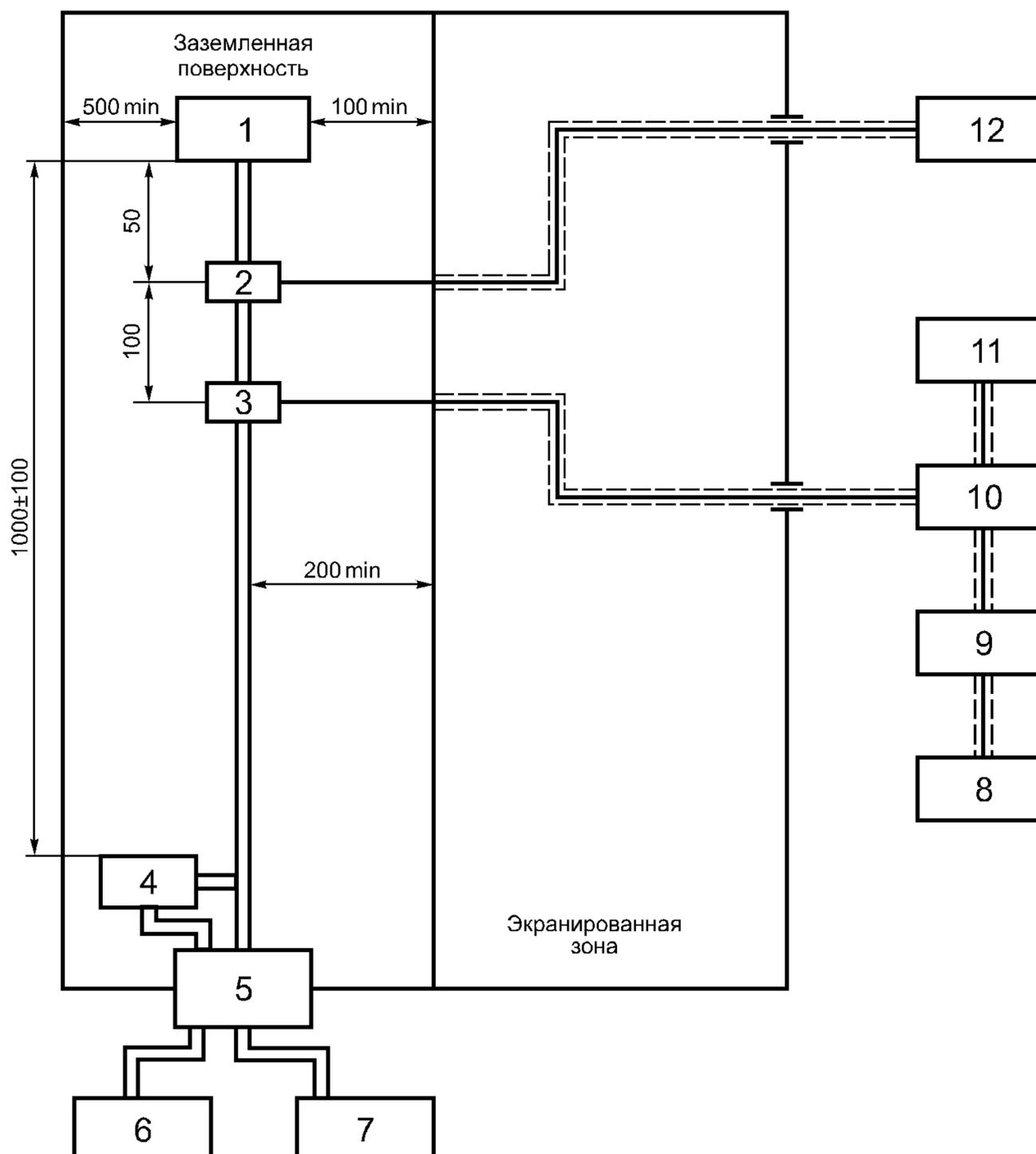
1 — ЭСУ; 2 — измеритель ВЧ тока (факультативно); 3 — инжектор ВЧ тока; 4 — эквивалентная схема; 5 — фильтрующая сеть экранированной камеры; 6 — источник питания; 7 — блок взаимодействия с ЭСУ: имитационная и контрольная системы; 8 — генератор ВЧ сигналов; 9 — широкополосный усилитель; 10 — направленный ответвитель (ВЧ, 50 Ом); 11 — ВЧ или эквивалентная измерительная система; 12 — спектроанализатор или эквивалентное устройство (факультативно)
