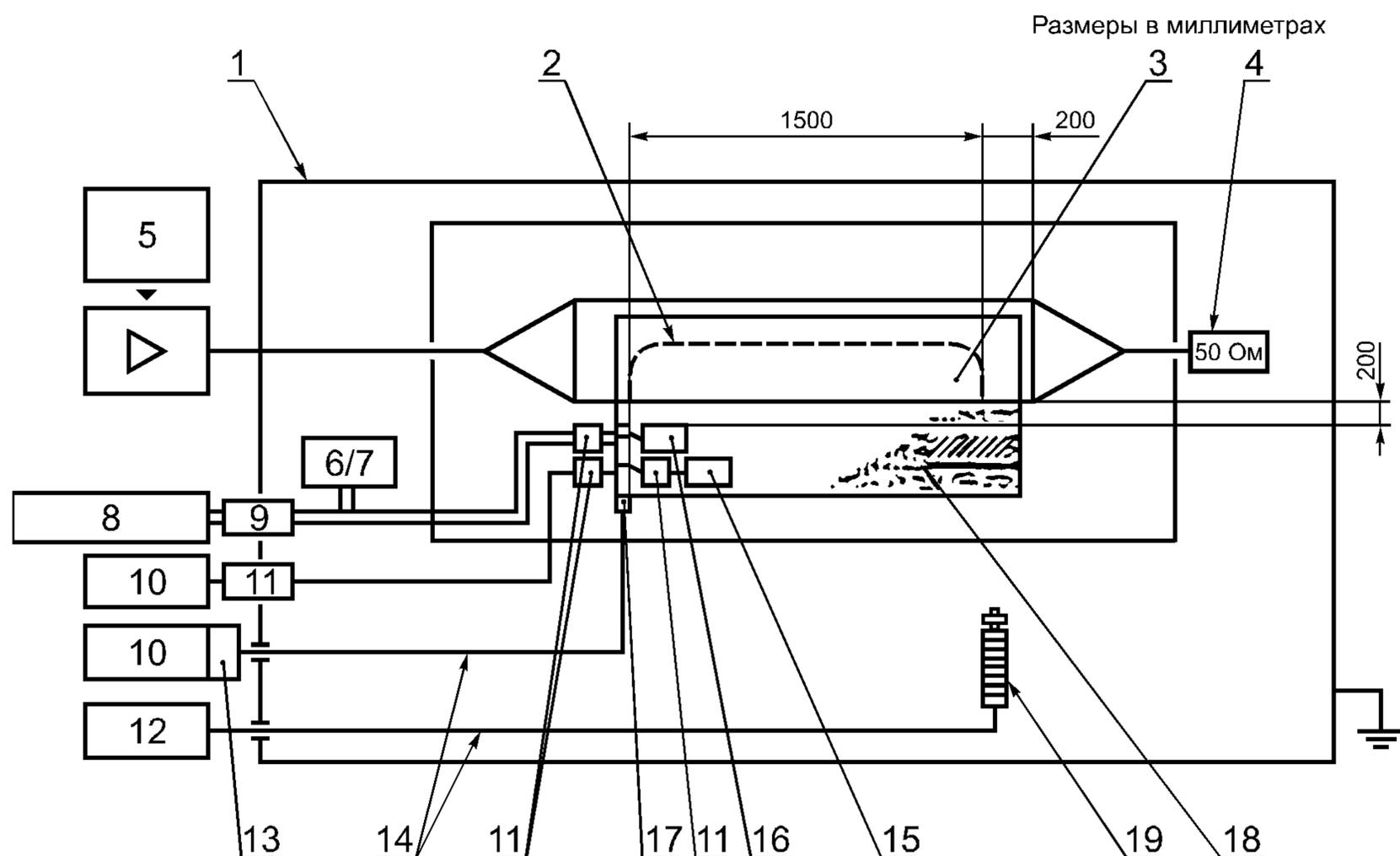
1 — испытательная камера; 2 — проводка; 3 — испытываемый объект; 4 — выходное сопротивление; 5 — генератор частоты; 6/7 — резервный аккумулятор; 8 — источник питания; 9 — фильтр; 10 — периферийное устройство; 11 — фильтр; 12 — периферийный блок видеосистемы; 13 — оптоэлектрический преобразователь; 14 — оптические линии связи; 15 — неэкранированное периферийное устройство; 16 — экранированное периферийное устройство; 17 — оптоэлектрический преобразователь; 18 — изолирующая опора; 19 — видеокамера
