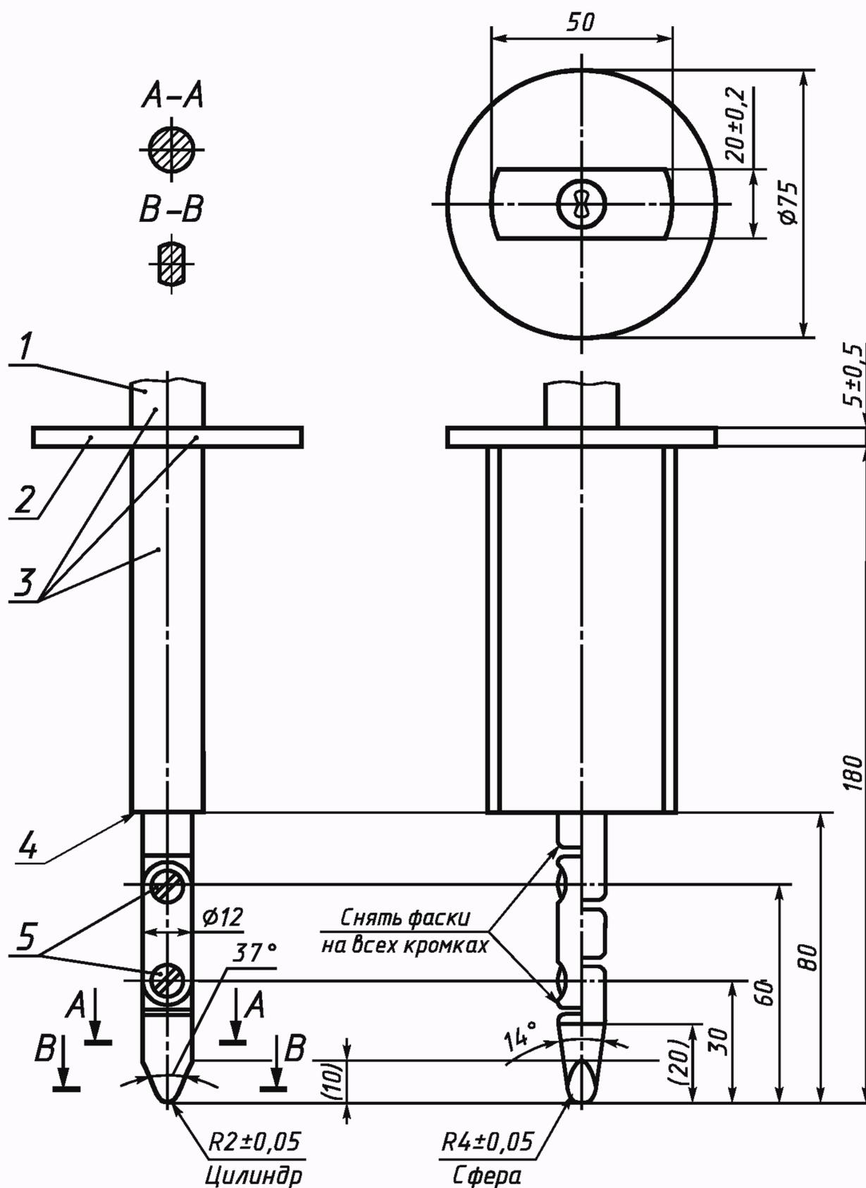
1 — рукоятка; 2 — ограждение; 3 — изоляционный материал; 4 — ограничительный элемент; 5 — шарниры
