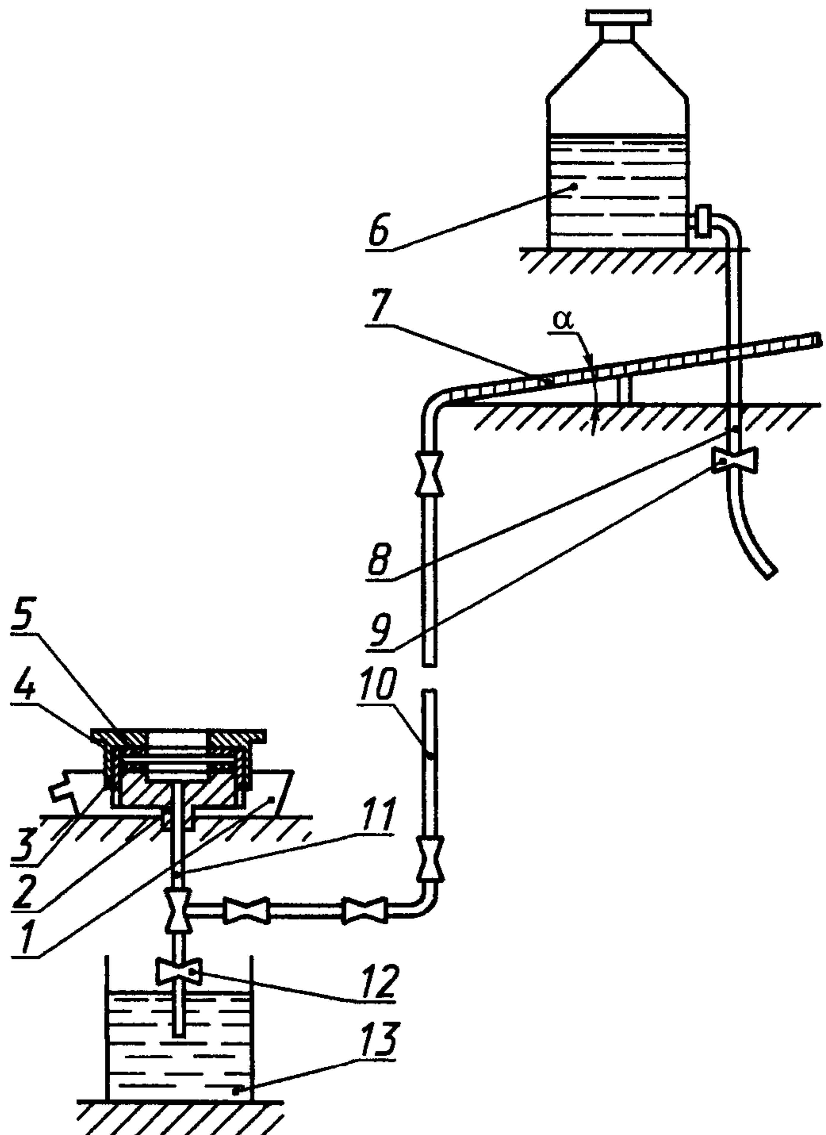
1 — ванна; 2 — полая камера; 3 — крышка; 4 — резиновая уплотняющая прокладка; 5 — металлическая прокладка; 6 — сосуд с тубусом для воды; 7 — стеклянная градуированная трубка; 8, 11 — резиновые трубы; 9, 12 — зажимы на трубках; 10 — стеклянная трубка; 13 — бачок для слива воды
