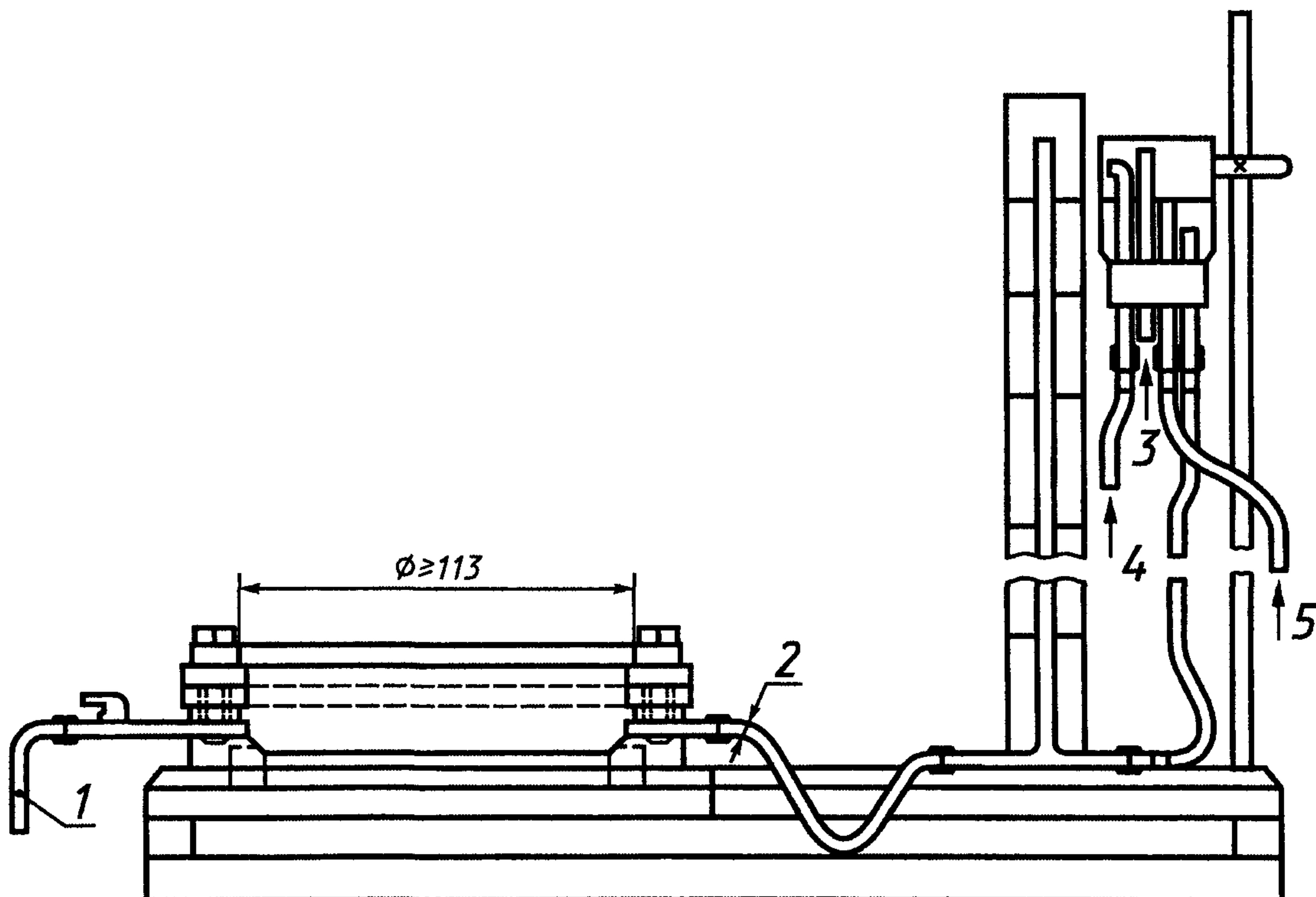
1 — выпуск воздуха; 2 — трубка внутренним диаметром не менее 6 мм; 3 — выпуск воздуха; 4 — выпуск воды; 5 — выпуск воды
