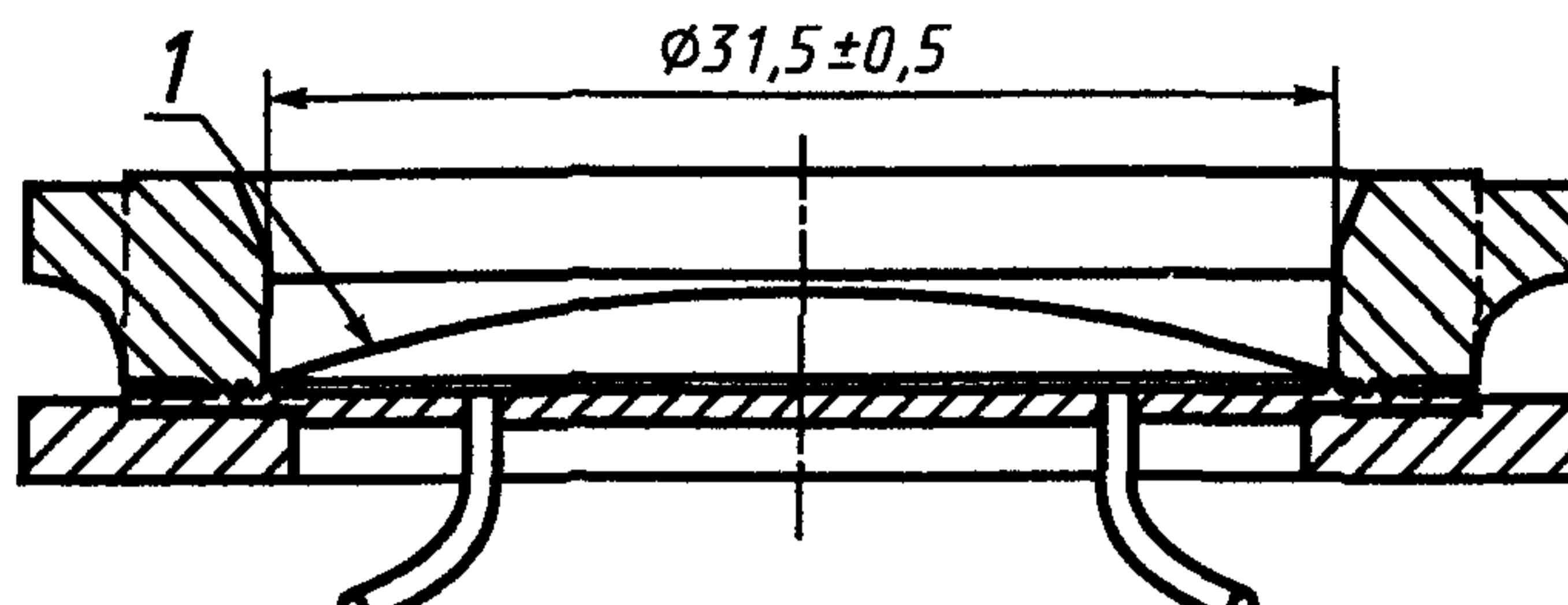
1 — образец для испытания
