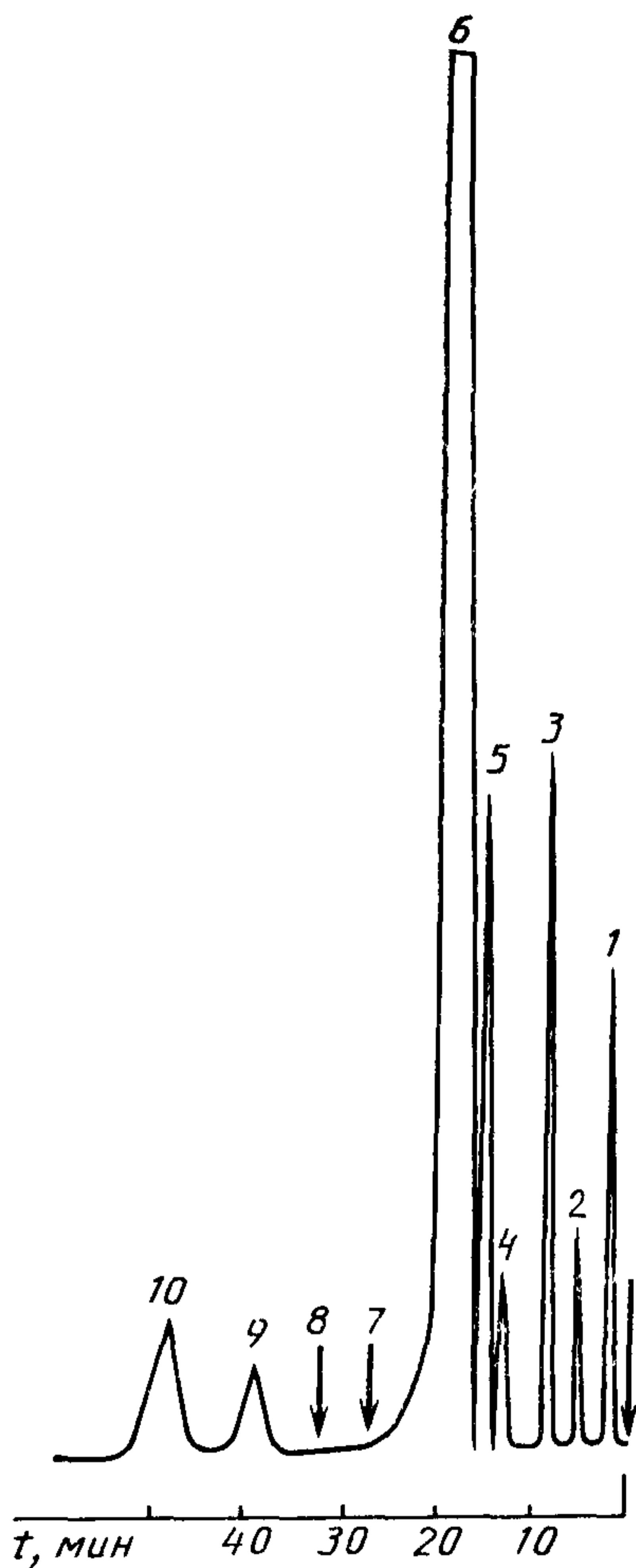
**1 — хлористый метил; 2 — хлористый этил; 3 — винилиденхлорид; 4 — хлористый аллил; 5 — транс-дихлорэтилен; 6 — хлористый метилен; 7 — четыреххлористый углерод; 8 — цис-дихлорэтилен; 9 — хлороформ; 10 — трихлорэтилен**
