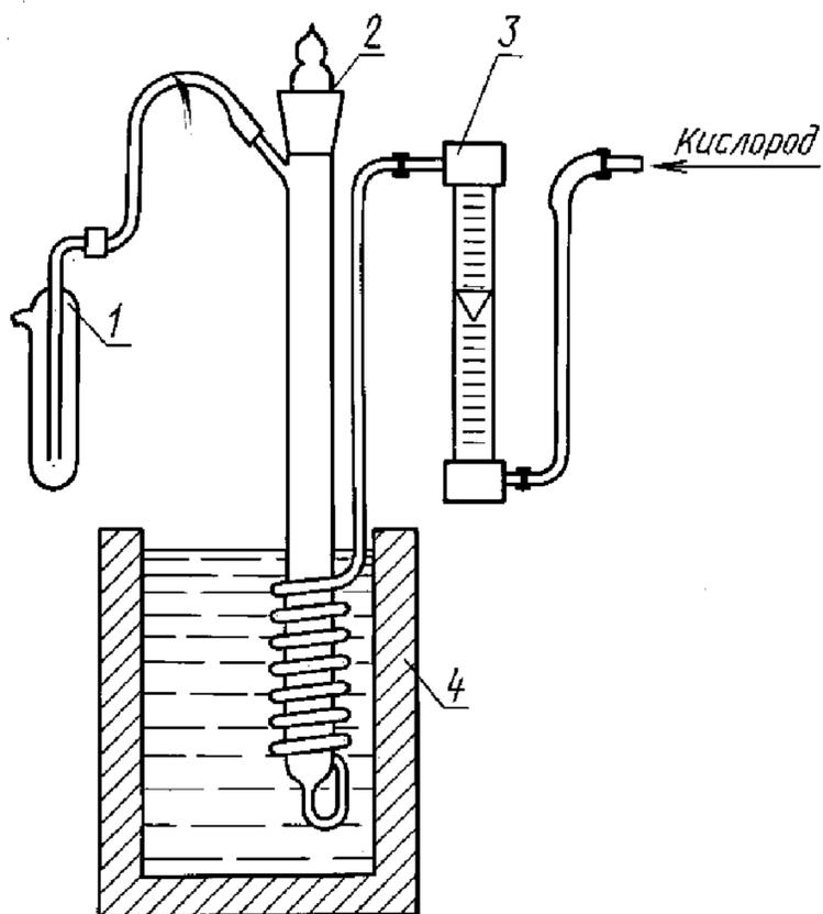
1 — ловушка; 2 — прибор ВТИ для окисления нефтяных масел; 3 — реометр или ротаметр; 4 — масляная баня
