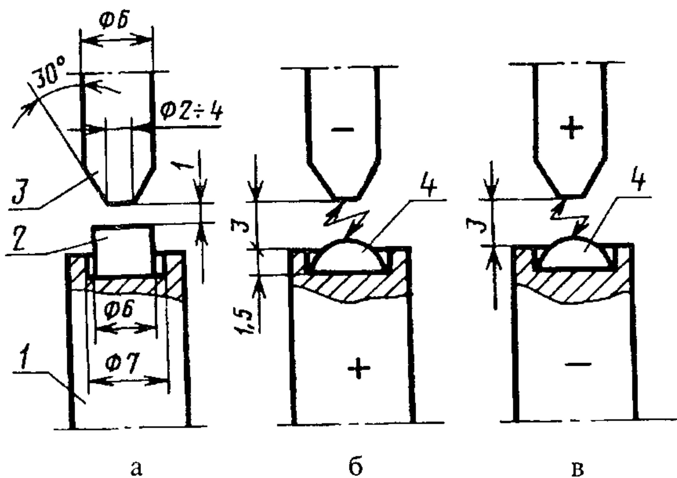
*a*—расположение электродов и брикета до экспонирования; *б*—съемка в анодном режиме; *в*—съемка в катодном режиме; 1—графитовая подставка; 2—брикет, 3—подставной электрод; 4—расплав
