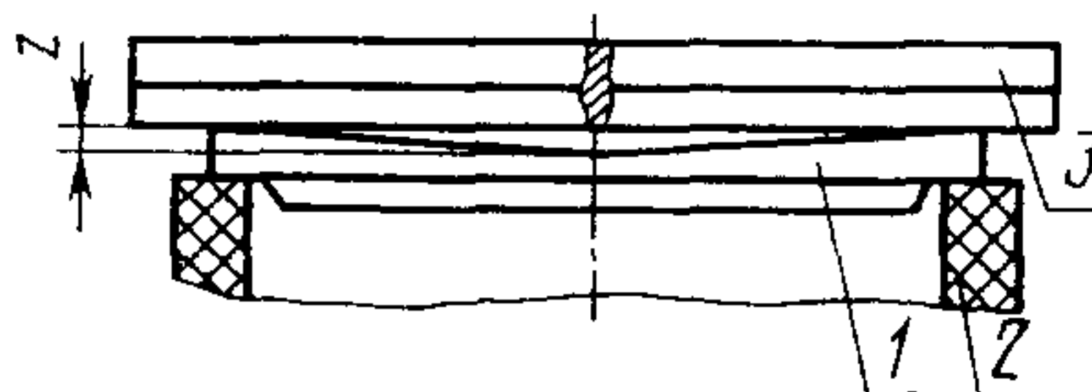
1—линза; 2—кольцевое гнездо; 3—поверочная линейка
