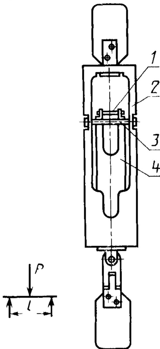
Нижняя деталь состоит из круглого стержня с двумя стойками 4, между которыми укреплен изгибающий валик 1. Изгибающий валик, также как и опорные, свободно вращается вокруг своей оси.
