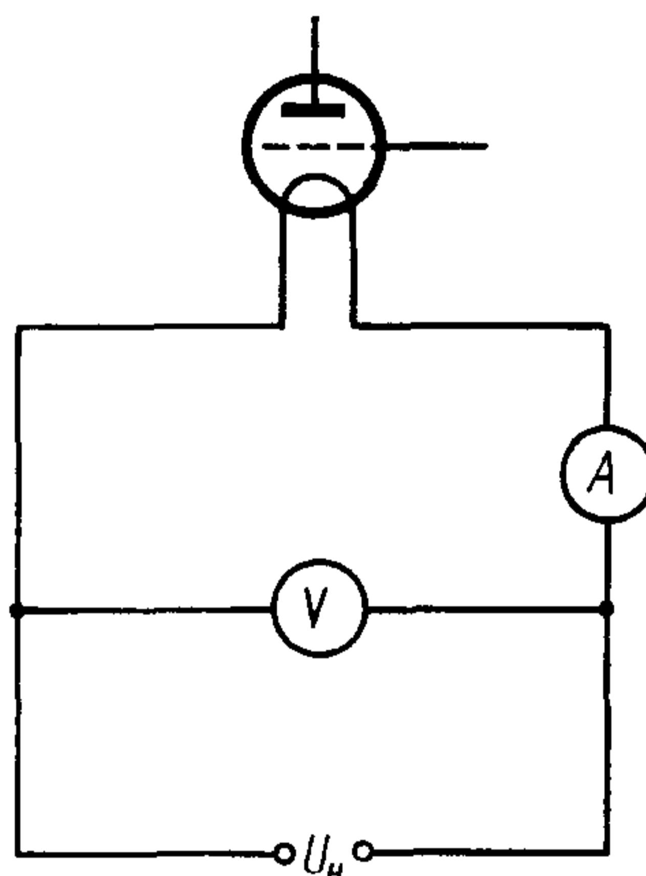
$U_H$  — источник постоянного напряжения накала,
