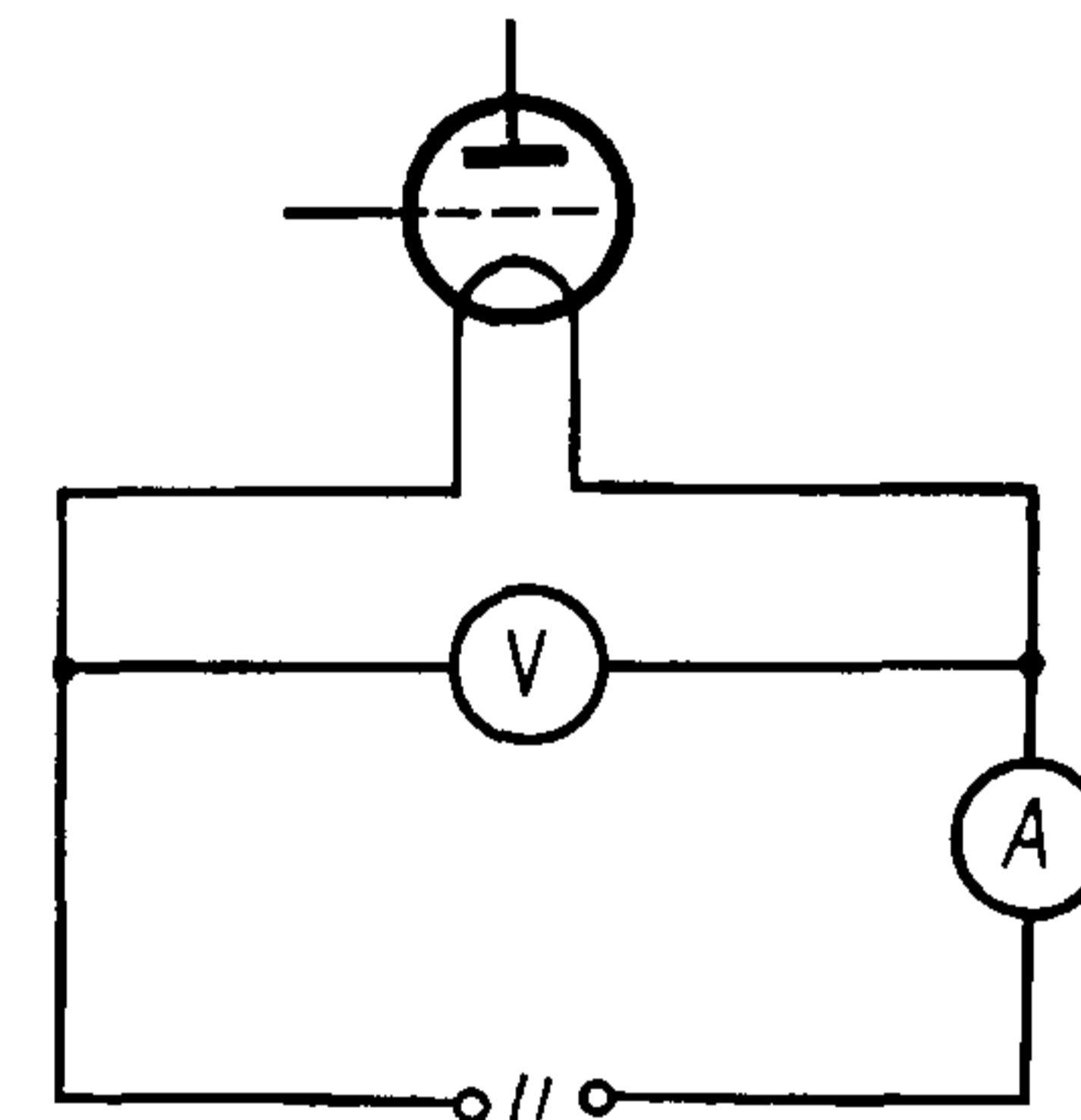
Допускается производить измерение тока накала по схеме, приведенной на черт. 2.
