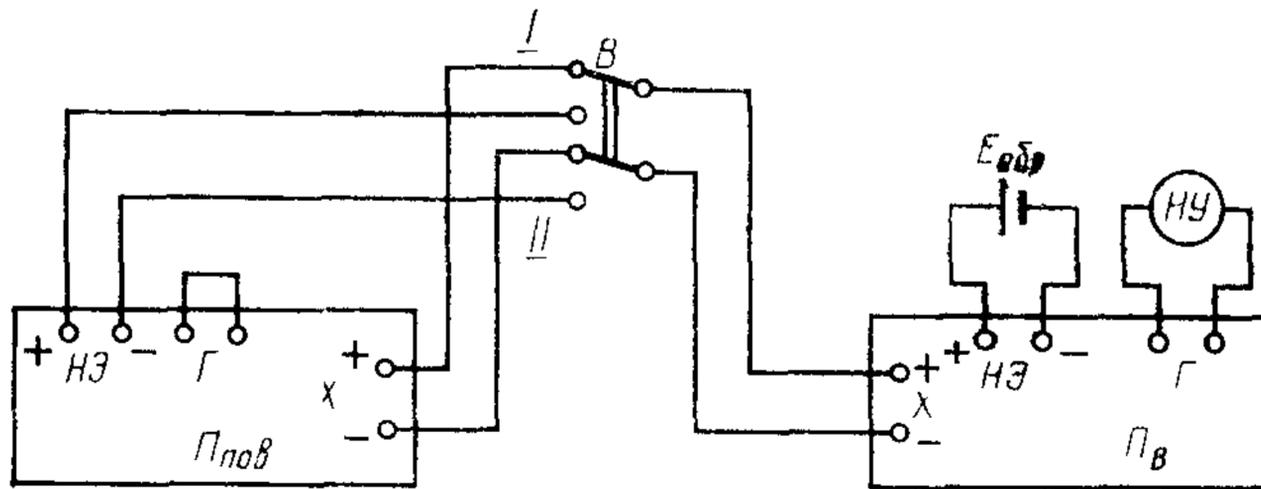
$P_{пов}$  — поверяемый потенциометр,  $P_{в}$  — вспомогательный потенциометр,  $E_{обр}$  — образцовая мера э. д. с.,  $НУ$  — нулевой указатель равновесия;  $B$  — двухполюсный переключатель,  $Х$  — измерительные зажимы потенциометра,  $НЭ$  — зажимы потенциометра для подключения нормального элемента,  $I$  — зажимы потенциометра для подключения нулевого указателя равновесия
