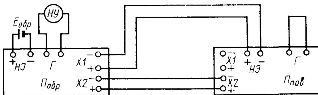
$\Pi_{обр}$  — образцовый потенциометр;  $\Pi_{пов}$  — проверяемый потенциометр;  $E_{обр}$  — образцовая мера эдс,  $НУ$  — нулевой указатель равновесия,  $X1$ ,  $X2$  — измерительные зажимы потенциометра  $НЭ$  — зажимы потенциометра для подключения нормального элемента,  $Г$  — зажимы потенциометра для подключения нулевого указателя равновесия
