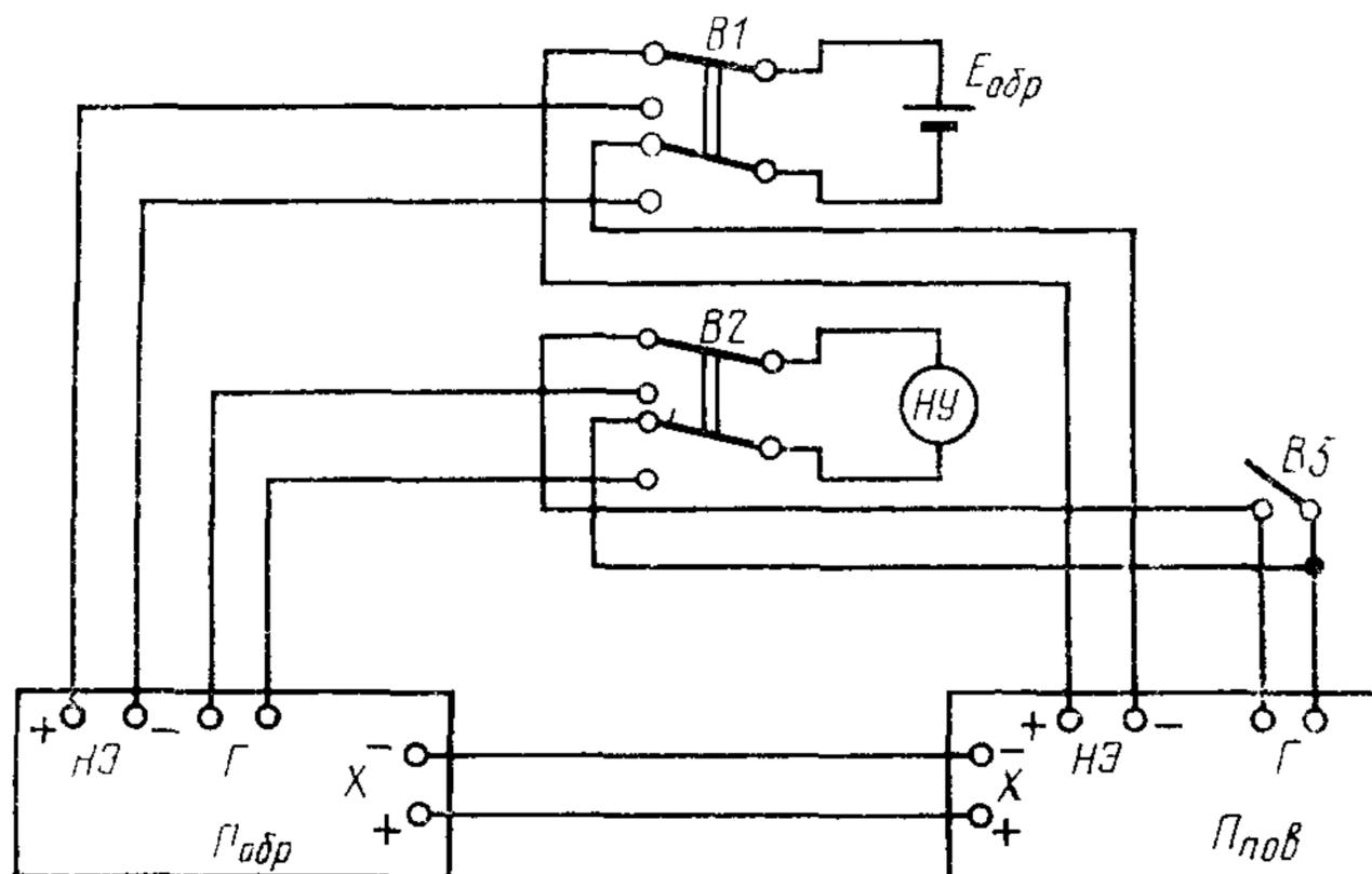
$\Pi_{обр}$ —образцовый потенциометр,  $\Pi_{пов}$ —поверяемый потенциометр,  $E_{обр}$ —образцовая мера эдс; НУ—нулевой указатель равновесия, B1, B2—двухполюсный переключатель, B3—однополюсный переключатель, X—измерительные зажимы потенциометра НЭ—зажимы для подключения нормального элемента, Г—зажимы потенциометра для подключения нулевого указателя равновесия
