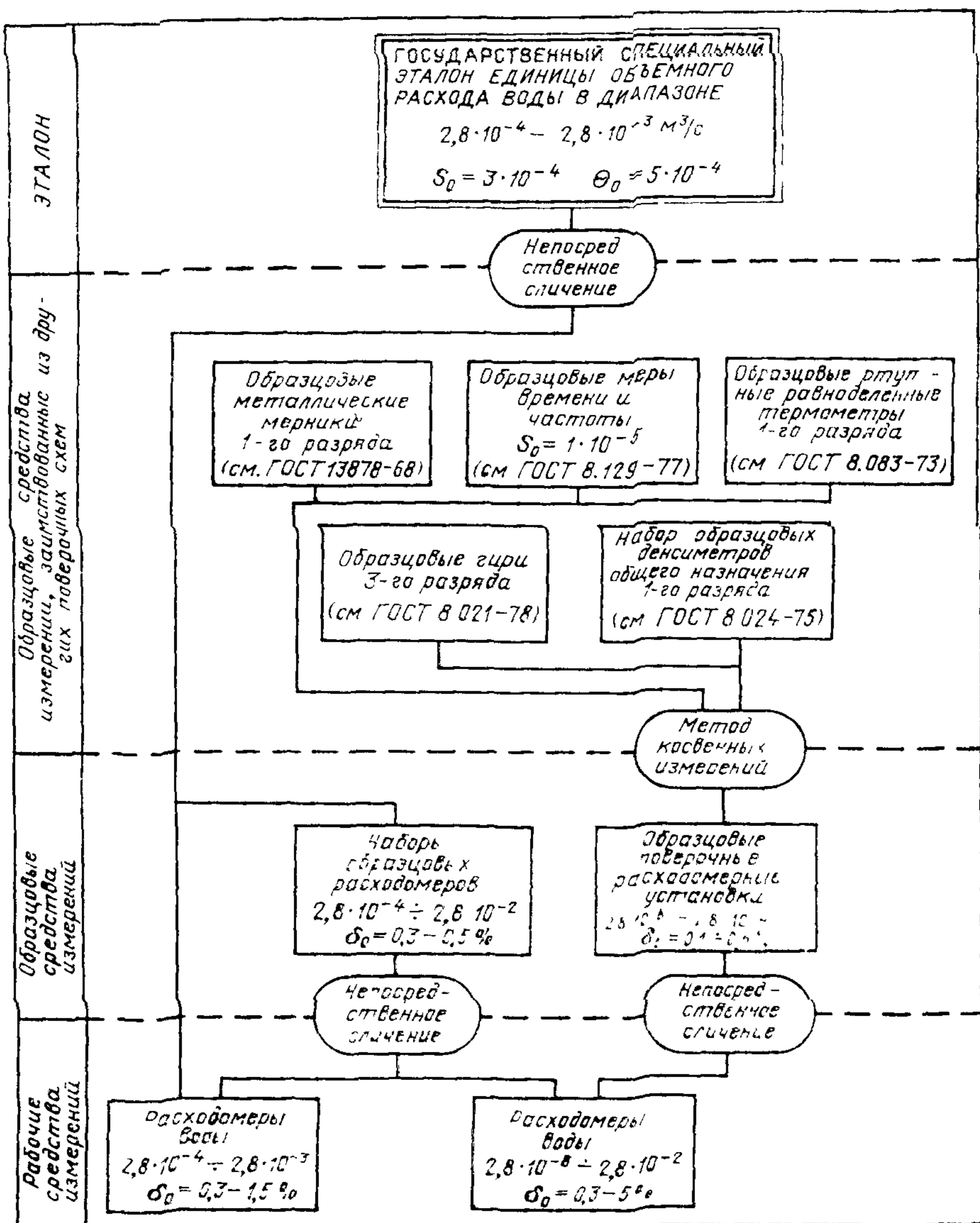
2.2.2. Пределы допускаемых относительных погрешностей ( $\delta_0$ ) образцовых средств измерений составляют от 0,1 до 0,5%.
