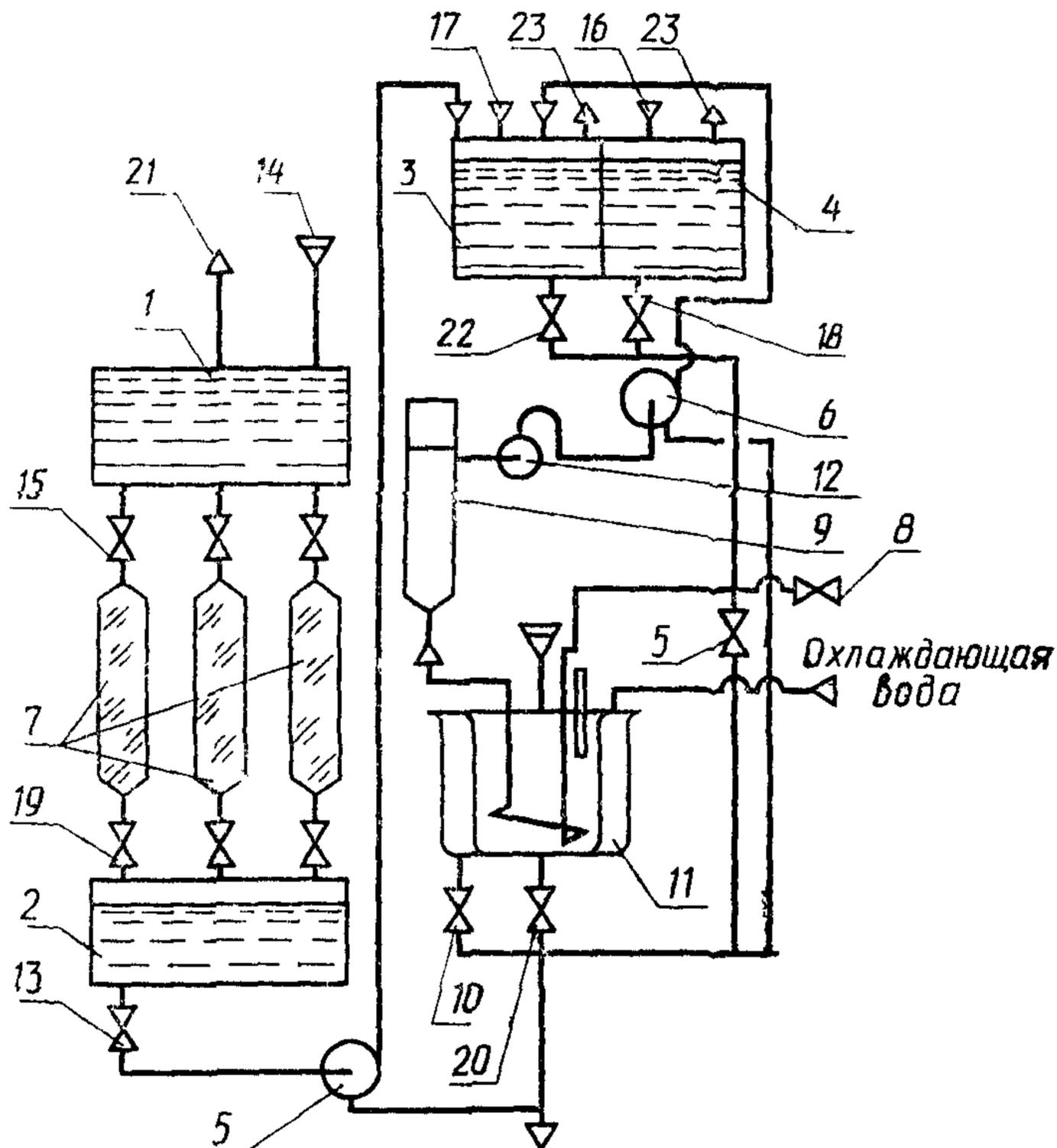
1—4—баки; 5—6—насосы; 7—нонитовые колодки; 8—кран для отбора проб раствора; 9—поверяемый первичный преобразователь; 10, 13, 15, 18, 19, 20, 22—вентили; 11—термостат; 12—термометр сопротивления; 14, 16, 17—воронки для заливки; 21, 23—воронки с натронной известью
