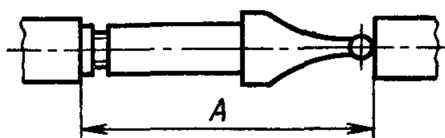
Размер  $A$  следует определять микрометром.
