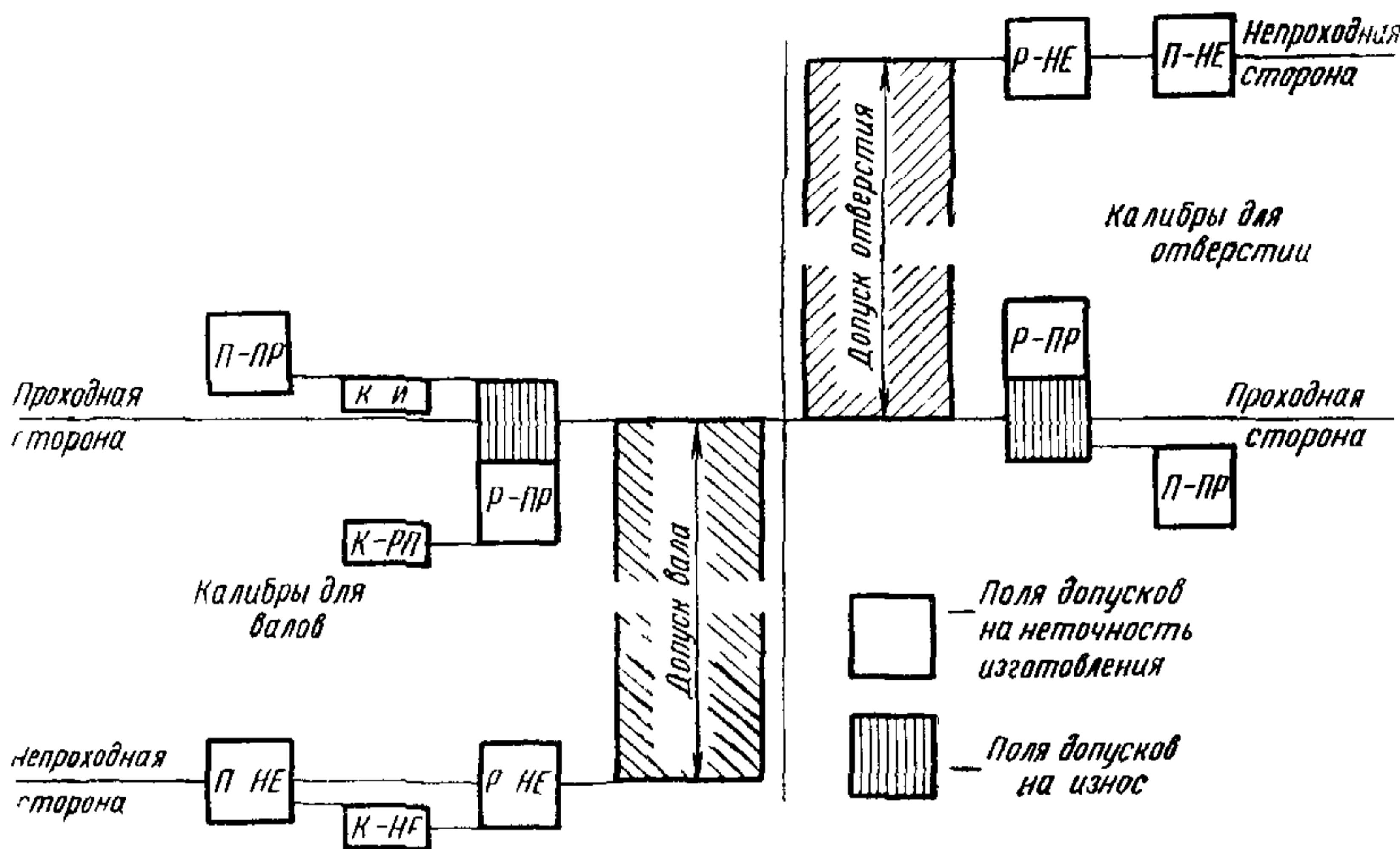
3 Износ непроходных калибров, в случае надобности, может быть ограничен заводскими и ведомственными нормальми.
