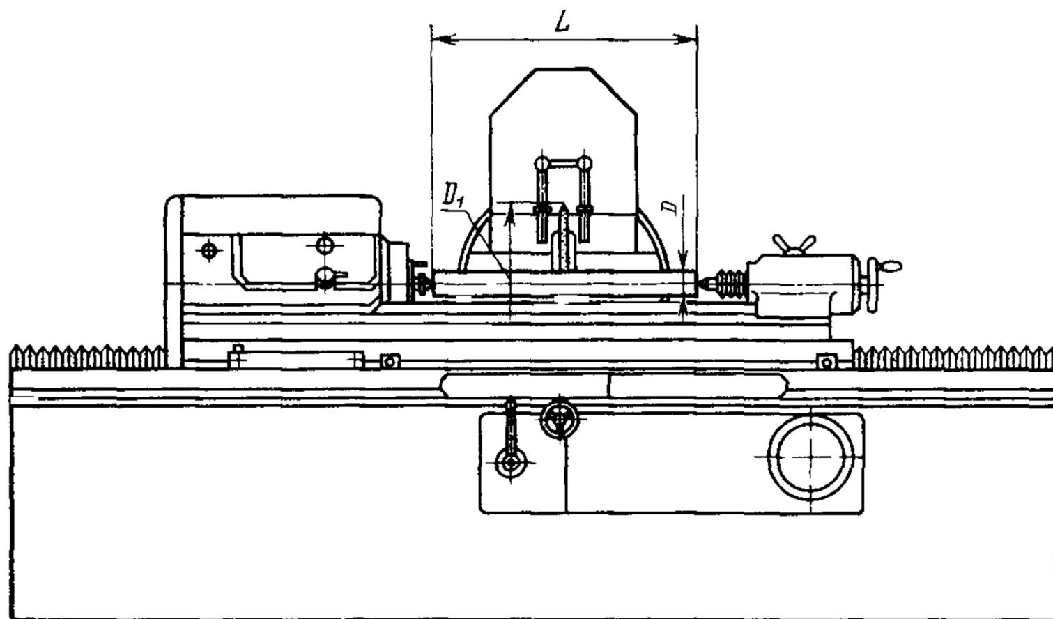
$D$ —наибольший диаметр устанавливаемой заготовки;  $L$ —наибольшая длина устанавливаемой заготовки;  $D_1$ —наибольший диаметр устанавливаемого шлифовального круга
