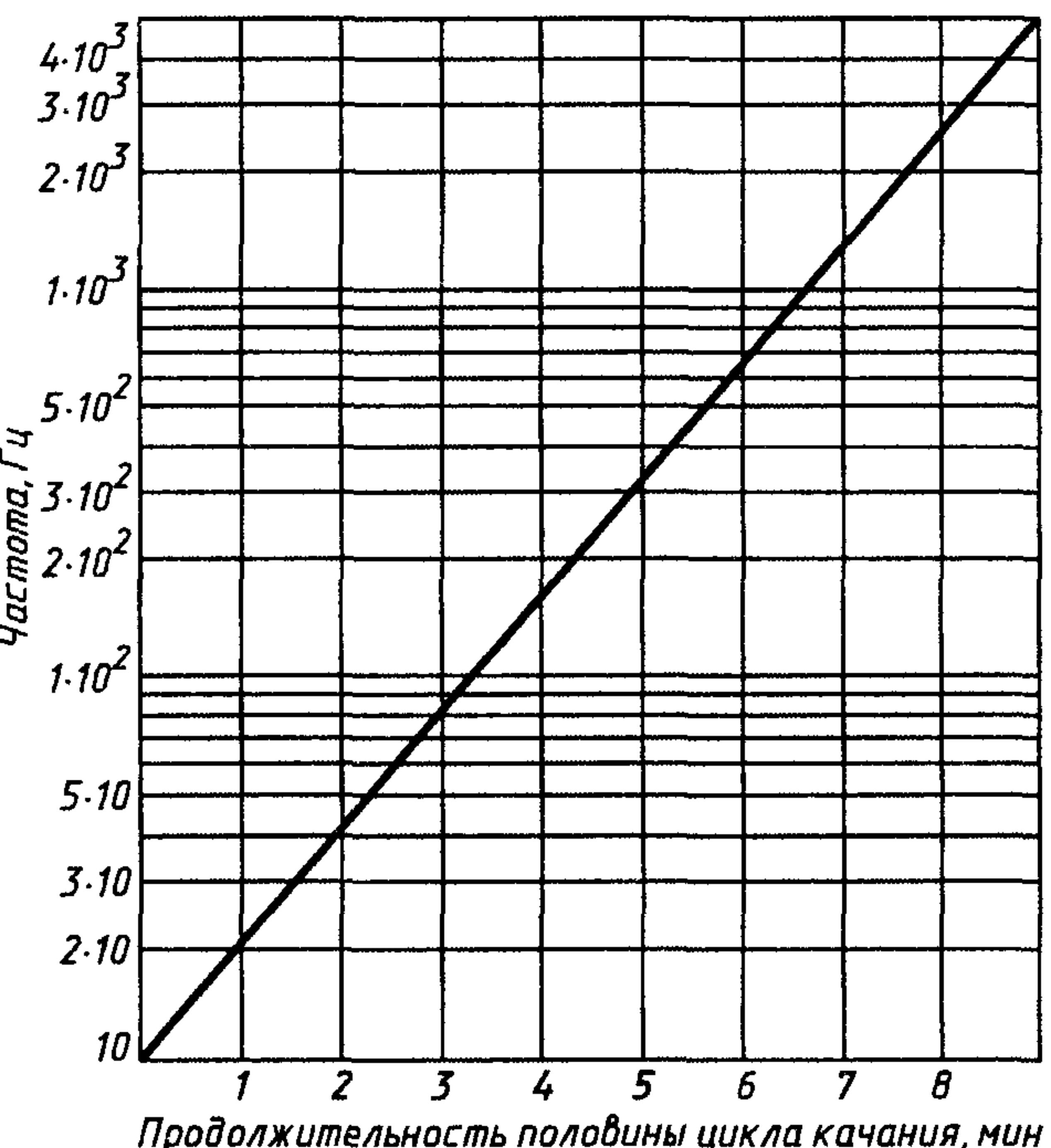
Рисунок 1 — Зависимость продолжительности половины цикла качания от частоты
