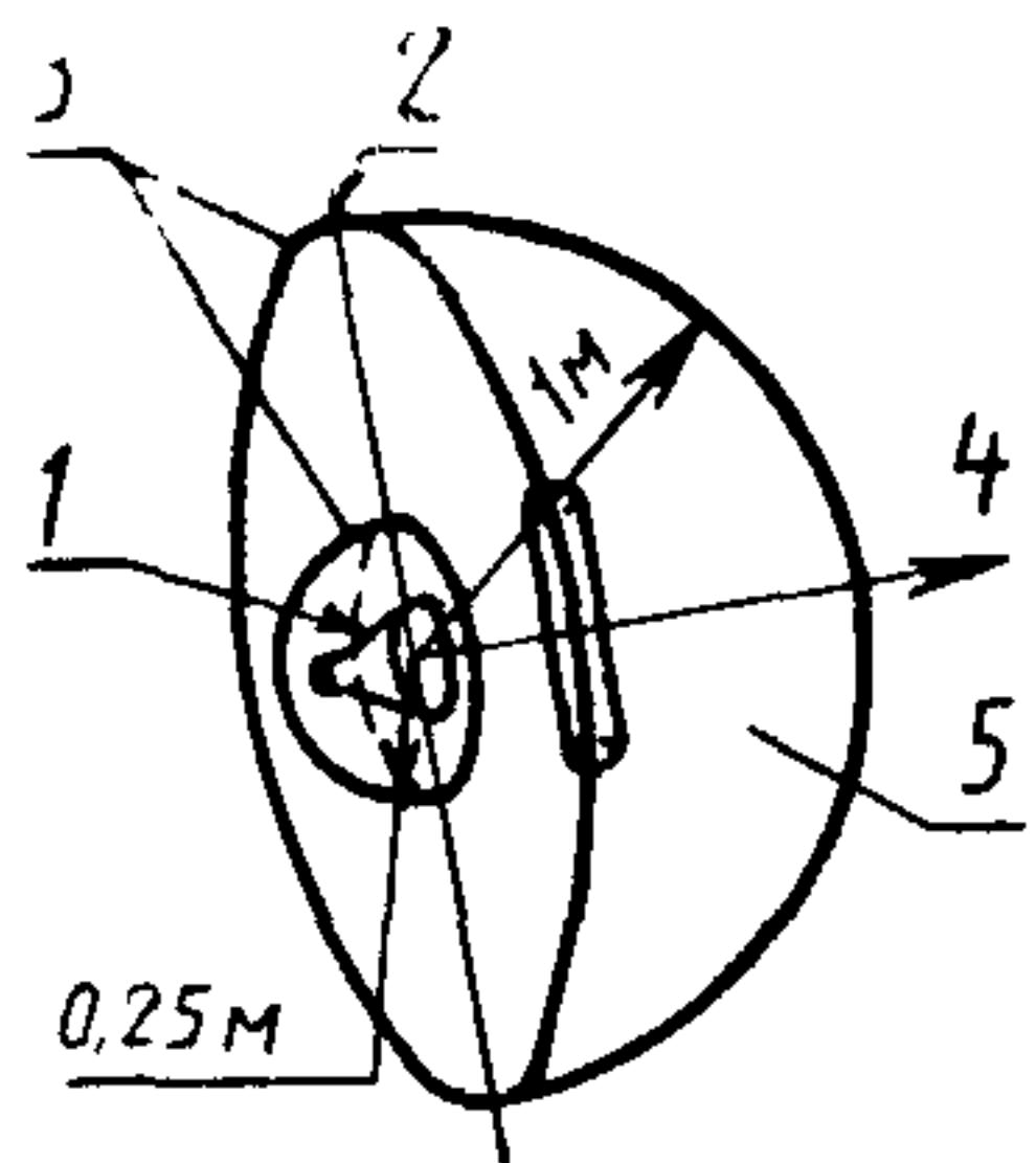
1 — аппликатор; 2 — плоскость раскрытия излучателя; 3 — граница с пределом 10 мВт/см<sup>2</sup>; 4 — направление преднамеренного излучения; 5 — фантом
