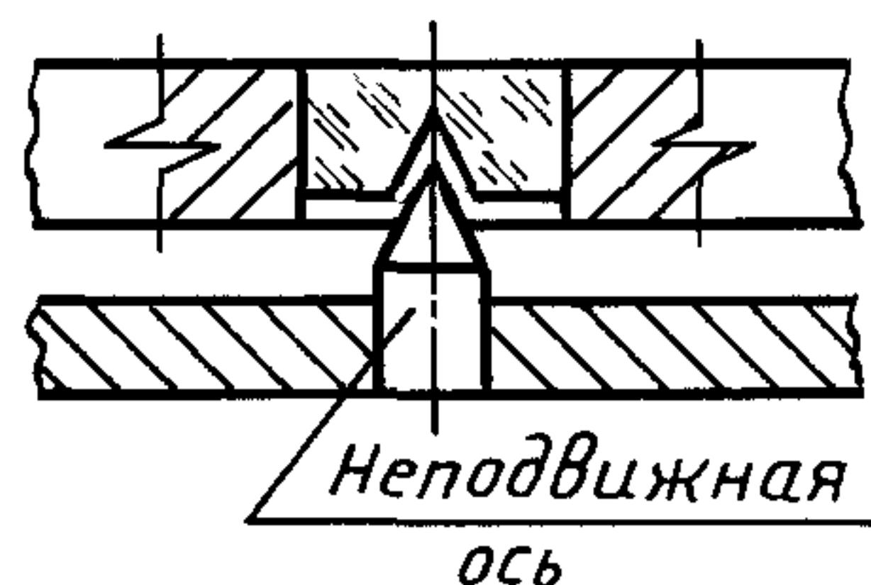
3.4. Камни, предназначенные для передачи силы или движения, или того и другого одновременно, например камни, используемые для поддержания колебательной системы.
