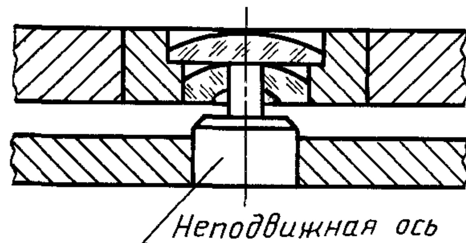
**3.3. Камни с коническими выемками, служащие в качестве радиальных и осевых опор**
