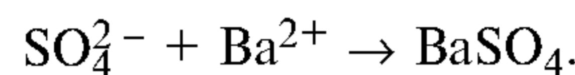
Для устойчивости мути в качестве стабилизатора используют глицерин. Нижняя граница определяемой массовой доли сульфата аммония составляет 0,01 % для 1 г пробы.
