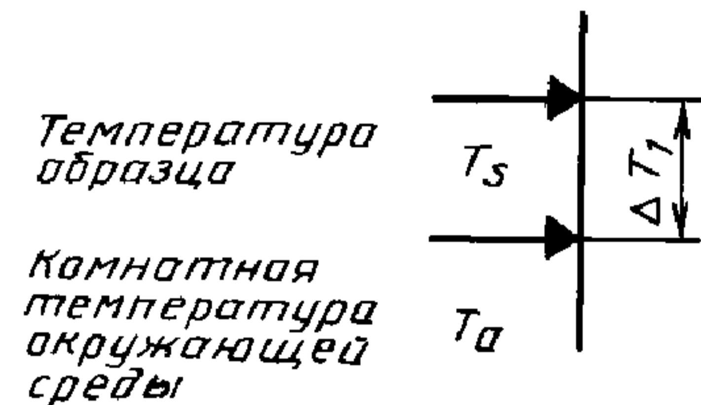
**Стадия 1.** Образец находится под нагрузкой. Испытание в условиях лаборатории без принудительной циркуляции воздуха. Измерение температуры образца.
