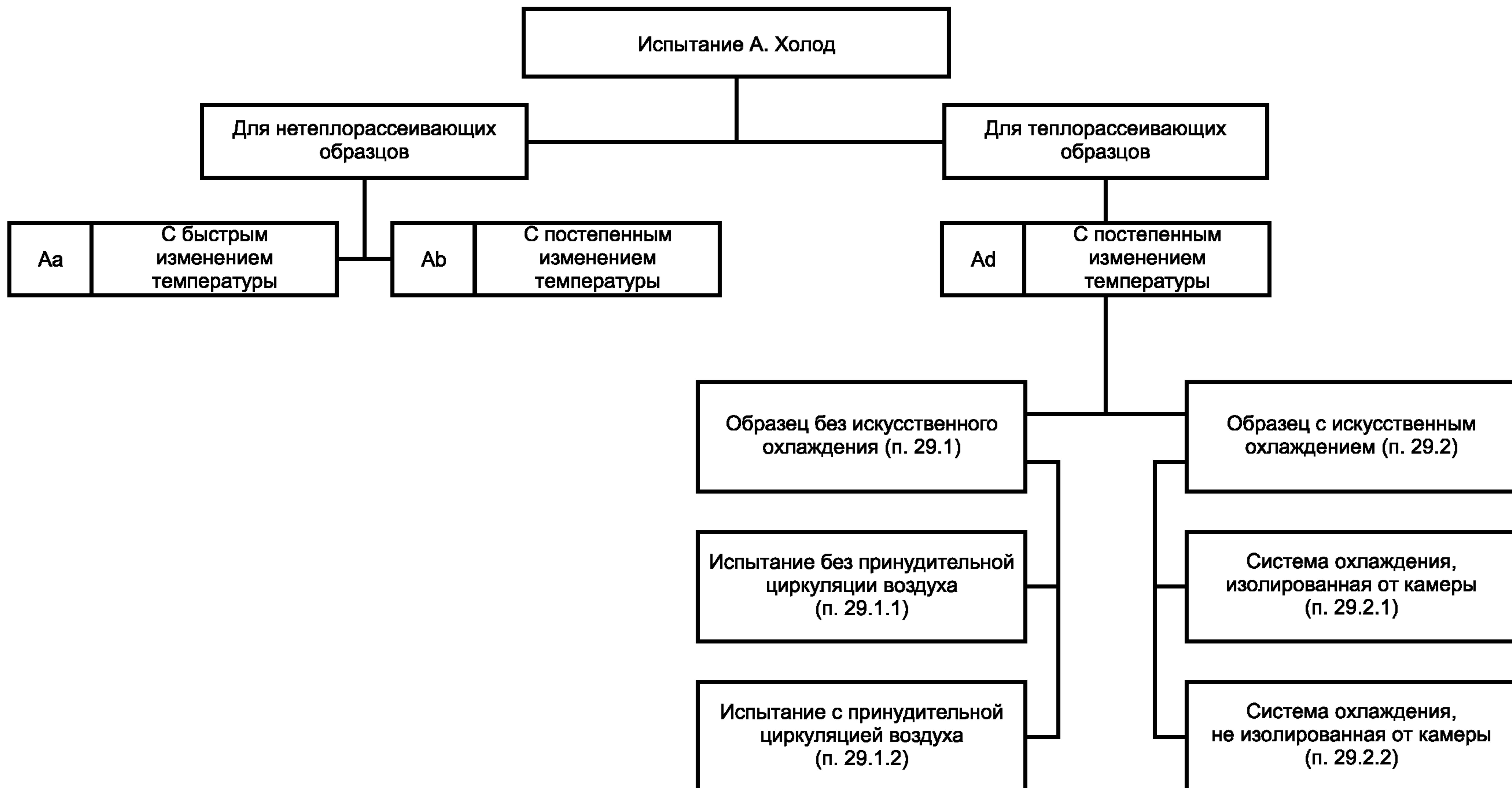
**Блок-схема испытания А: Холод, показывающая идентичность
