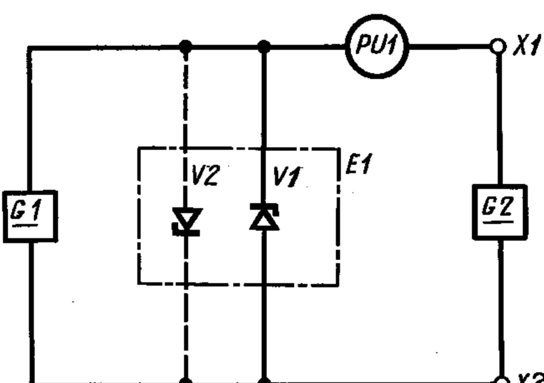
$V_1$  — измеряемый стабилитрон;  $V_2$  — измеряемый стабистор;  $G_1$  — генератор постоянного тока;  $G_2$  — источник опорного напряжения;  $E_1$  — термостатируемый объем;  $X_1$ ,  $X_2$  — клеммы;  $PU_1$  — вольтметр постоянного тока
