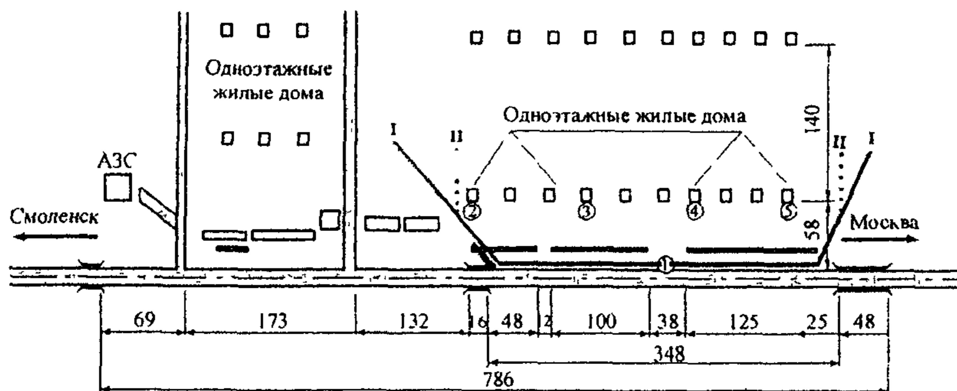
*Рис. 5. Рекомендуемая схема размещения шумозащитного экрана*
