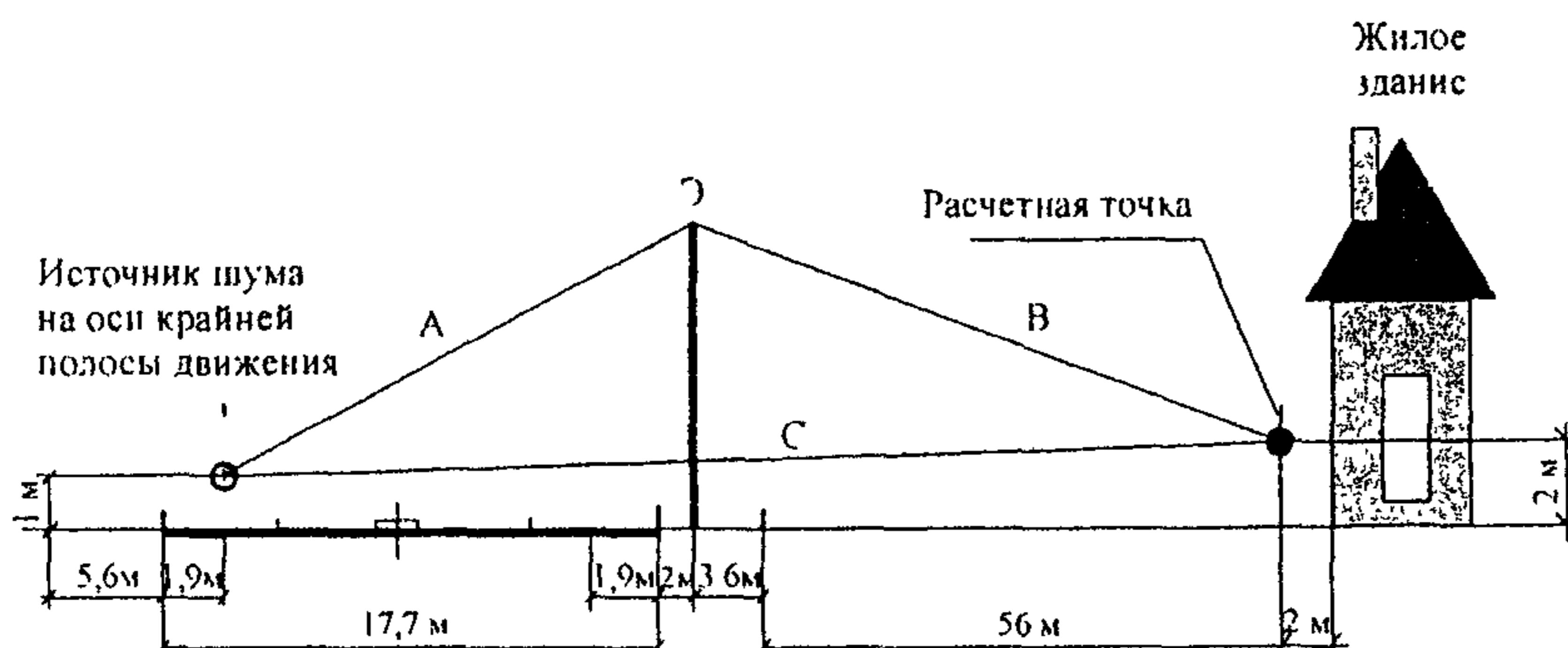
*Рис. 4. Расчетная схема оценки эффективности шумозащитного экрана*
