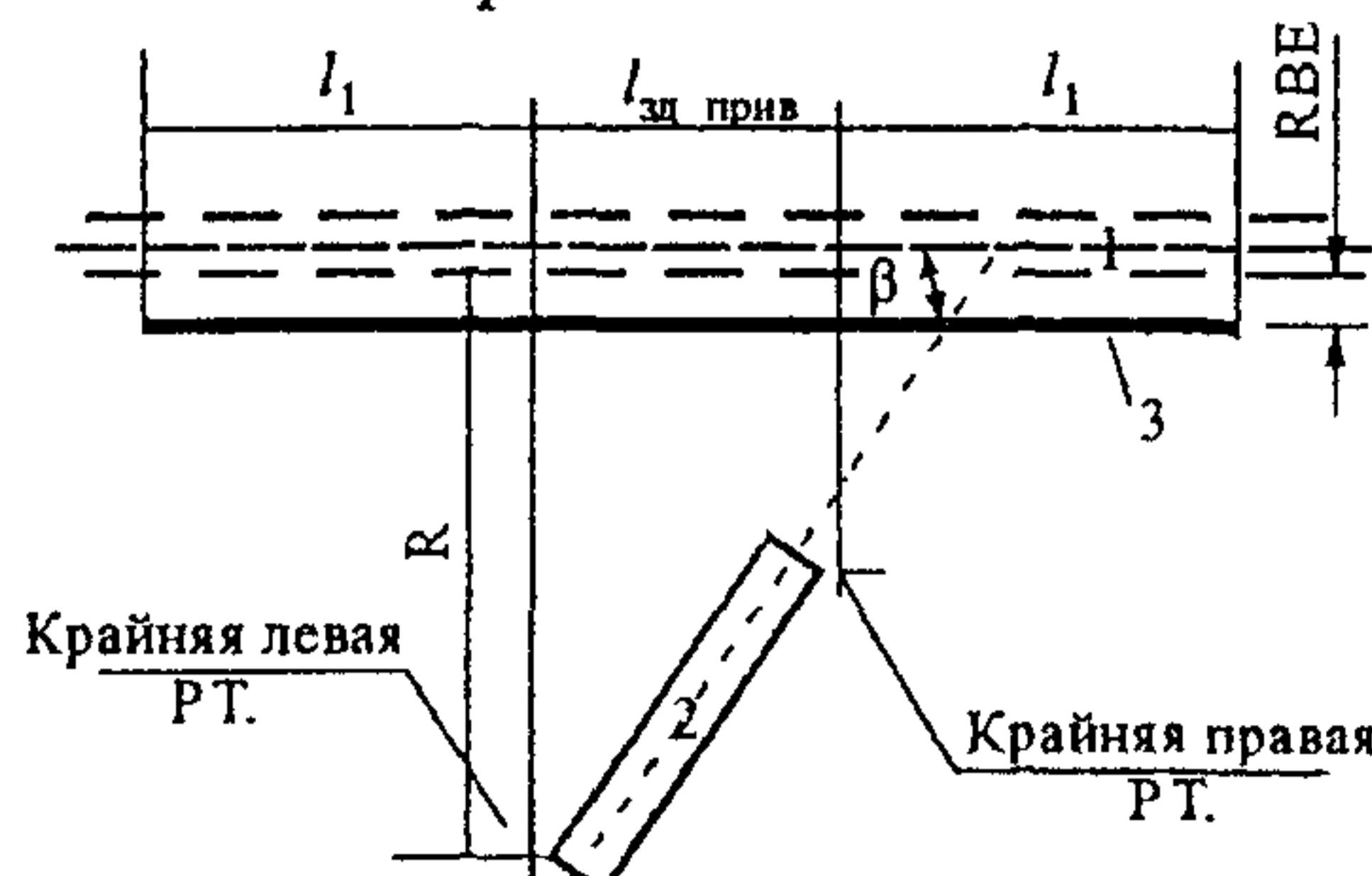
Рис. 4.4. Определение требуемой длины экрана:
