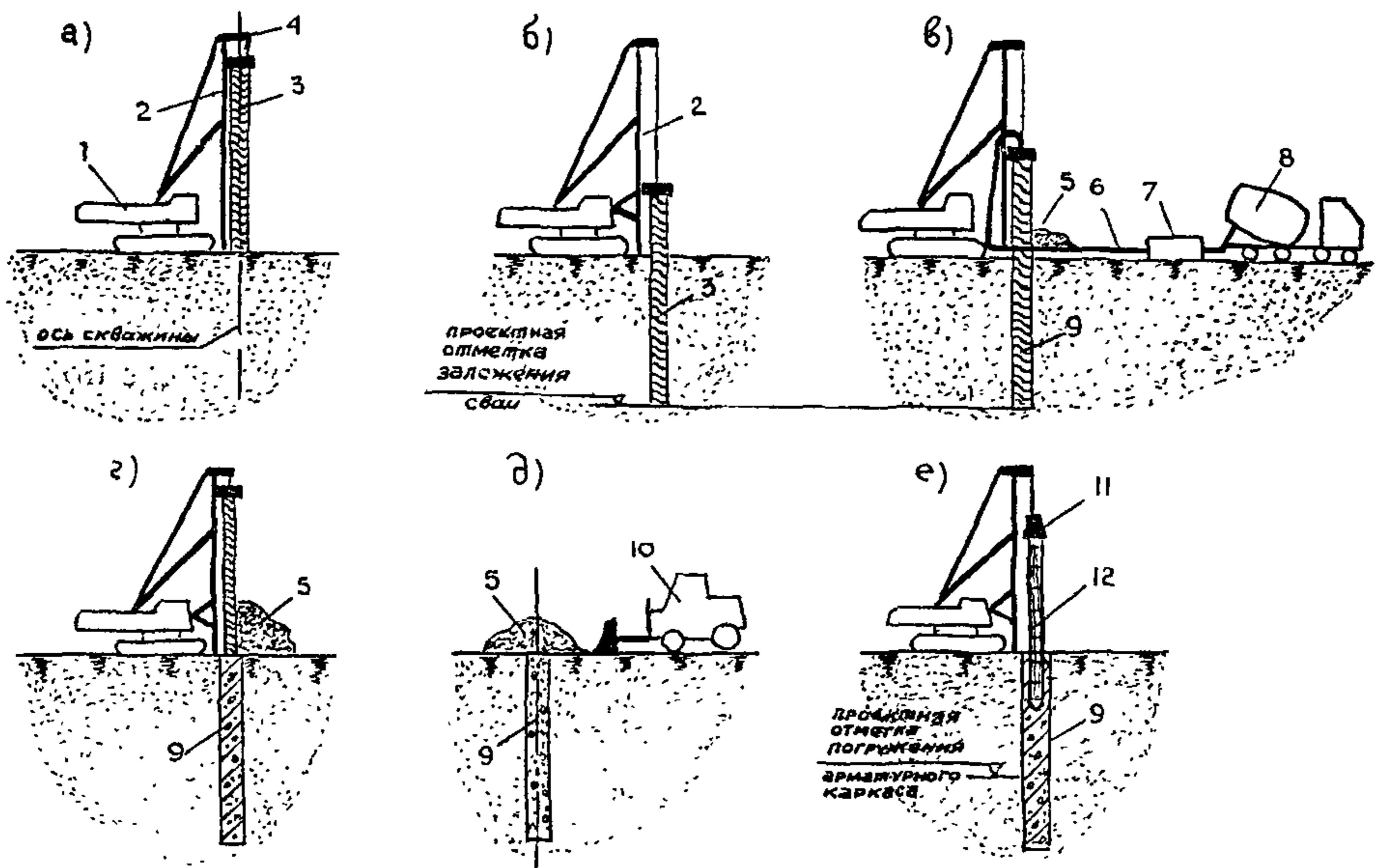
Рис. I. Технологический процесс по устройству буровабивных свай на базе импортного оборудования вблизи существующих зданий
